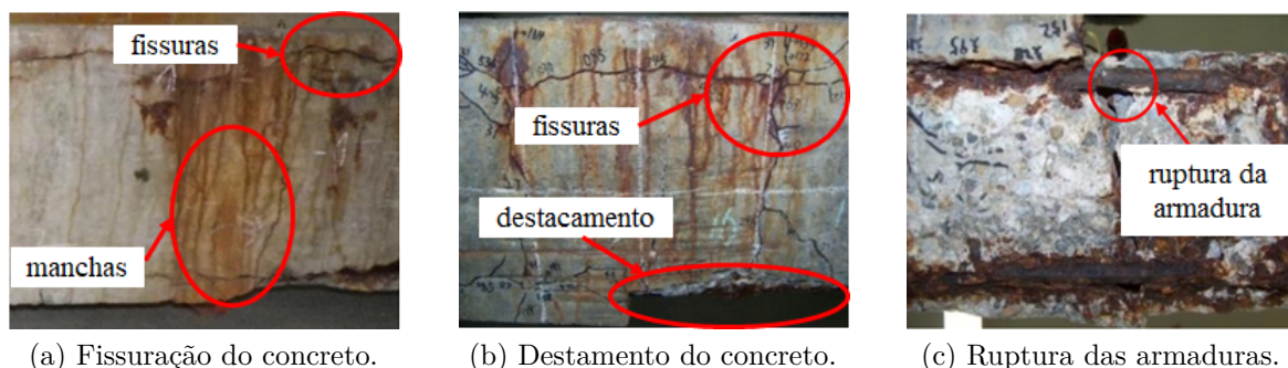
Figura 2.17 – Efeitos da corrosão em estruturas de concreto armado.
