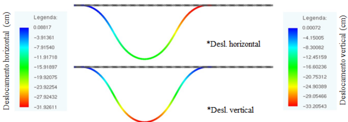
(c) Viga com F=24 kN.
