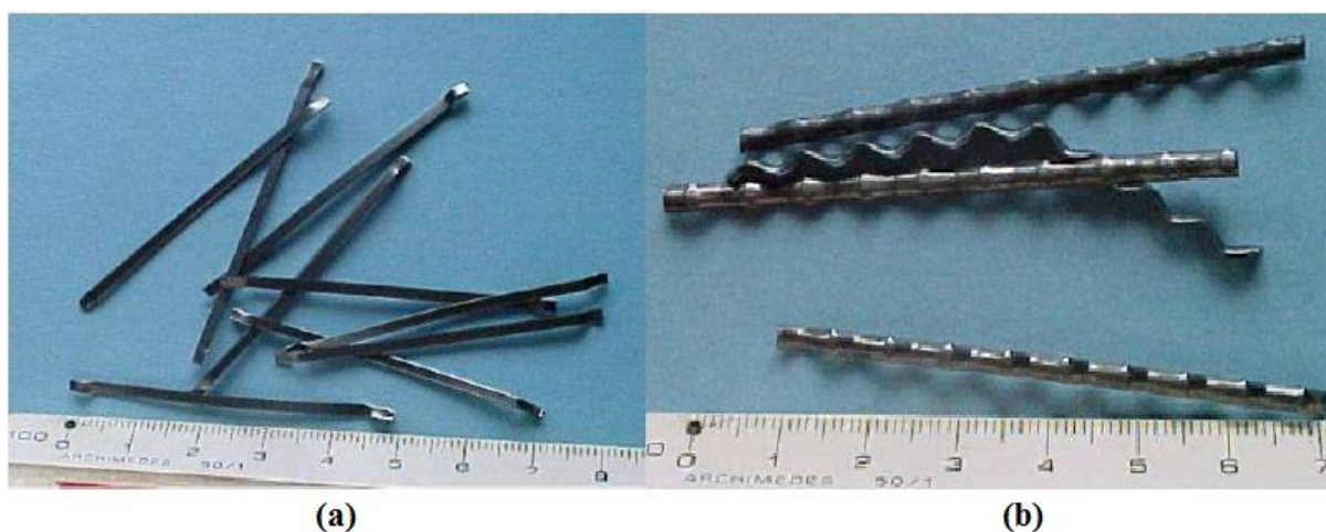
Figura 10 – Amostras de fibras de aço (a) com extremidades ancoradas e (b) corrugadas
