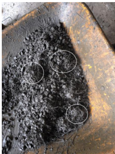
Figura 48 – Formação de aglomerados de fibras de polipropileno na concretagem do concreto CAR20PP
