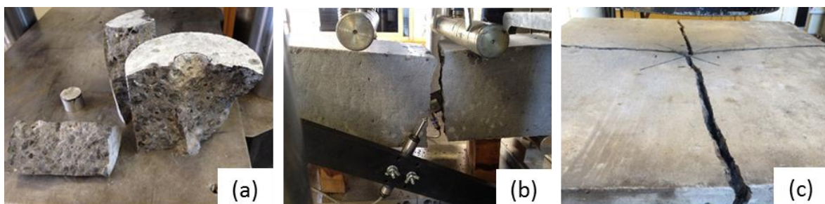
Figura 74 – Corpo de prova (a) cilíndrico, (b) prismático e (c) placa após a ruptura do concreto sem fibra
