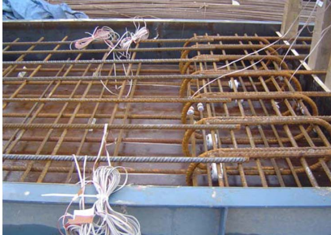
Figura 2.5 Emenda em laço ensaiada por Villalba et al. (2013)
