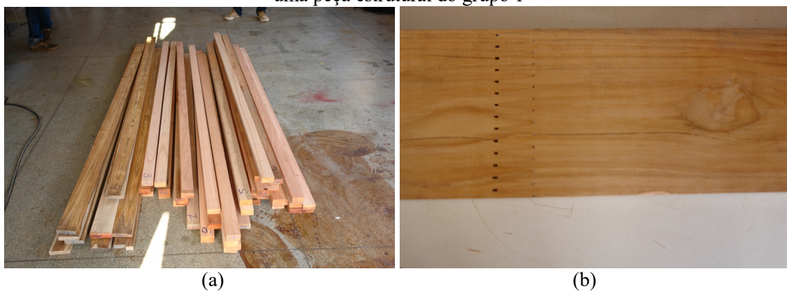
Figura 6.12 – (a) Vista geral das peças estruturais com emendas dentadas e (b) Emenda dentada em uma peça estrutural do grupo 1
