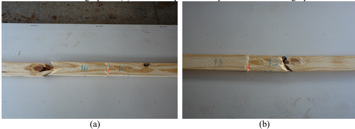
Figura 7.39 - Tração paralela às fibras das emendas dentadas: (a) modo de ruptura no nó para a amostra 6 do grupo 19 (b) modo de ruptura no nó para a amostra 3 do grupo 19
