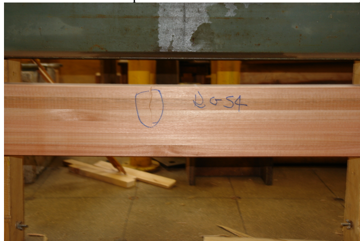
Figura 7.10 - Modo 7: compressão nas lamelas na extremidade superior
