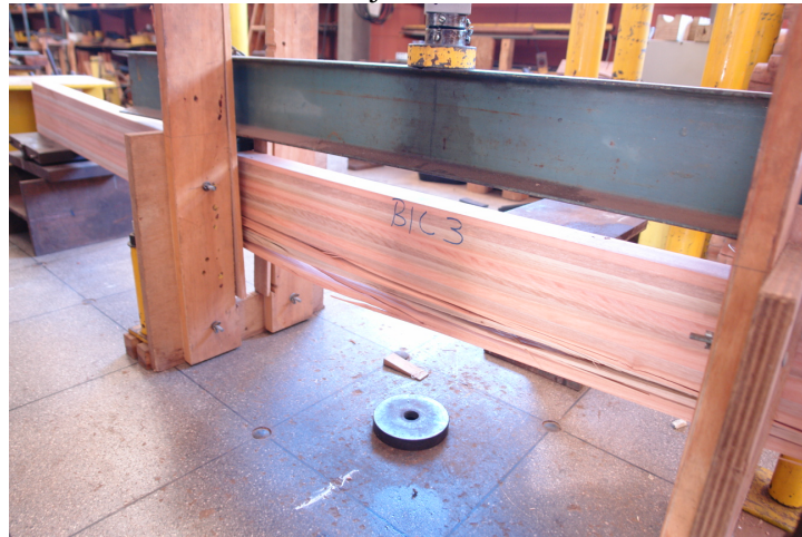
Figura 7.8 - Modo 5: tração na lamela da extremidade inferior seguida por cisalhamento nas lamelas adjacentes
