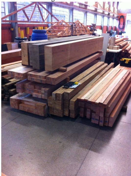
Figura 6.1 - Armazenamento das vigas de MLC de diferentes espécies de madeira
