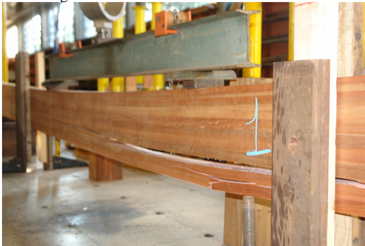
Figura 7.7 - Modo 4: cisalhamento no adesivo
