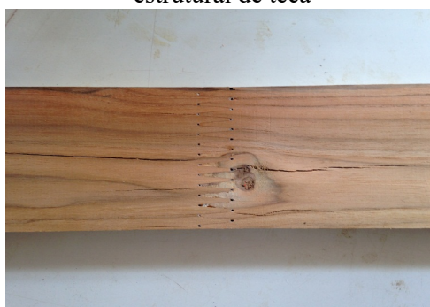
Figura 6.13 - Aberturas de fissuras e presença de nós nas regiões das emendas dentadas em uma peça estrutural de teca
