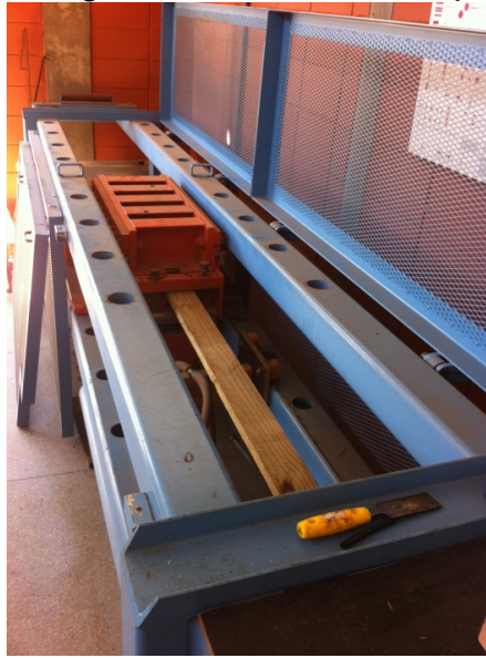
Figura 6.14 - Máquina Metriguard usada no ensaio de tração nas emendas dentadas
