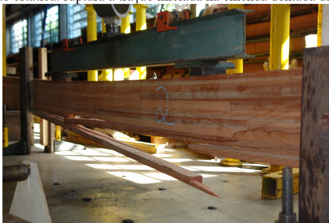
Figura 7.1 - Flexão estática: ruptura a tração iniciada na emenda dentada da viga 2 do grupo 9
