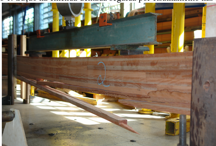
Figura 7.4 - Modo 1: tração na emenda dentada seguida por cisalhamento nas lamelas adjacentes
