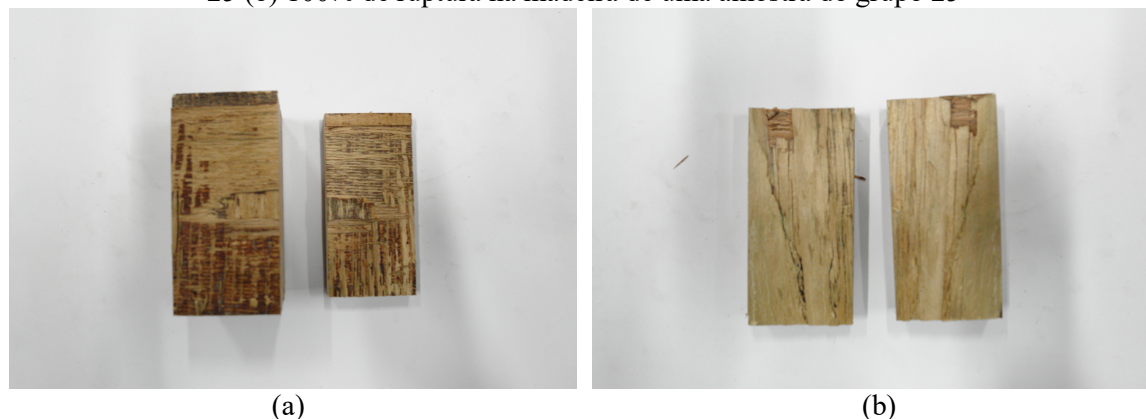
Figura 7.32 - Cisalhamento na linha de cola: (a) 50% de ruptura na madeira de uma amostra do grupo 25 (b) 100% de ruptura na madeira de uma amostra do grupo 25
