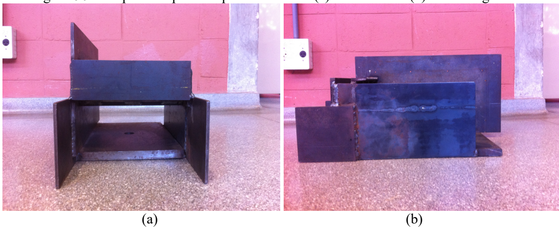
Figura 6.9 - Dispositivo para máquina universal: (a) Vista frontal (b) Vista longitudinal
