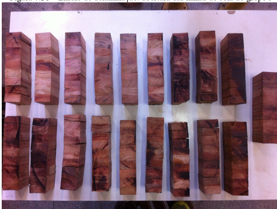
Figura 7.36 – Ensaio de delaminação: abertura das linhas de cola do grupo 9
