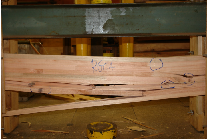
Figura 7.5 - Modo 2: tração na emenda dentada seguida por cisalhamento nas lamelas adjacentes e compressão provocada na parte superior da viga
