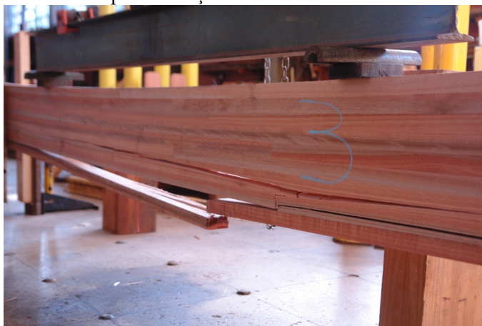
Figura 7.2 - Flexão estática: ruptura a tração iniciada na emenda dentada da viga 3 do grupo 9
