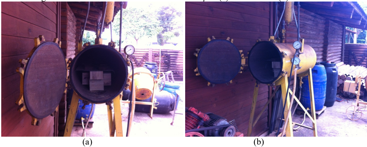
Figura 6.10 - Autoclave do ensaio de delaminação: (a) Vista frontal (b) Vista lateral
