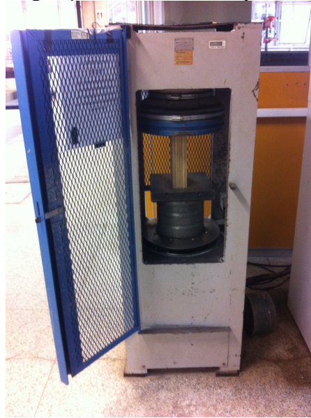
Figura 6.16 - Configuração do ensaio de compressão paralelo às fibras
