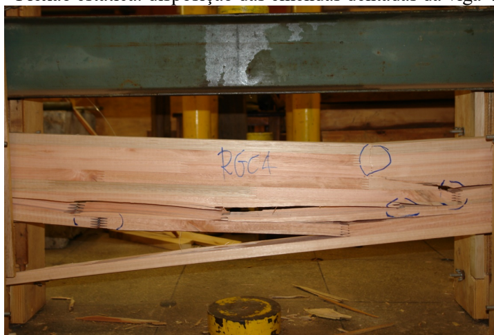
Figura 7.3 - Flexão estática: disposição das emendas dentadas da viga 4 do grupo 4
