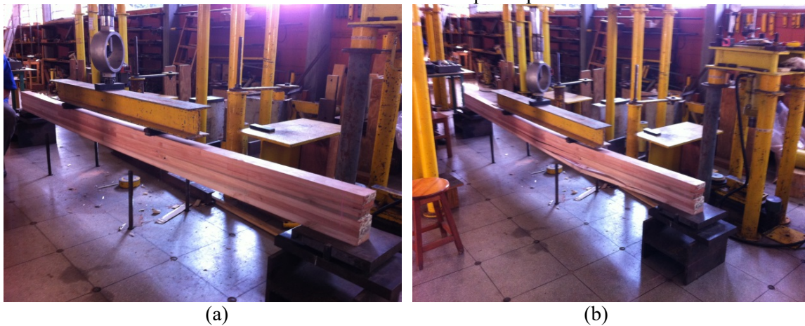
Figura 6.5 - (a) Uma viga do grupo 8 antes do início do ensaio e (b) Rompimento da viga do grupo no ensaio de flexão estática em quatro pontos
