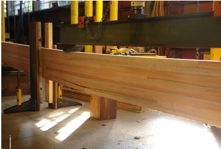
Figura 7.6 - Modo 3: cisalhamento na madeira
