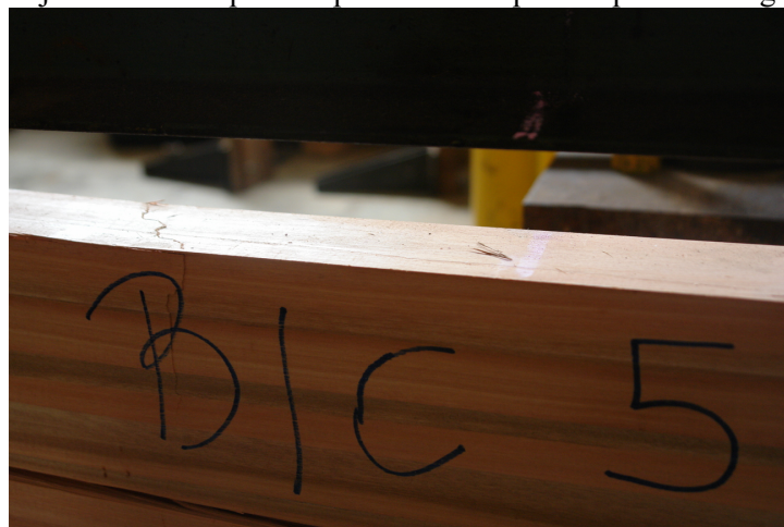
Figura 7.9 - Modo 6: tração na lamela da extremidade inferior seguida por cisalhamento nas lamelas adjacentes e compressão provocada na parte superior da viga
