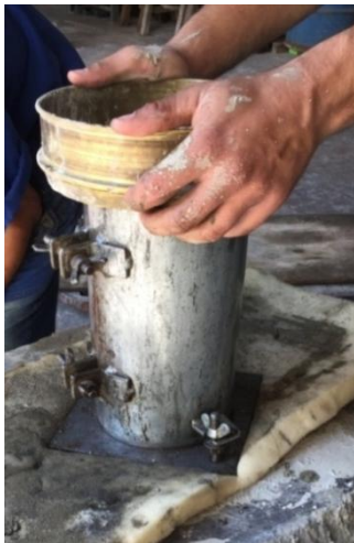
Figura 5.7 - Moldagem dos corpos de prova do ensaio de tempo de pega
