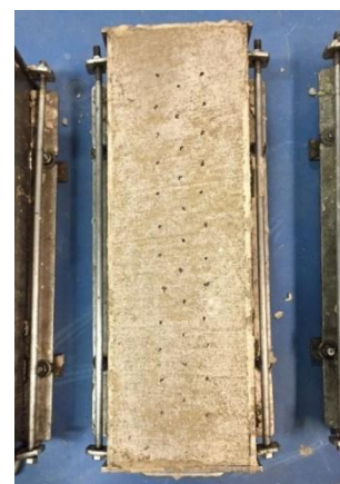
Figura 5.13 – Marcação do corpo de prova do ensaio de esclerometria
