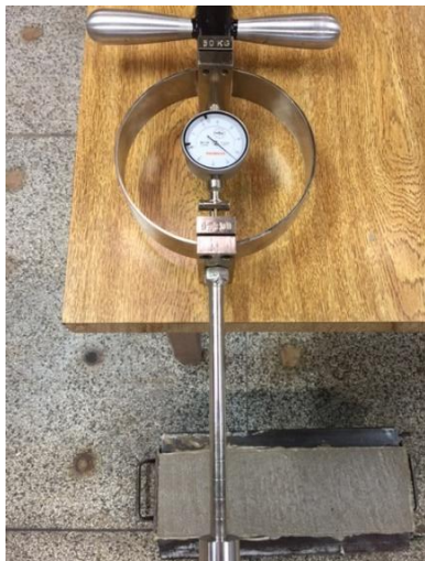
Figura 5.1 - Agulha de Meynadier utilizada no ensaio
