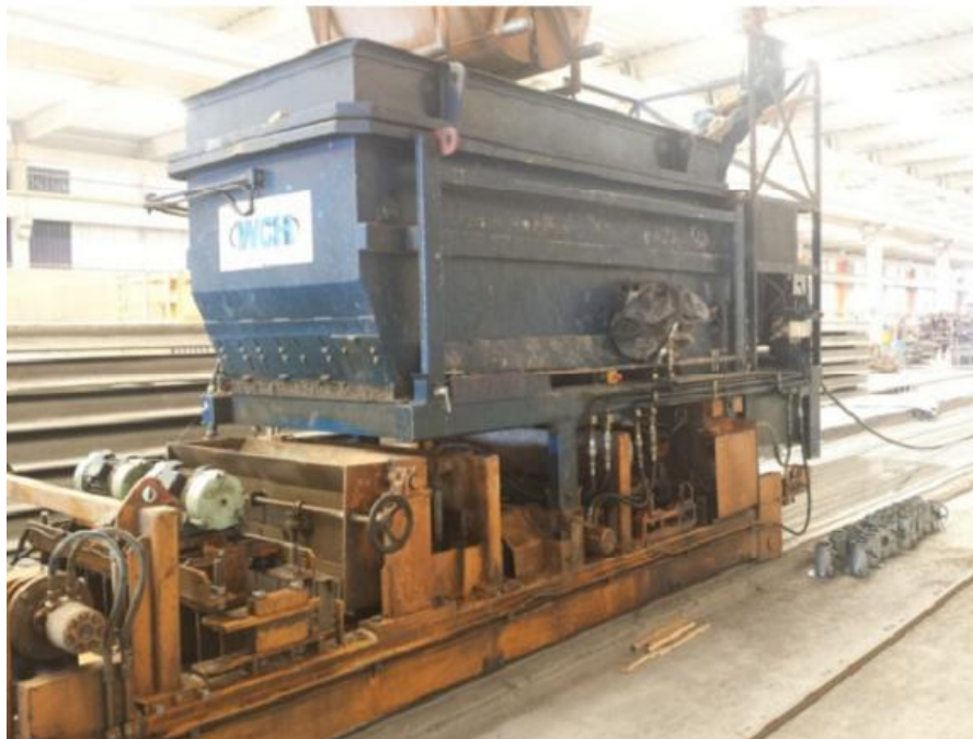
Figura 4.2 – Processo de fabricação das lajes alveolares por fôrma deslizante.
