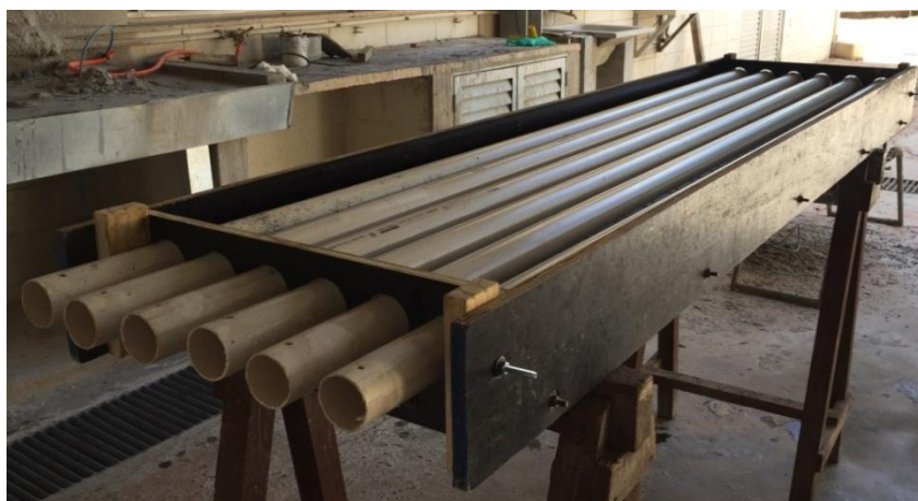
Figura 5.15 – Molde da laje alveolar
