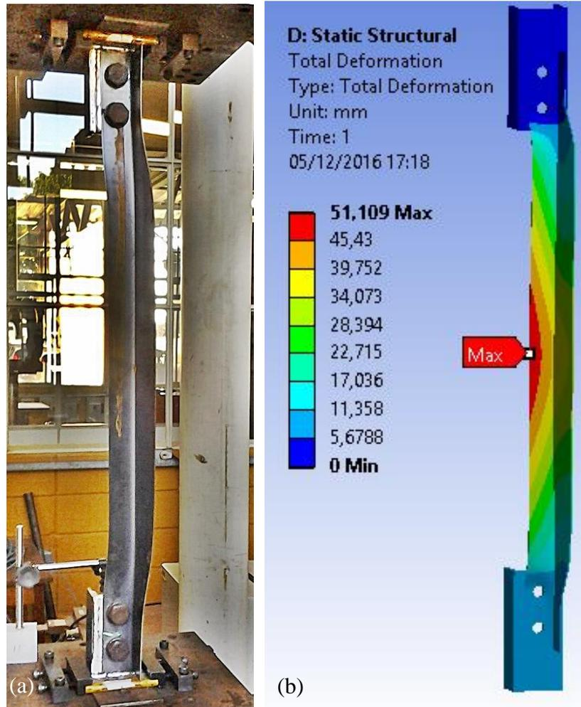
Figura 6.18 - Modo de instabilidade de flexo-torção da cantoneira L 50 x 2,25 mm de 1000 mm: (a) L50.10-1 de Branquinho (2014) e (b) resultado do modelo Bon&Fri.
