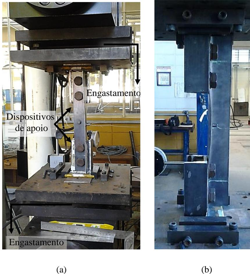
Figura 1.2 – Cantoneiras conectadas pela aba: (a) vista geral do ensaio de Branquinho (2014) e (b) detalhe para a ligação parafusada entre o dispositivo de apoio e a cantoneira. (BRANQUINHO, 2014)
