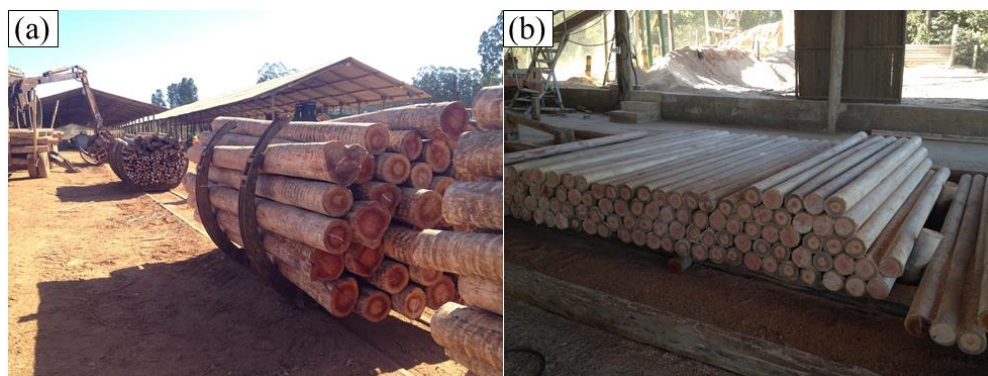
Figura 6 - (a) Peças antes de ser realizada a uniformização da seção e (b) peças após ter sido realizada a uniformização
