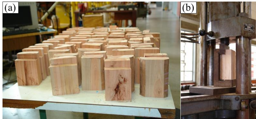
Figura 11 - (a) Corpos de prova para ensaio de cisalhamento paralelo às fibras e (b) aplicação do carregamento no aparato para ensaio de cisalhamento.
