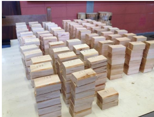
Figura 12 - corpos de prova para determinação da estabilidade dimensional da madeira
