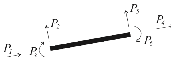
Figura 5.5 – Carregamentos nodais do elemento finito.
