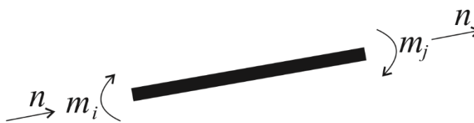
Figura 5.6 – Tensões generalizadas do elemento finito
