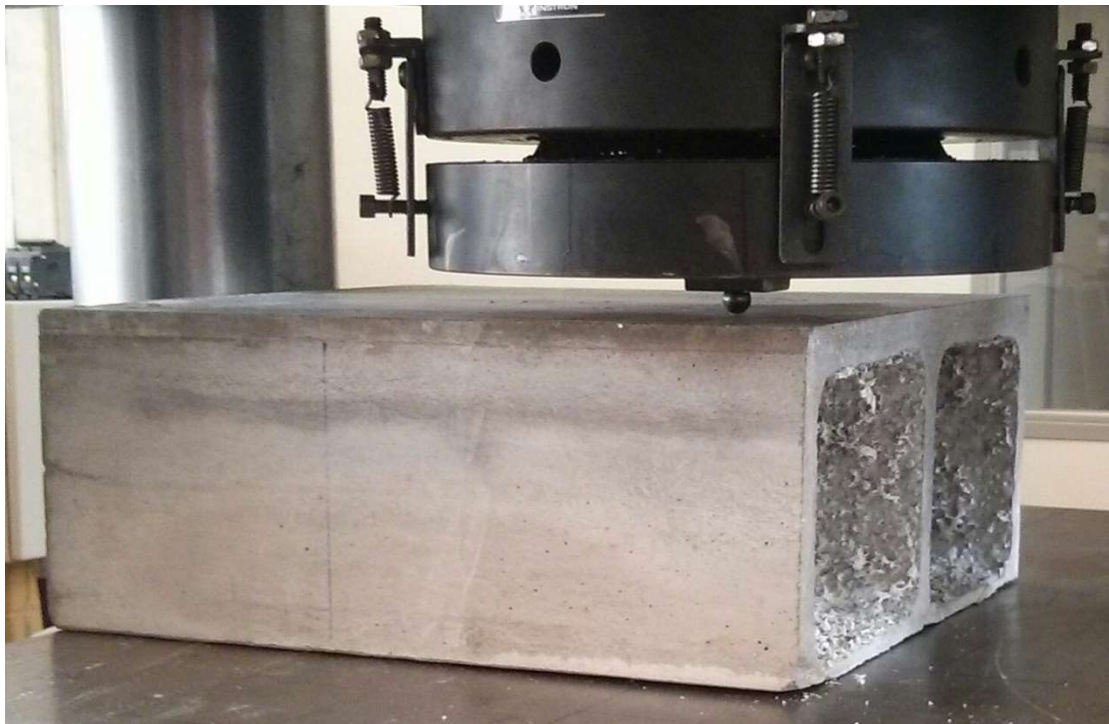
Figura 4.16 - Preparação do corpo de prova para o ensaio de carga concentrada (Fonte: Autor)
