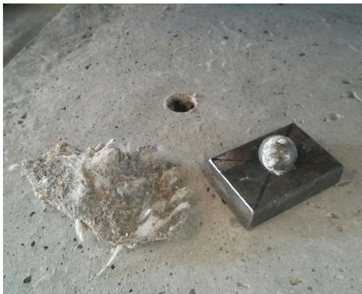
Figura 4.17 - Furo após a finalização do ensaio e cone extraído do corpo de prova da região do ensaio (Fonte: Autor)
