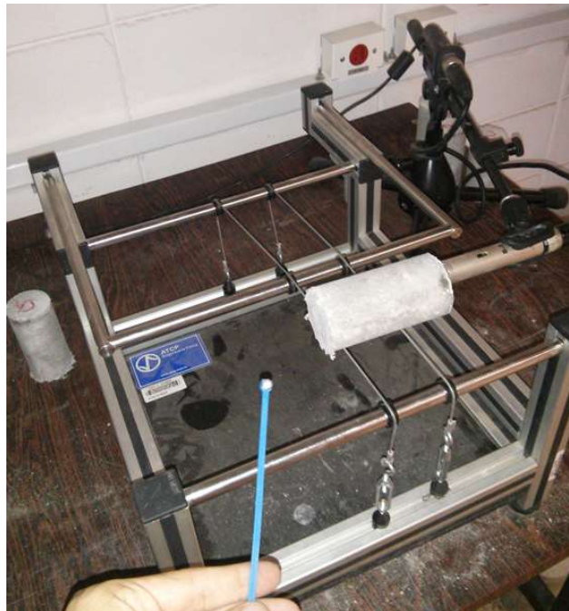
Figura 4.9 - Ensaio acústico em corpo de prova de argamassa reforçada com fibras de polipropileno (Fonte: Autor)
