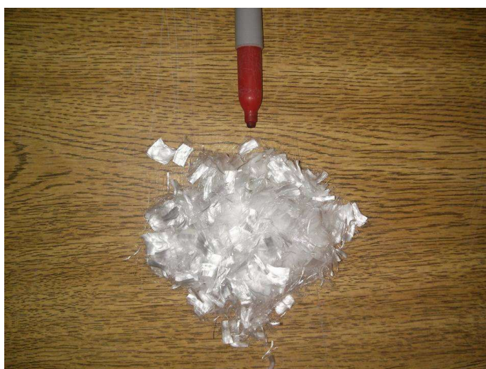
Figura 3.2 - Fibra de polipropileno utilizada na pesquisa (BRASILIT – Saint Gobain – Fonte: Autor)
