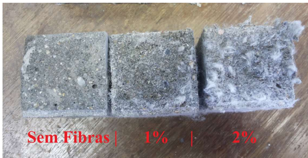
Figura 4.14 – Face do plano de ruptura dos corpos de prova para os diferentes teores de fibras utilizados na pesquisa (Fonte: Autor)
