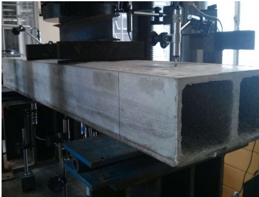
Figura 4.19 - Preparação do corpo de prova para o ensaio de flexão (Fonte: Autor)
