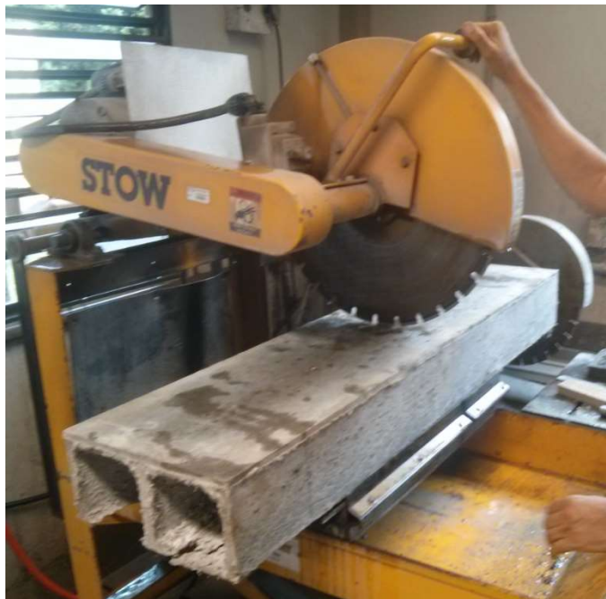
Figura 4.4 - Corte do corpo de prova do painel de 1200 mm para obtenção de dois modelos de 600 mm de comprimento (Fonte: Autor)
