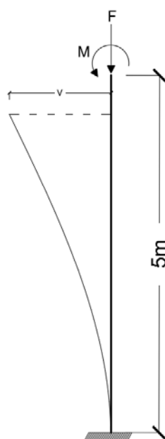
Figura 20 – Esquema para análise de flambagem de coluna.
