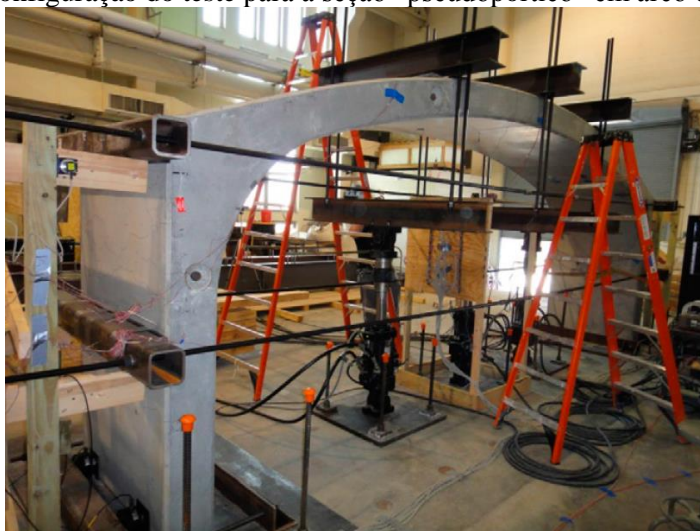
Figura 2.53 – Configuração do teste para a seção “pseudopórtico” em arco com vão de 6,1 m
