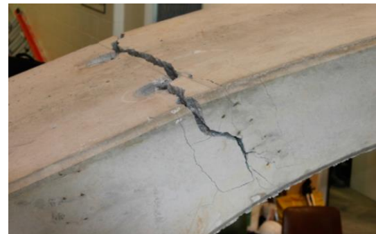
Figura 2.55 – Último estado de carregamento e localização de falha para a seção de arco de 11,0 m de vão
