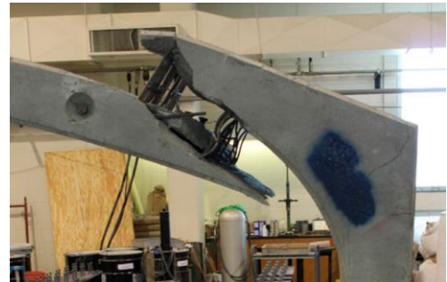
Figura 2.54 – Último estado de carregamento e localização de falha para a seção de arco de 6,1 m de vão
