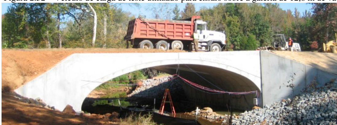
Figura 2.52 – Veículo de carga de teste utilizado para ensaio sobre a galeria de 12,8 m de vão
