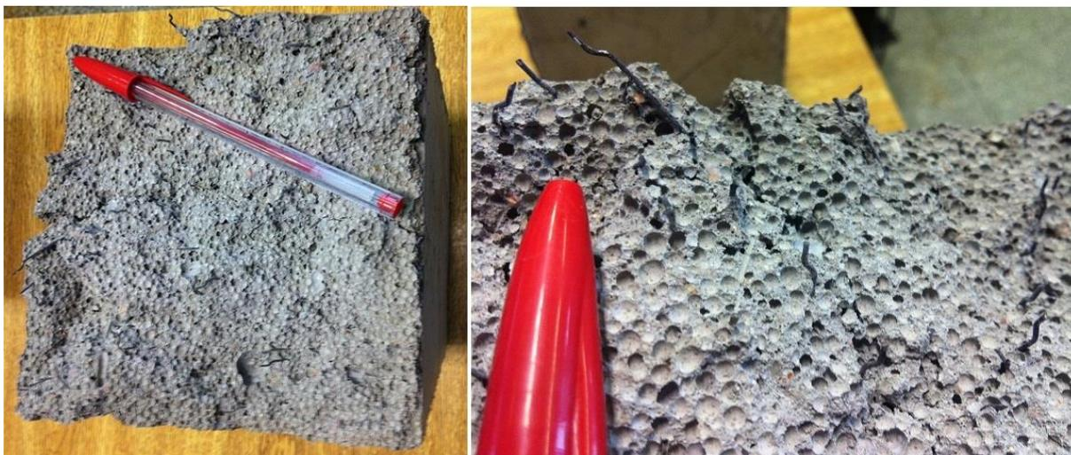
**Figura 6.38.** Corpo de prova prismático com 0,9% de fibras, após a ruptura no ensaio de resistência à tração na flexão (200 °C).
