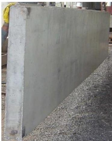
**Figura 2.8.** Painel de fechamento de concreto leve com EPS.
