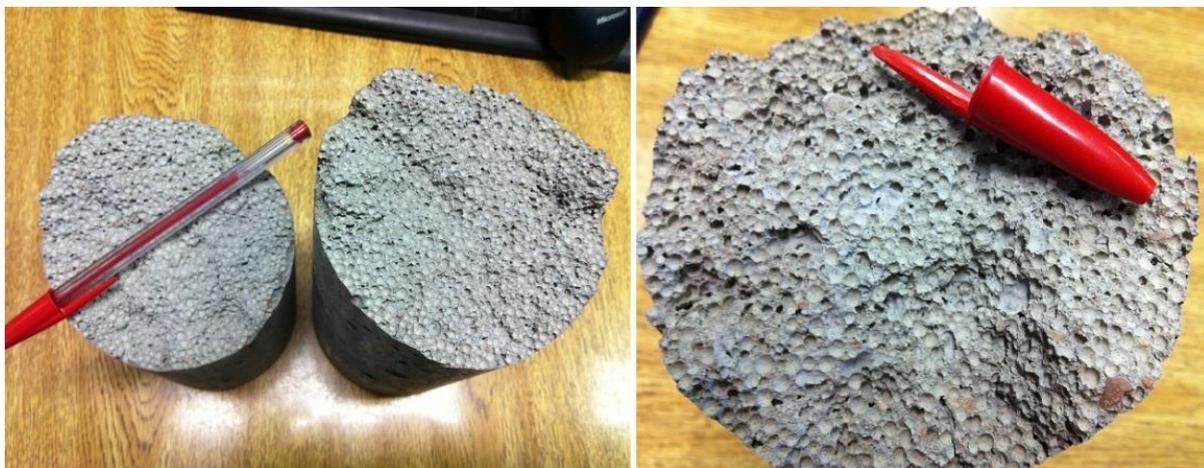
**Figura 6.9.** Corpo de prova cilíndrico após ruptura no ensaio de resistência à compressão (600 °C).
