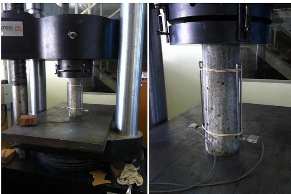
Figura 6.2. Corpo de prova cilíndrico, instrumentado, sendo ensaiado na máquina INSTRON.
