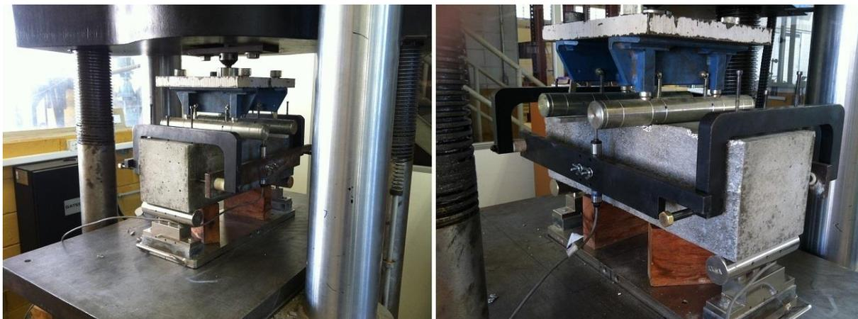
**Figura 6.21.** Corpo de prova prismático, instrumentado, sendo ensaiado na máquina INSTRON.
