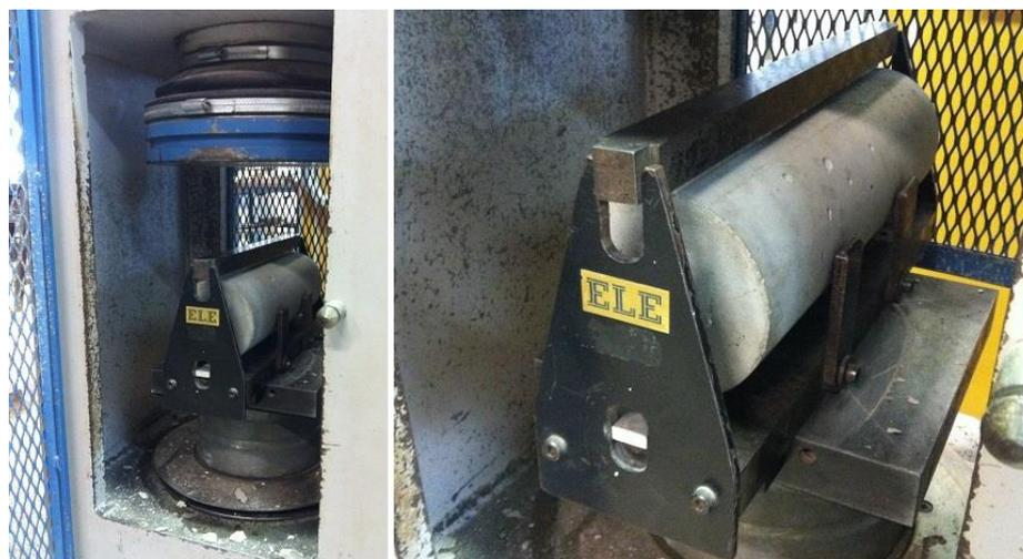
**Figura 6.18.** Ensaio de resistência à tração por compressão diametral.
