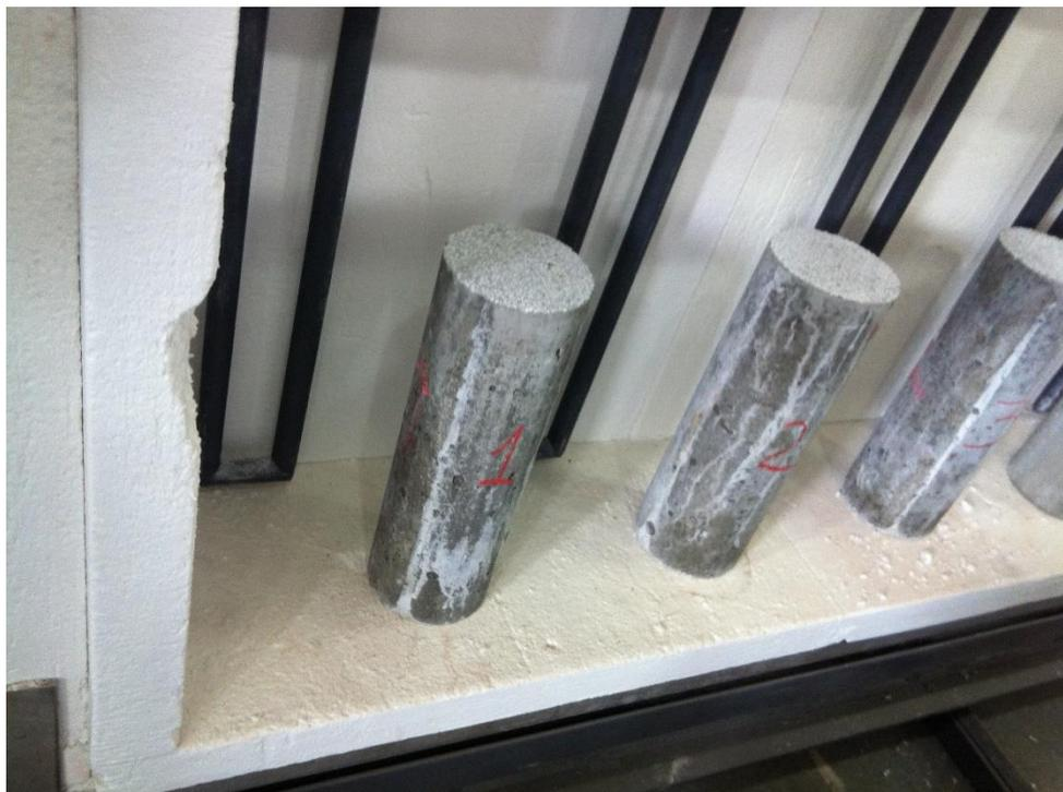
**Figura 5.8.** Distância entre os corpos de prova e resistências
