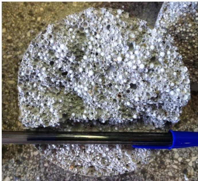
**Figura 6.5.** Corpo de prova cilíndrico após ruptura no ensaio de resistência à compressão (200 °C).
