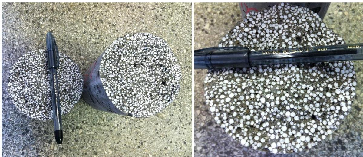
**Figura 6.3.** Corpo de prova cilíndrico após a ruptura no ensaio de resistência à compressão (temperatura ambiente).
