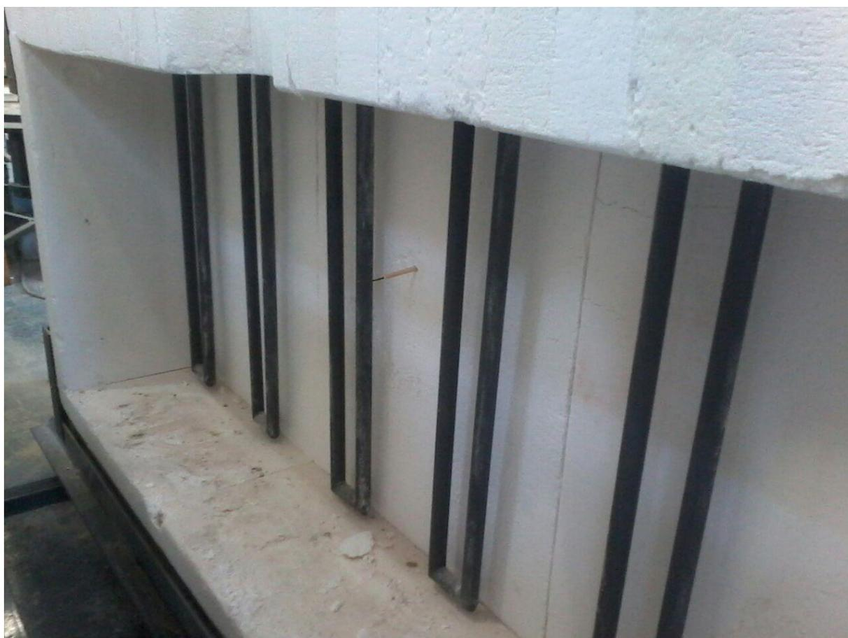
**Figura 5.7.** Resistências para o aquecimento do forno
