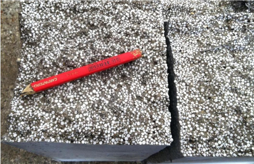
**Figura 6.27.** Corpo de prova prismático com 0,3% de fibras, após a ruptura no ensaio de resistência à tração na flexão (temperatura ambiente).
