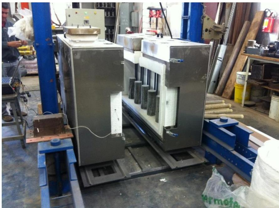
**Figura 5.4.** Forno aberto utilizado para o aquecimento dos corpos de prova.
