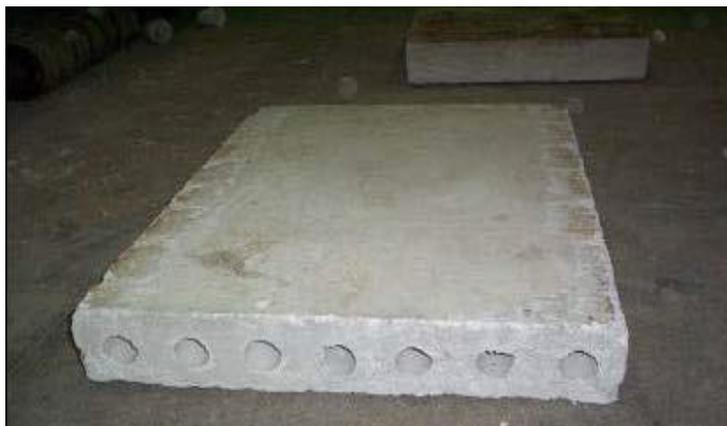
**Figura 2.6.** Painel de concreto leve com EPS.
