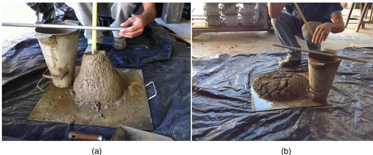
**Figura 5.29.** (a) Ensaio do tronco de cone e (b) caso em que se avaliou o espalhamento.
