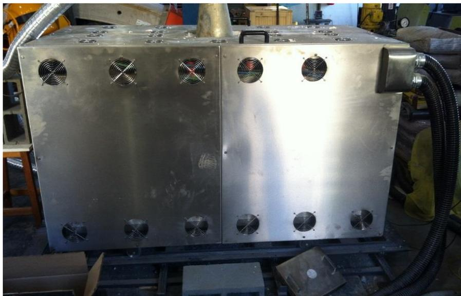
**Figura 5.3.** Lateral do forno utilizado para o aquecimento dos corpos de prova.
