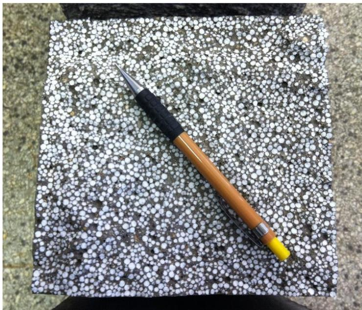
**Figura 6.22.** Corpo de prova prismático, sem fibras, após a ruptura no ensaio de resistência à tração na flexão (temperatura ambiente).
