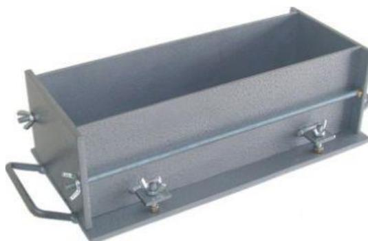
**Figura 5.27.** Formas dos corpos de prova prismáticos com 15 cm x 15 cm x 50 cm.
