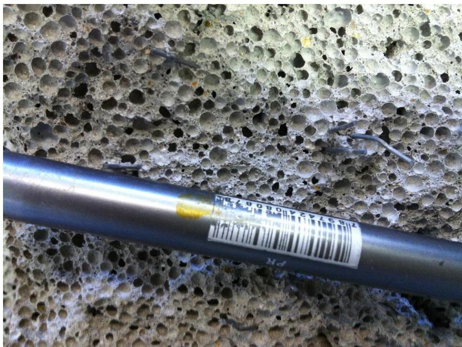
**Figura 6.29.** Corpo de prova prismático com 0,3% de fibras, após a ruptura no ensaio de resistência à tração na flexão (200 °C).
