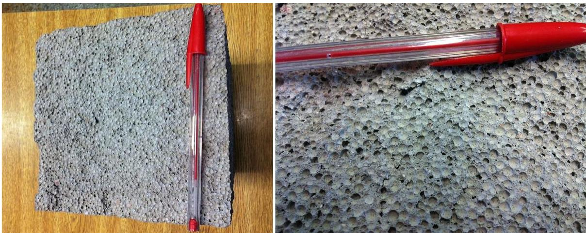
**Figura 6.24.** Corpo de prova prismático, sem fibras, após a ruptura no ensaio de resistência à tração na flexão (200 °C).
