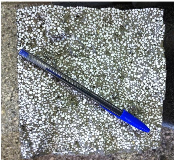
**Figura 6.32.** Corpo de prova prismático com 0,6% de fibras, após a ruptura no ensaio de resistência à tração na flexão (temperatura ambiente).
