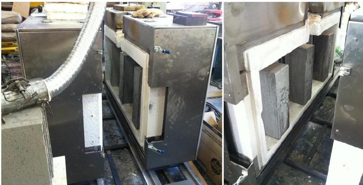
**Figura 5.12.** Disposição dos prismas dentro do forno.
