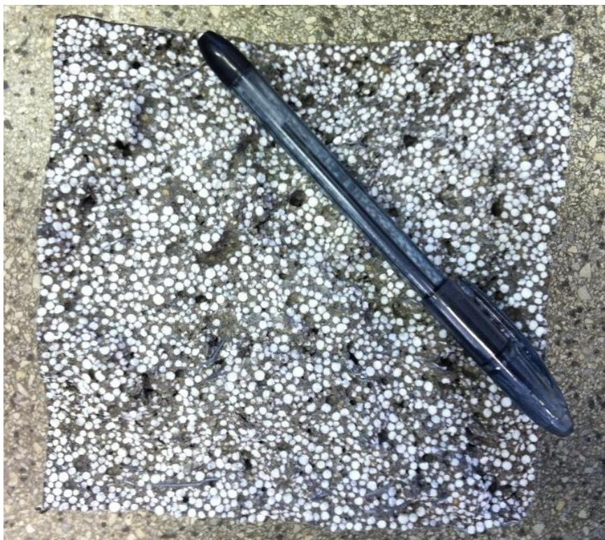
**Figura 6.36.** Corpo de prova prismático com 0,9% de fibras, após a ruptura no ensaio de resistência à tração na flexão (temperatura ambiente).
