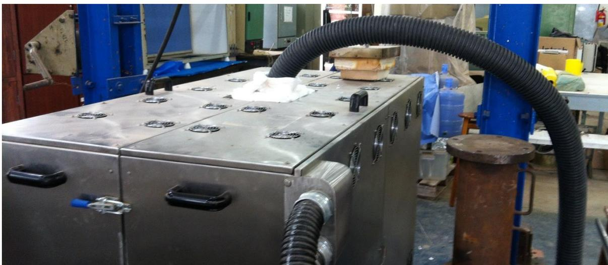
**Figura 5.14.** Tubo corrugado flexível colocado na parte superior do forno.
