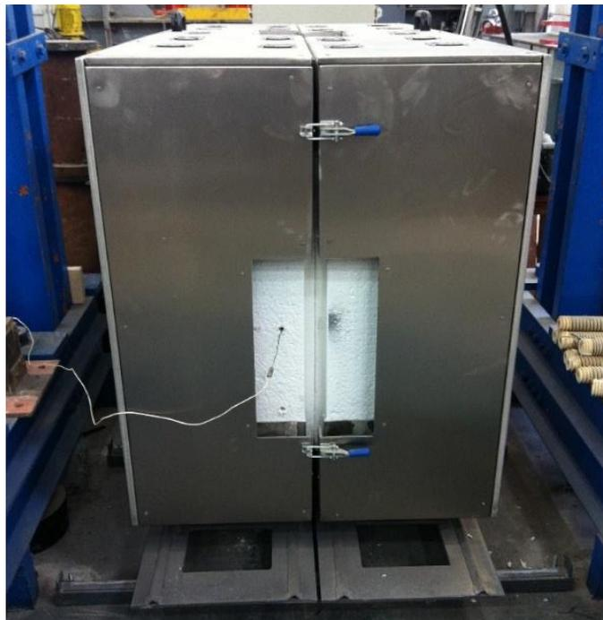
**Figura 5.2.** Forno fechado utilizado para o aquecimento dos corpos de prova.
