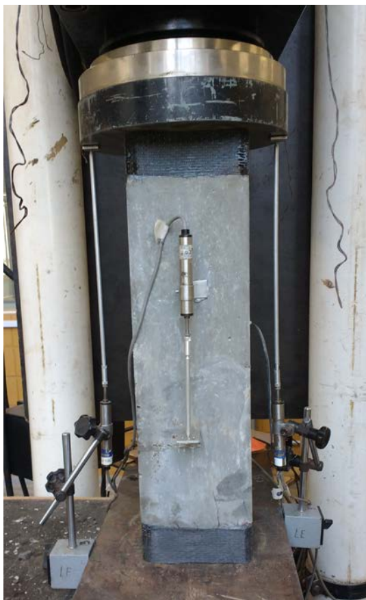
Figura 3.17 – Posição dos transdutores de deslocamento
