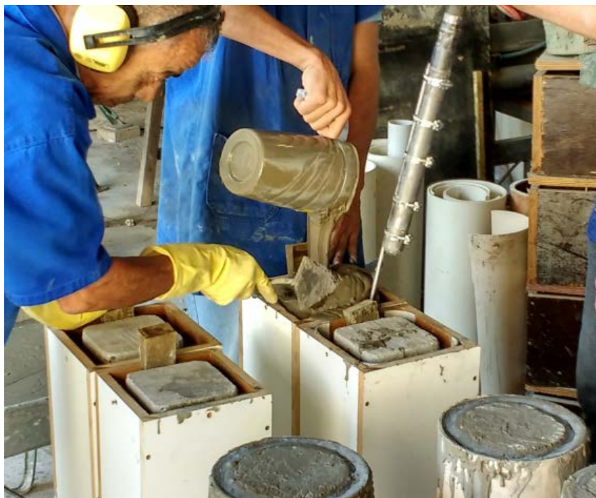
Figura 3.23 – Adensamento do concreto de ultra-alto desempenho
