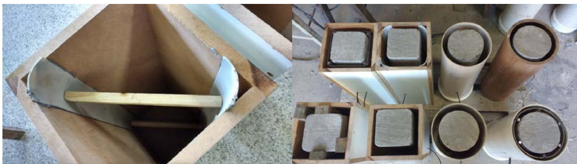
Figura 3.22 – Arredondamento dos cantos por meio de colagem de tiras de tubo de PVC
