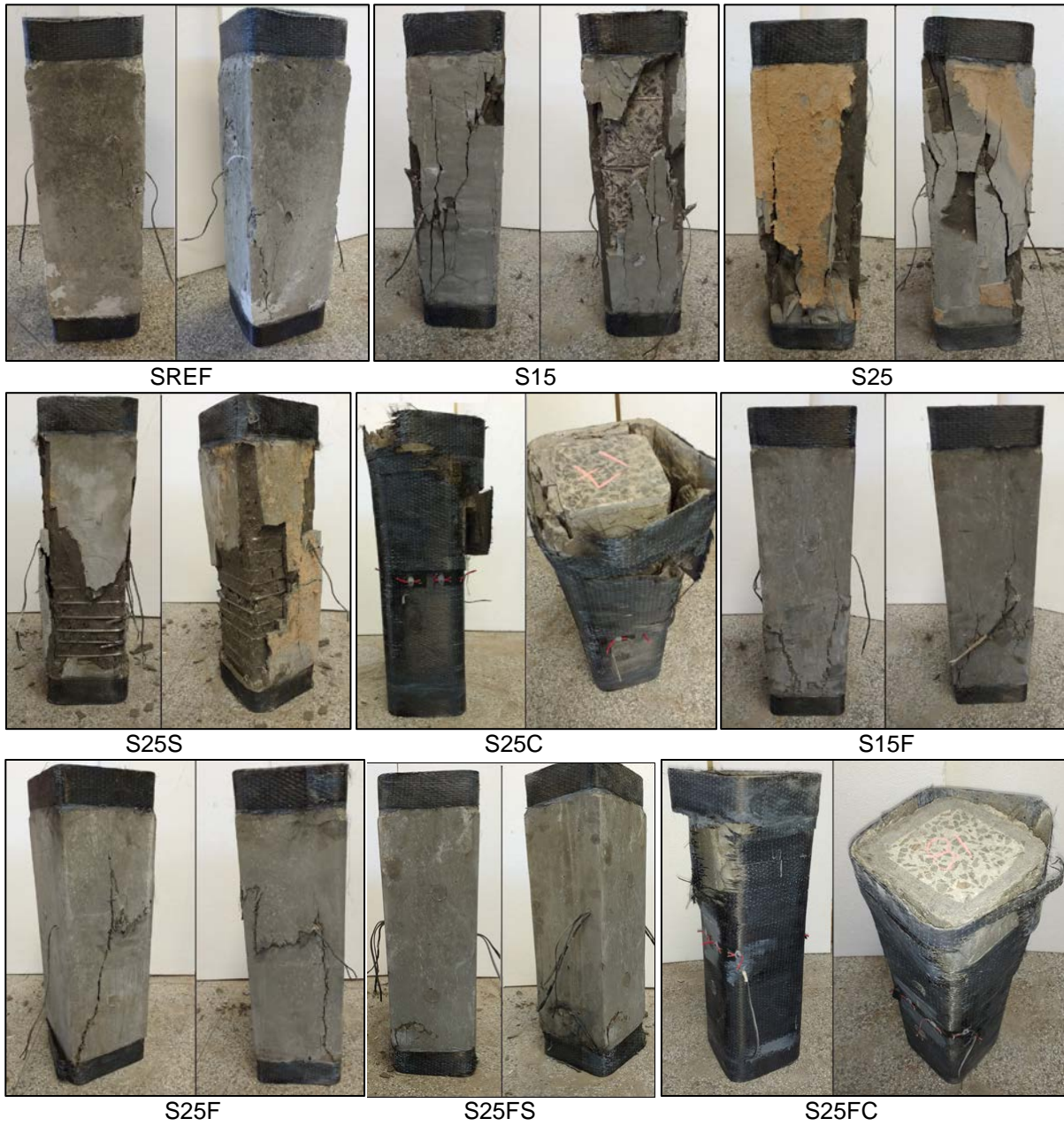
Figura 4.9 – As duas faces dos pilares de seção quadrada após a ruína
