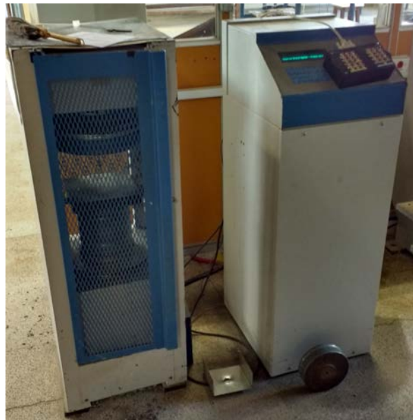
Figura 3.2 – Máquina hidráulica elétrica para ensaios à compressão, com capacidade para 2000 kN.
