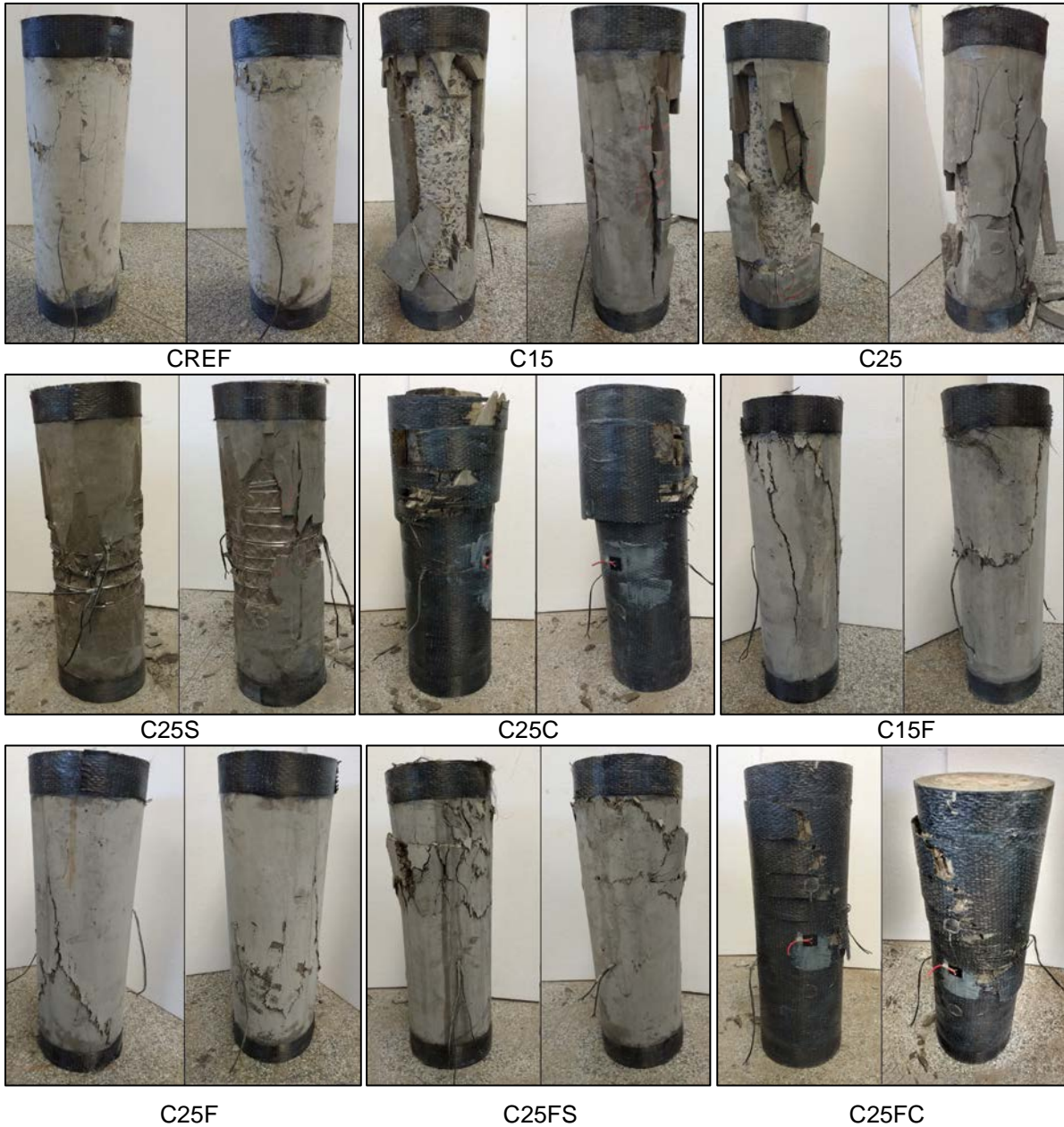
Figura 4.5 – As duas faces dos pilares de seção circular após a ruína
