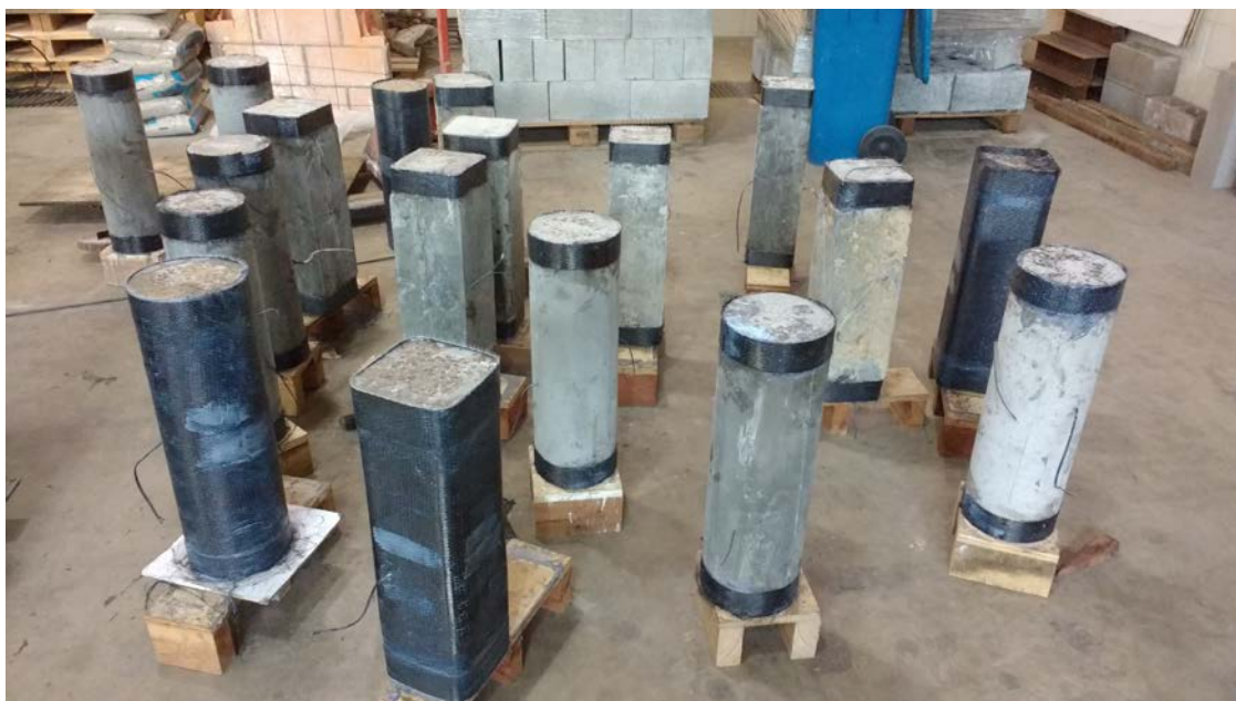
Figura 3.26 – Pilares preparados para o ensaio
