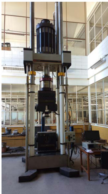
Figura 3.27 – Máquina universal de ensaio, servo-hidráulica - Instron, modelo 8506A, com capacidade de 3.000 kN.
