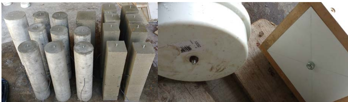
Figura 3.19 – Parafusos utilizados para centralizar os pilares originais
