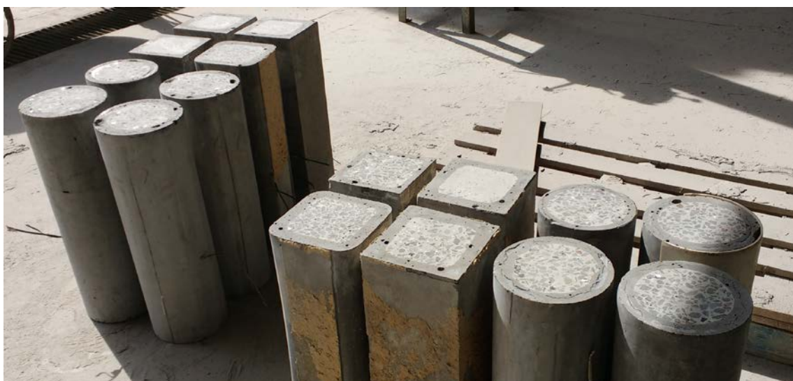
Figura 3.24 – Superfície dos pilares após a retifica da superfície com a esmerilhadeira
