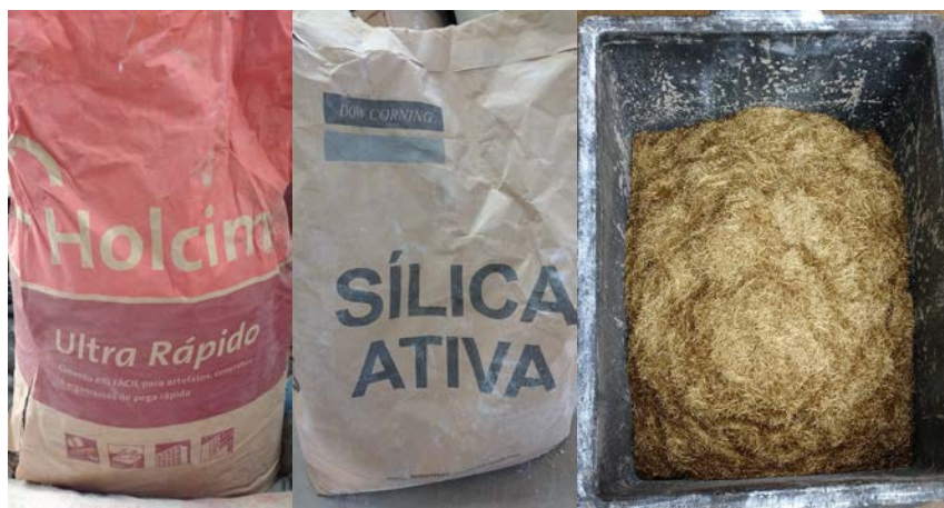
Figura 3.6 – Cimento, sílica ativa e fibra metálica utilizados na fabricação do UHPFRC
