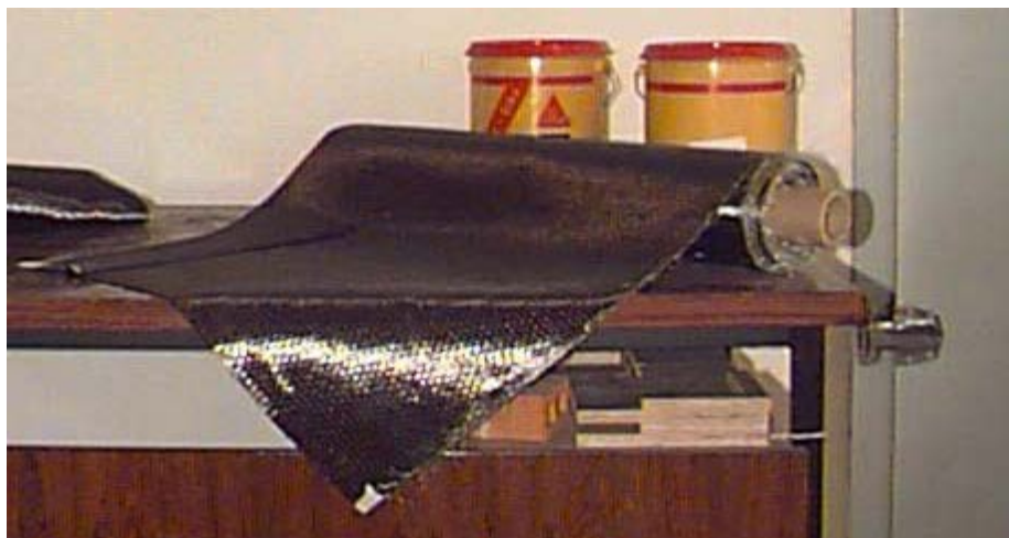
Figura 2.13 – Sistema de reforço estrutural SIKAWRAP® (tecido)
