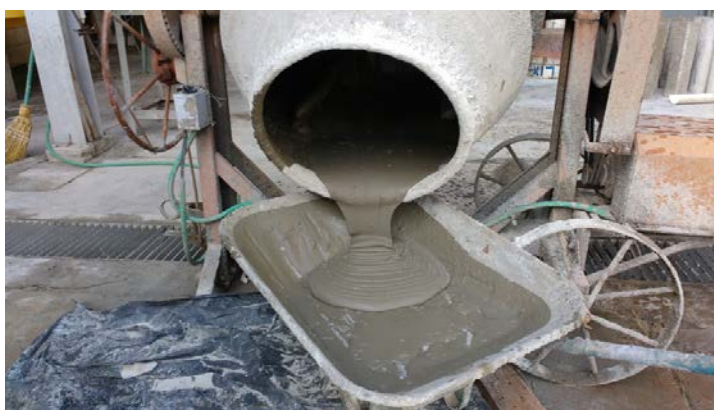
Figura 3.8 – Aspecto fluído do UHPC
