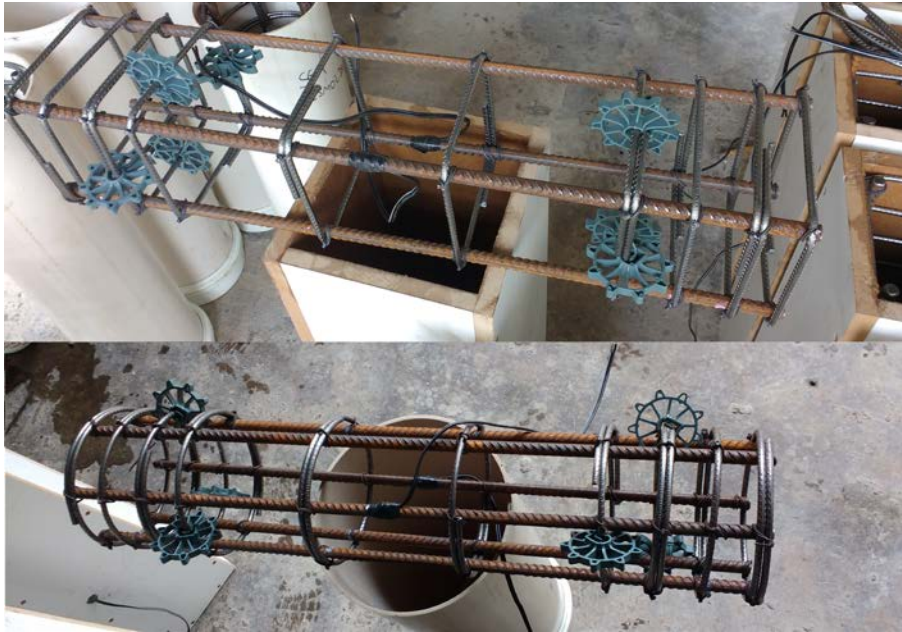
Figura 3.14 – Instrumentação das armaduras longitudinais dos pilares originais
