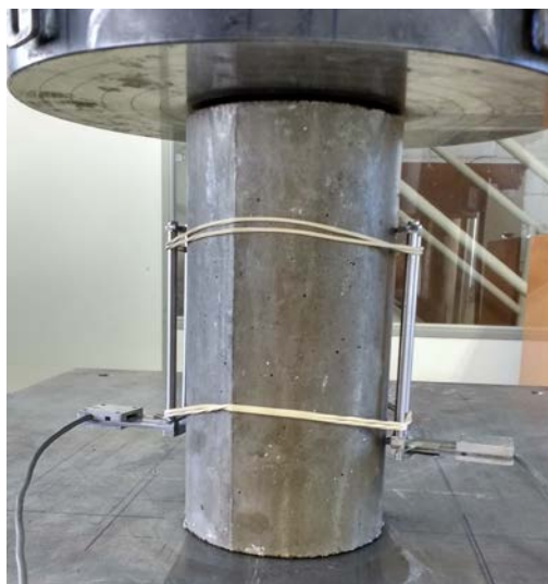
Figura 3.4 – Clip gages utilizados nos ensaios de caracterização.
