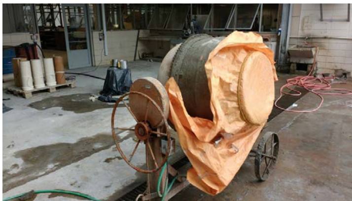
Figura 3.7 – Betoneira utilizada para confeccionar o concreto de ultra-alto desempenho
