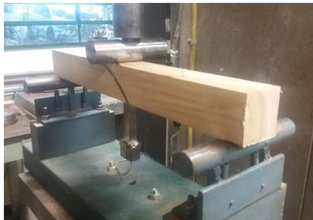
Figura 30 - Corpo de prova sobre dispositivo de apoio e com aplicação do Clip Gage.
