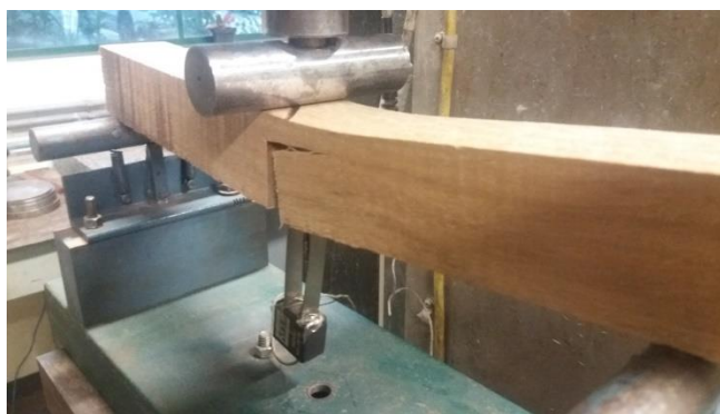
Figura 32 - Detalhe 01 de propagação de fissuras.
