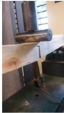
Figura 34 - Detalhe 03 de propagação de fissuras
