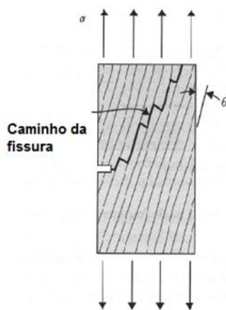
Figura 17 - Fissuras “saltam” entre as camadas de crescimento.
