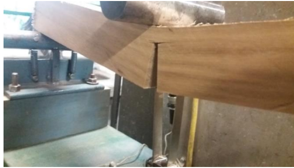
Figura 33 – Detalhe 02 de propagação de fissuras
