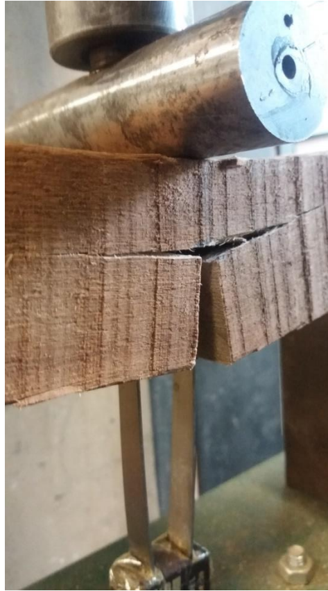
Figura 47 - Corpo de prova CP2 - Corymbia citriodora
