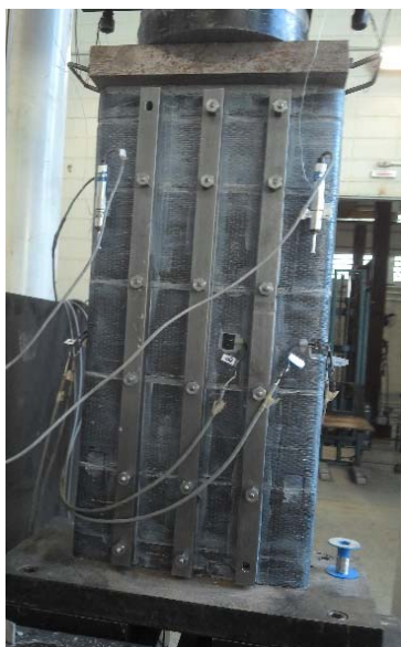
(c) Ruptura do tirante na extremidade superior do pilar
