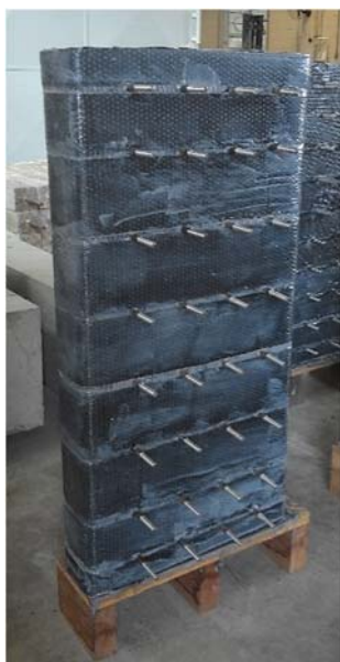
(a) Aspecto do pilar com tirante revestido com PRF
