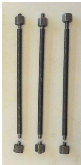
(a) Tirantes de \phi = 7 mm (ruptura na rosca)
