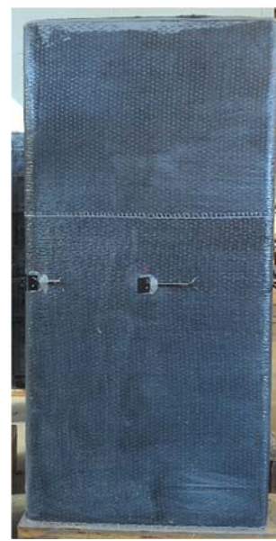
(c) Pilar sem tirante revestido com PRF
