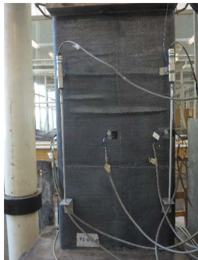
(c) Ruptura interna do concreto com expansão lateral do concreto do maior lado da seção
