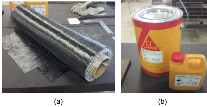
Figura 3.28 - (a) Tecido de fibra de carbono TEI-300; (b) Resina Epóxi Sikadur 330
