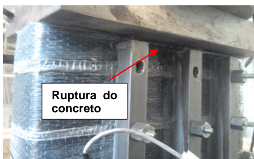
(c) Ruptura por compressão do concreto no lado mais comprimido (devido à excentricidade acidental) na região desprotegida pelos perfis de aço
