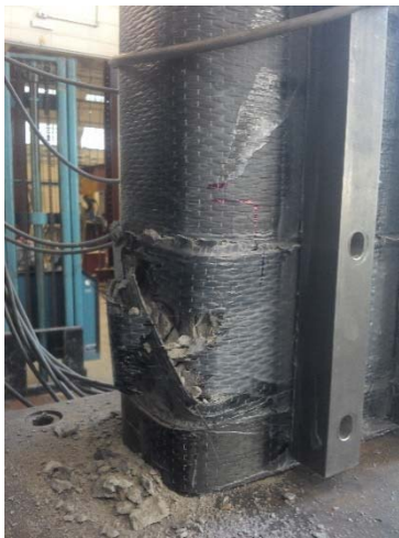
(c) Ruptura do PRF junto aos cantos arredondados
