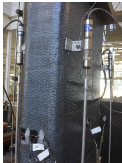
(d) Detalhe da expansão lateral do concreto no maior lado do pilar
