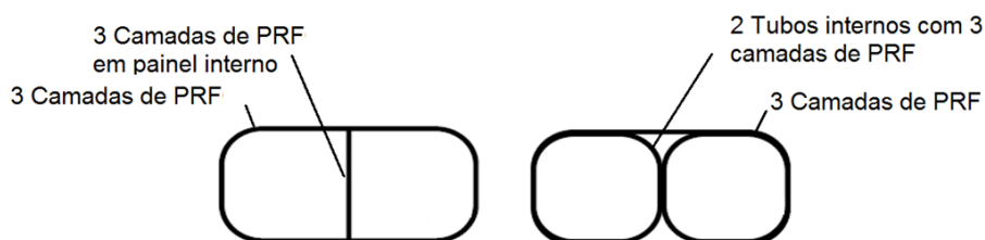
Figura 2.9 - Diferentes arranjos de Manta de PRF para pilares com seção transversal retangular [(OZBAKKALOGLU, 2013)]
