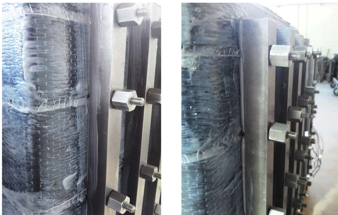
(a) Região plana: fina camada de resina (b) Região com imperfeições: espessa camada de resina
