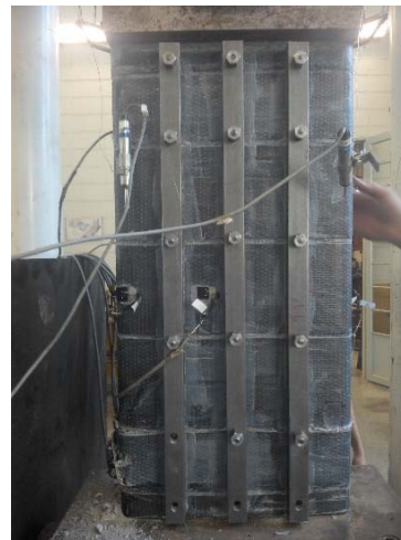
(d) Aspecto final do pilar após a ruína
