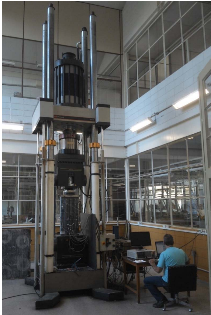
Figura 4.31 - Máquina de ensaios INSTRON com capacidade de 2500 kN
