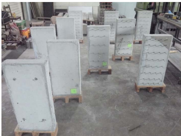
(a) Pilares desformados
