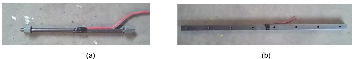
Figura 3.31 - (a) Tirante de aço instrumentado; (b) perfil de aço instrumentado.
