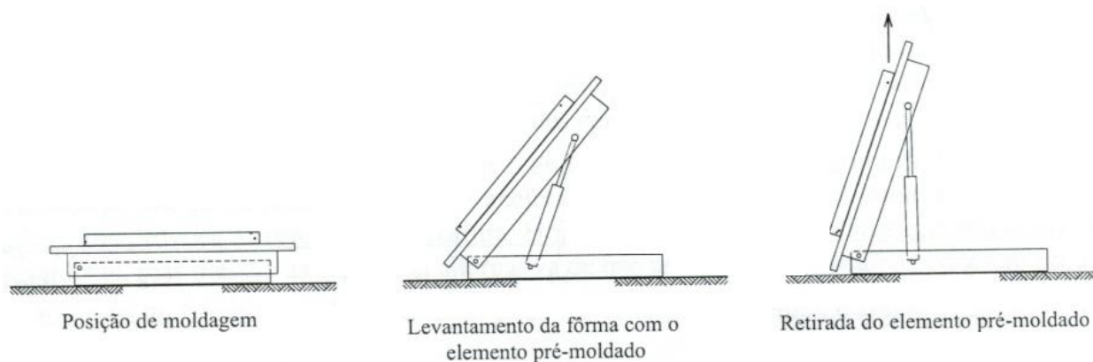
Figura 2.4 – Desmoldagem por tombamento. [Fonte: El Debs (2000)]
