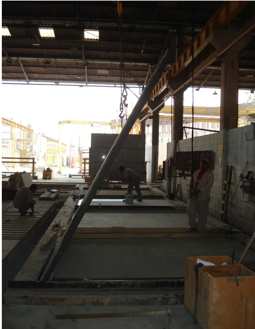
Figura 2.5 – Desmoldagem por rotação sobre uma extremidade. [Fonte: Tomo (2013)]
