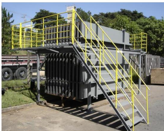
Figura 2.3 – Desmoldagem por separação dos elementos, com fôrma do tipo bateria. [Fonte: El Debs (2000) e Tomo (2013)]
