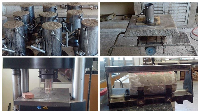
Figura 4.15 – Moldagem e ensaio dos corpos de prova cilíndricos de concreto.
