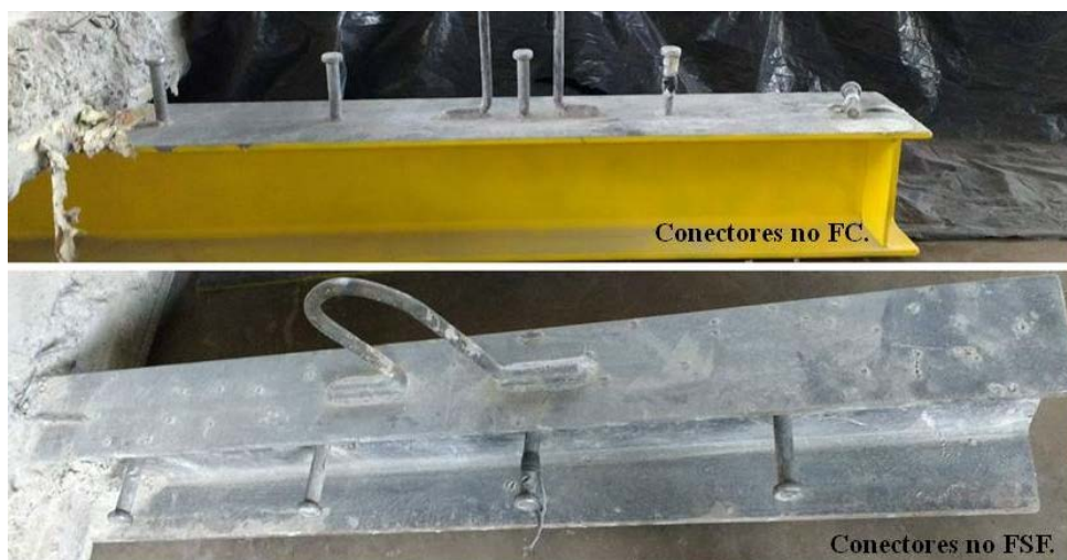
Figura 4.29 – Configuração final dos conectores nos modelos de piso misto submetido à flexão.
