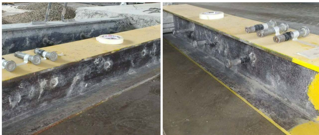
Figura 4.22 – Configuração final dos conectores no modelo de push-out .
