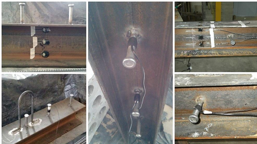
Figura 4.13 – Colagem dos extensômetros no perfil metálico e nos conectores. a) Piso misto convencional b) Modelo de push-out c) Piso misto de pequena altura.
