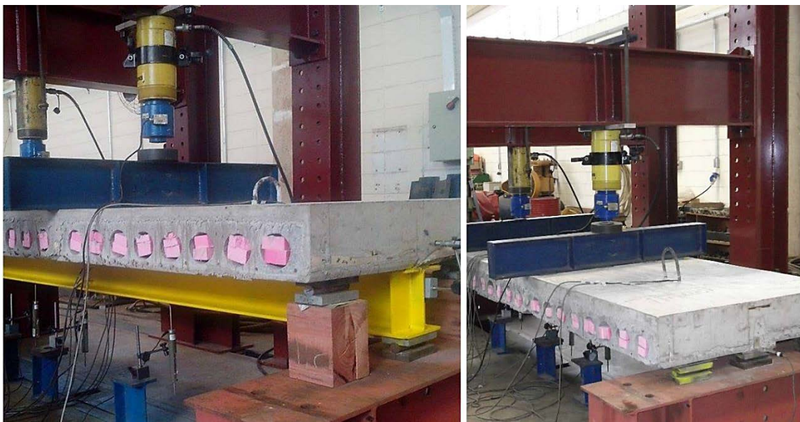
Figura 4.20 – Esquema de ensaio do piso misto submetido à flexão em quatro pontos.
