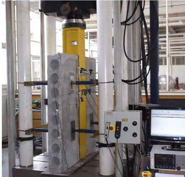
Figura 4.17 – Esquema de ensaio do modelo de cisalhamento direto.
