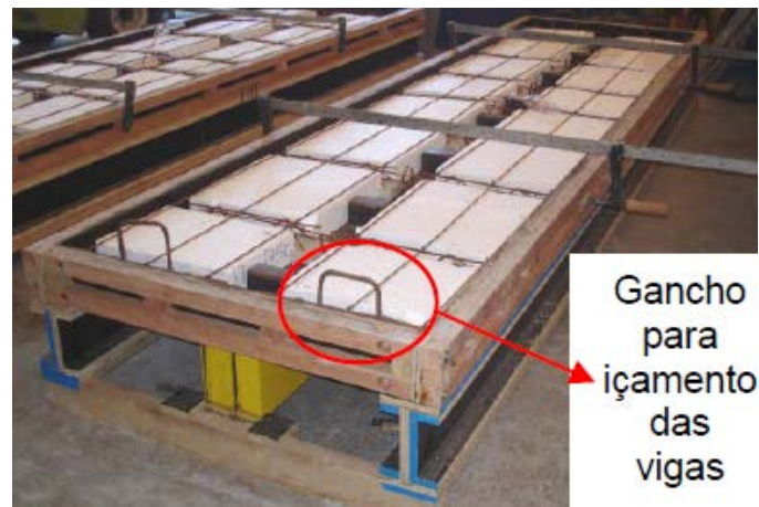
Figura 2.17 – Viga mista constituída por perfil formado a frio e laje de vigotas pré-moldadas. (Fonte: DAVID, 2007).
