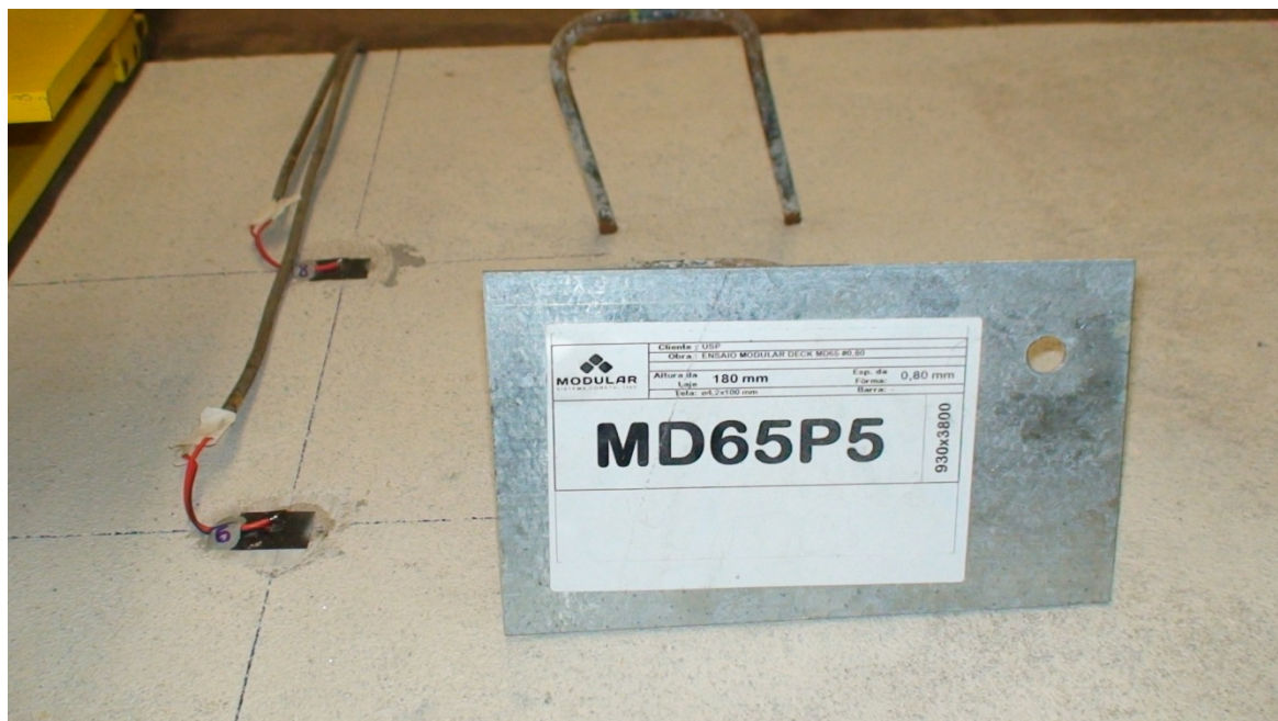
Figura A.9 – Extensômetros elétricos na face superior da laje.
