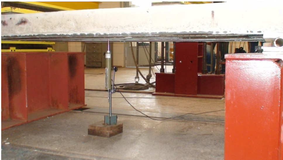
Figura 4.6 – Transdutor de deslocamento para medição do deslocamento vertical a meio vão (flecha).
