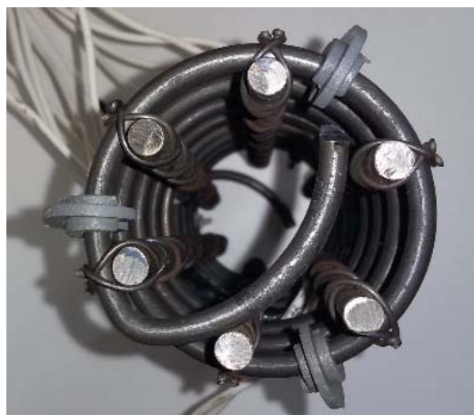
Figura 4.20 – Detalhe em forma de gancho utilizado para ancorar a armadura transversal
