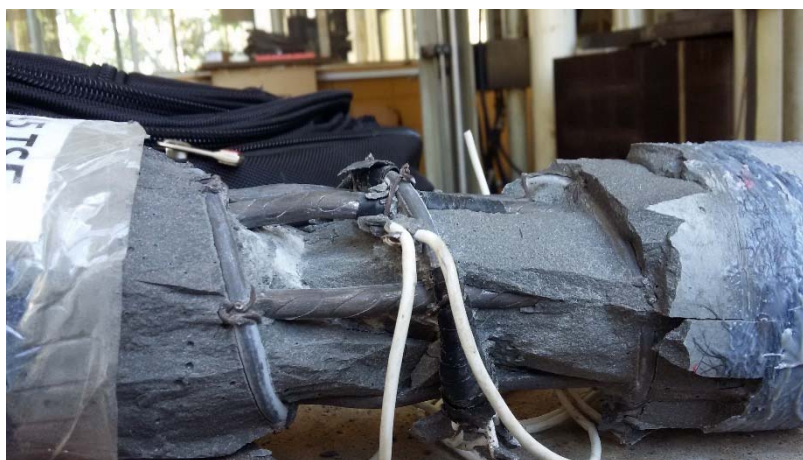
Figura 9.10 – Flambagem das armaduras longitudinais pilar MOD45TSF
