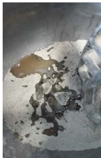
Figura 4.2 – Colocação do superplastificante
