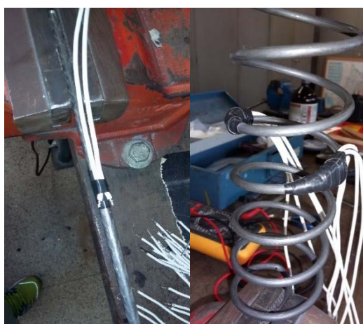
Figura 4.25—Preparação da instrumentação utilizada nas armaduras
