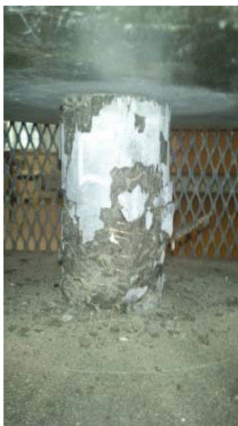
Figura 4.8 – Forma de ruptura CPR com fração volumétrica de fibras metálicas de 2,2%
