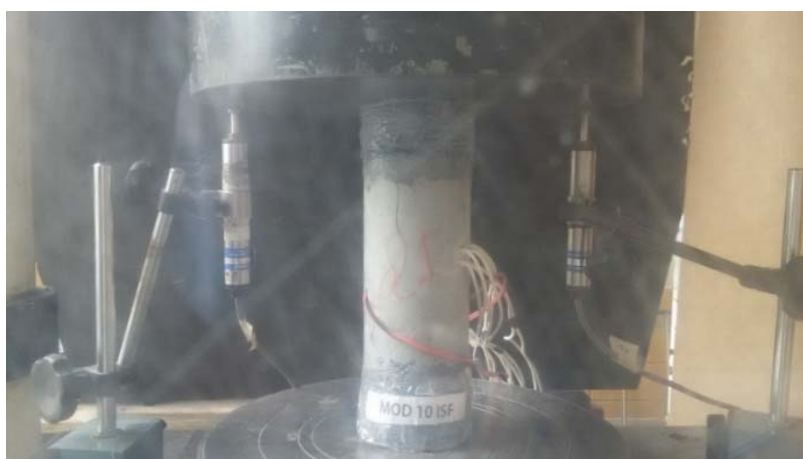
Figura 4.28 - Instrumentação utilizada para a medição dos deslocamentos verticais dos modelos
