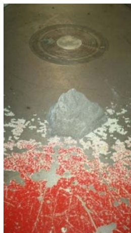
Figura 4.6 – Forma de ruptura CPR sem fibras metálicas
