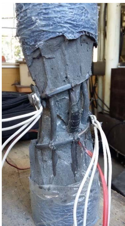
Figura 9.11 – Pilar MOD55TSF após a ruptura
