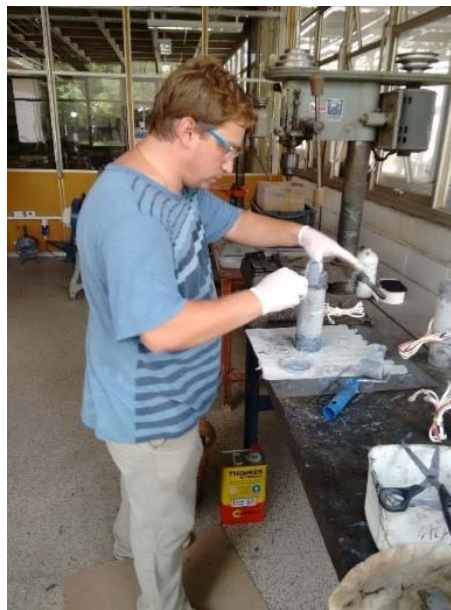
Figura 4.27 – Impregnação dos tecidos de fibras de carbono com resina epóxi
