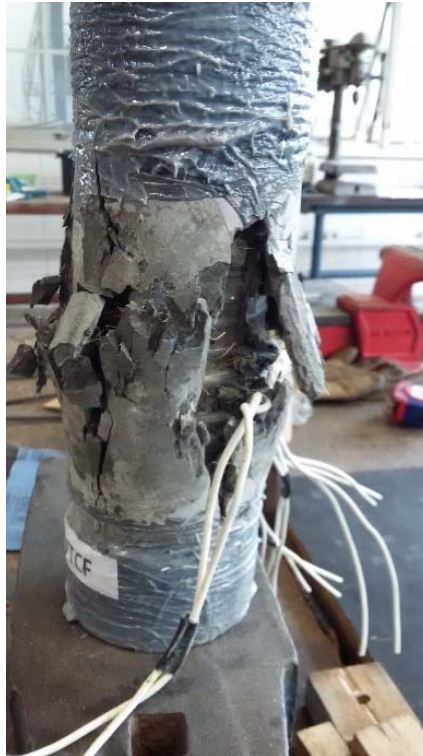
Figura 9.2 – Final do ensaio de compressão centrada do pilar MOD10TCF
