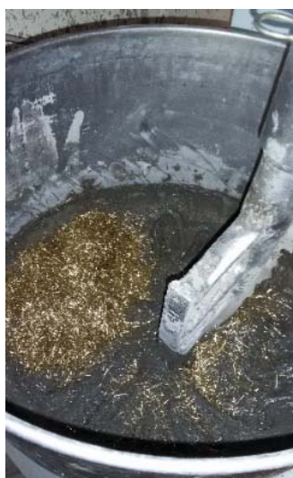
Figura 4.3 – Colocação das fibras metálicas
