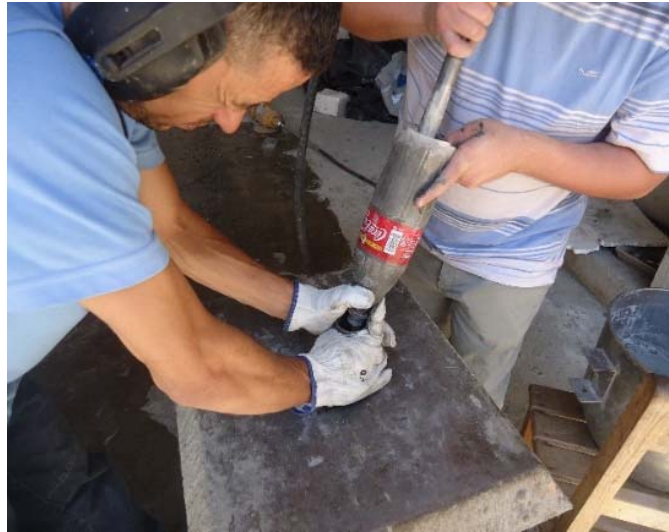
Figura 4.4 – Processo de moldagem utilizado para os corpos de prova de concretos
