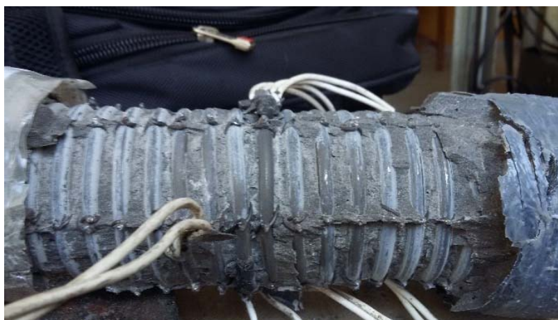
Figura 9.4 – Final do ensaio de compressão centrada do pilar MOD10TSF
