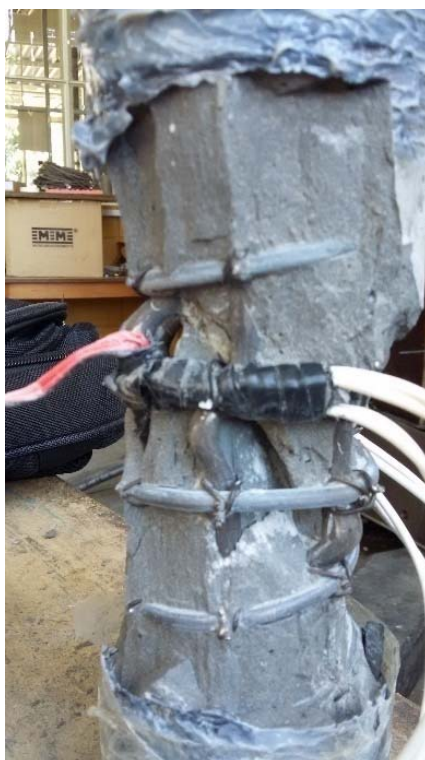
Figura 9.6 – Pilar MOD20ISF após a ruptura
