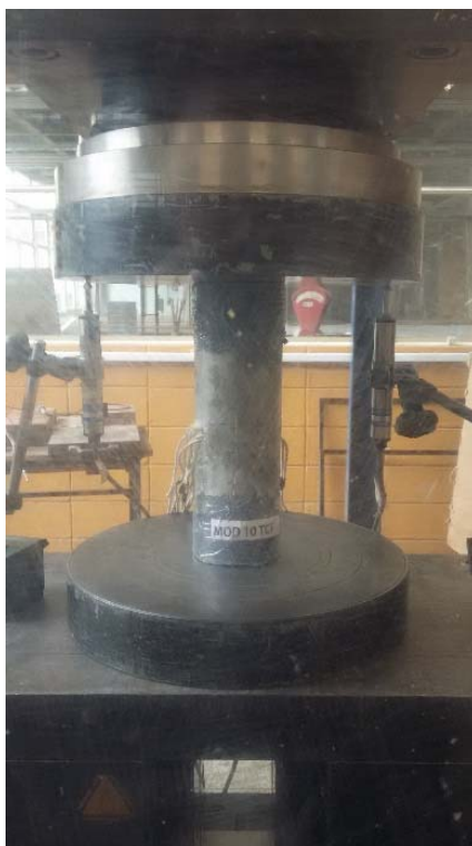
Figura 9.1 –Ensaio de compressão centrada do pilar MOD10TCF
