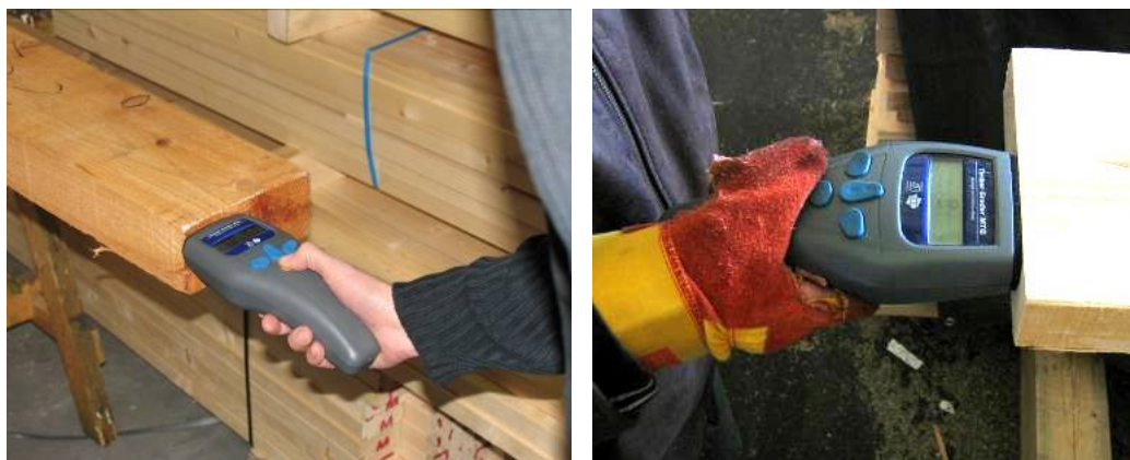
Figura 11 – Medições do módulo de elasticidade com o MTG utilizando ativador interno.
