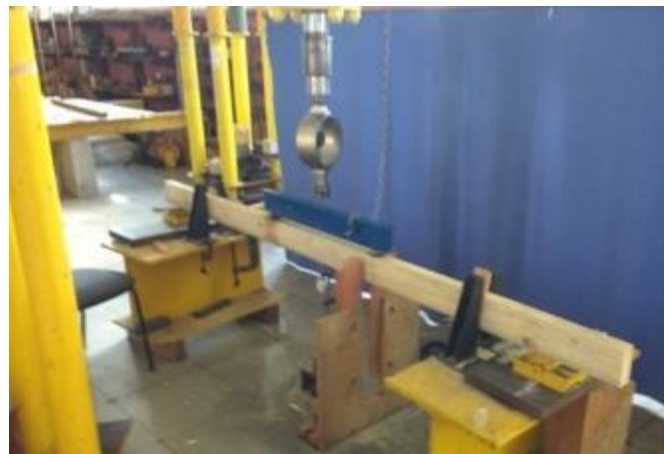
Figura 20 – Montagem do ensaio estático para obtenção do MOE e MOR
