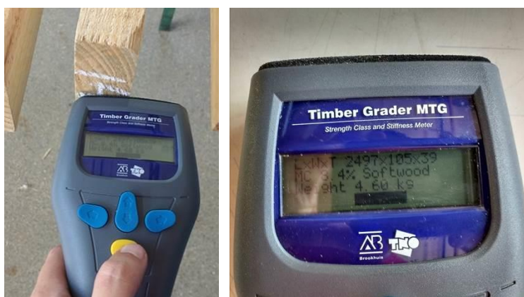
Figura 18 – Posicionamento do MTG para obtenção do MOE estimado e display do aparelho.
