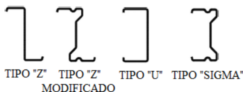
Figura 2.3 – Perfis de aço comuns na fabricação de terças (adaptada de YE, 2013).
