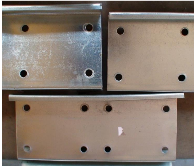
Figura 4.4 – Aspecto dos furos do protótipo ZA62-L44 após ensaio.
