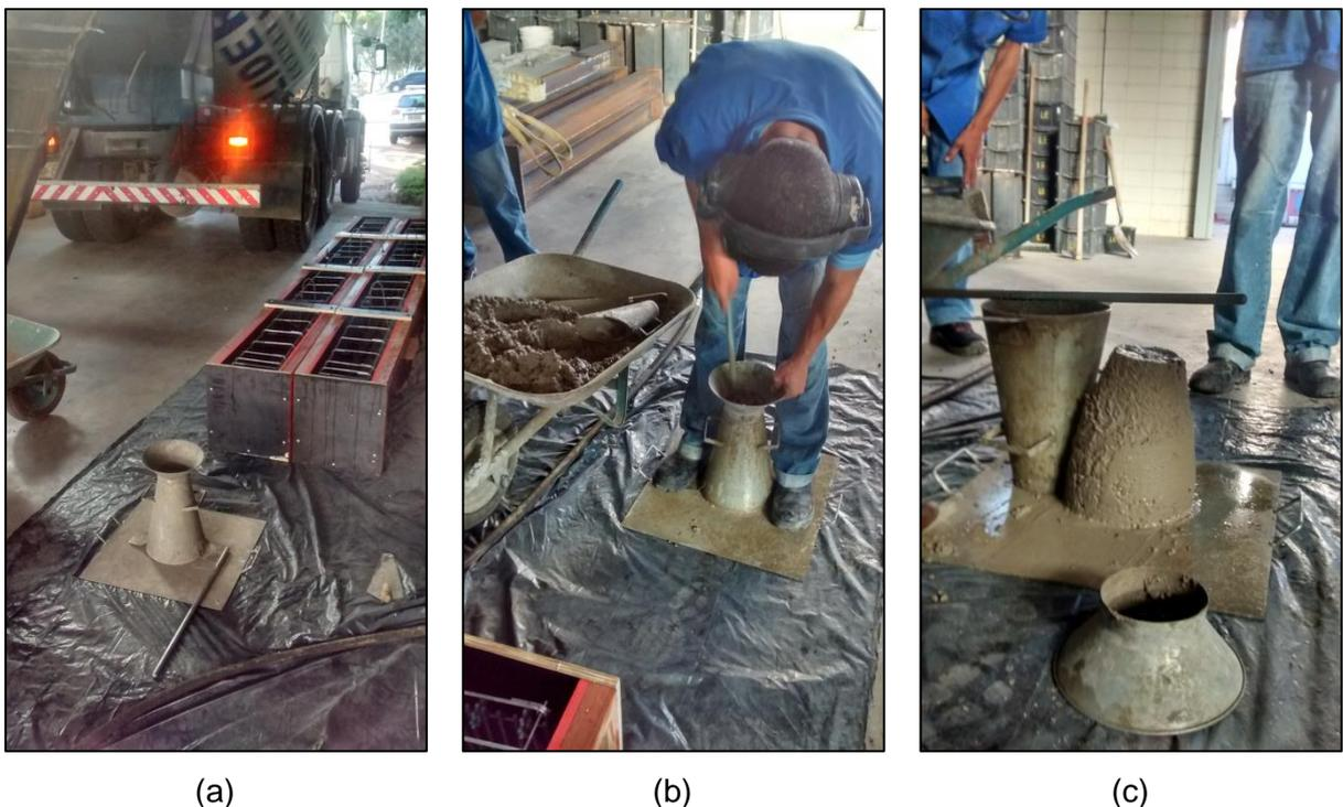
**Figura 16** - (a) Local e equipamentos utilizados no ensaio; (b) compactação da amostra de concreto com auxílio da haste compactação; (c) medição do abatimento do concreto amostrado. Fonte: Autoria própria.
