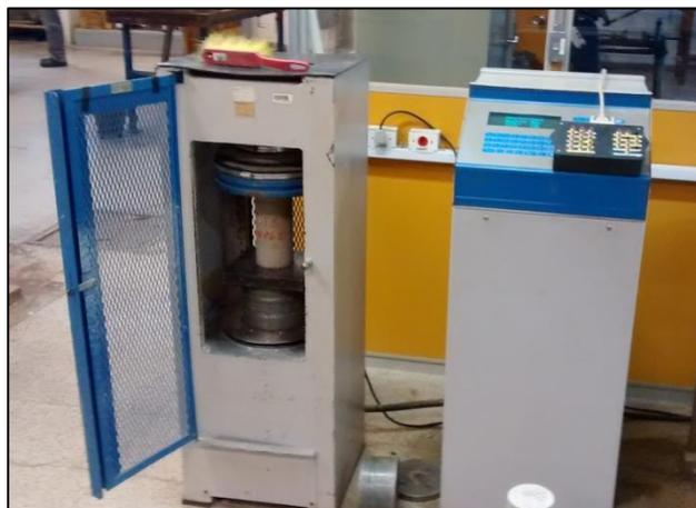
**Figura 20** - Equipamento de ensaio à compressão axial do LE-SET-EESC-USP. Fonte: Autoria própria.
