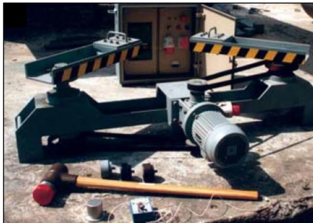
**Figura 1** - Excitador de massa excêntrica utilizado em ensaios modais de grandes estruturas. Fonte: Cunha e Caetano (2006, p. 12).
