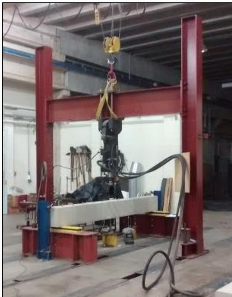
**Figura 33** - Aparato de carregamento: atuador acoplado no pórtico metálico fixado na laje de reação. Fonte: Autoria própria.
