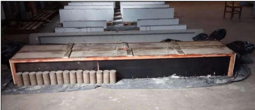
**Figura 19** - Cura e condições climáticas dos modelos V01 e V02 e dos CPs. Fonte: Autoria própria.
