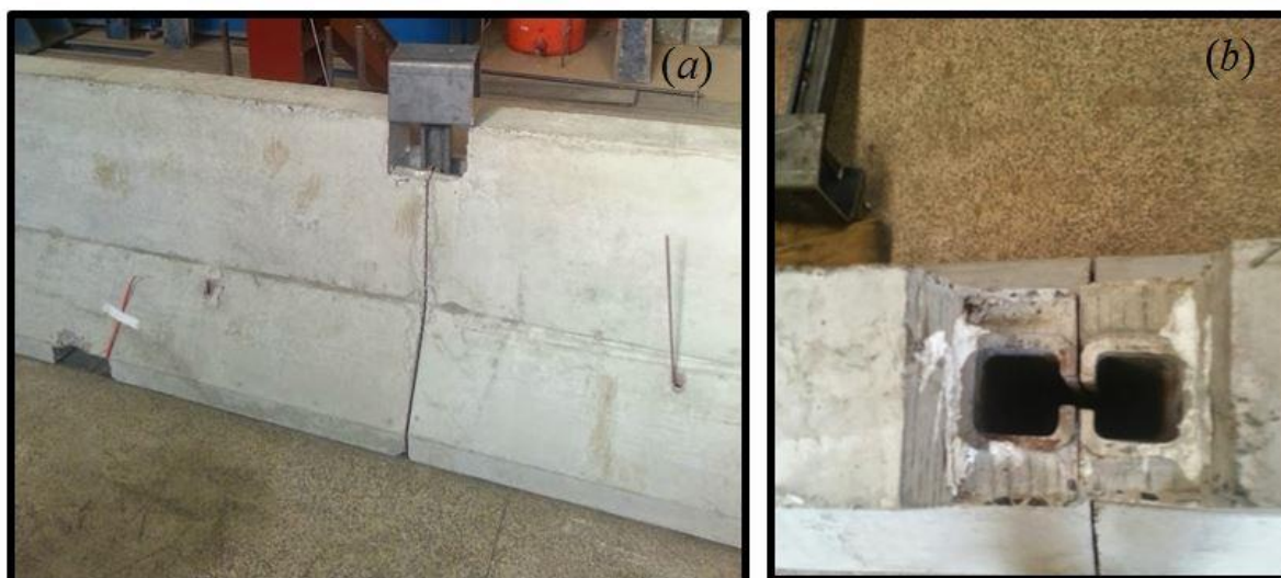
Figura 4.3 – (a) Padrão de encaixe do pino conector BNJ-NY, (b) Vista superior do conector BNJ-M
