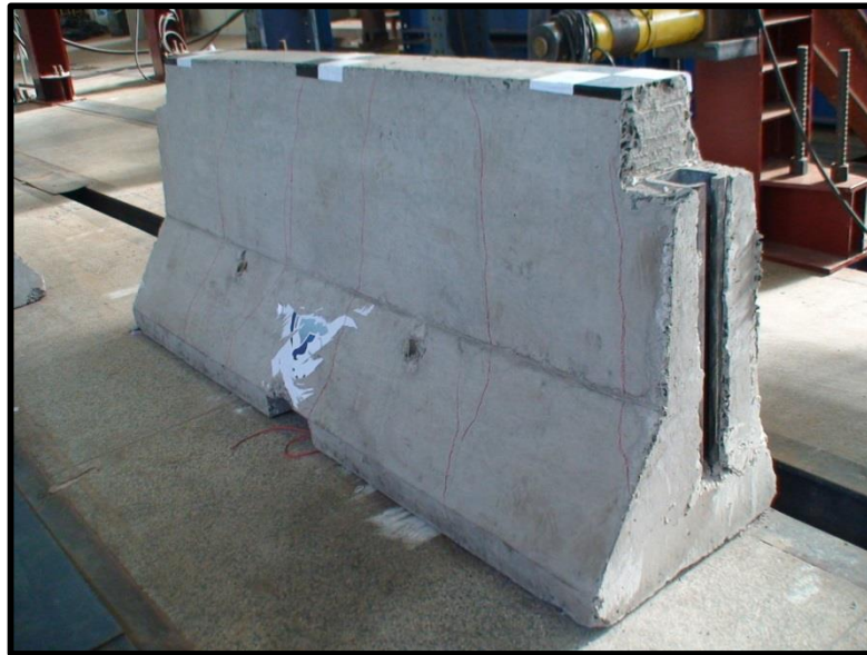
Figura 4.26 – Linhas de ruptura na barreira BNJ-NY
