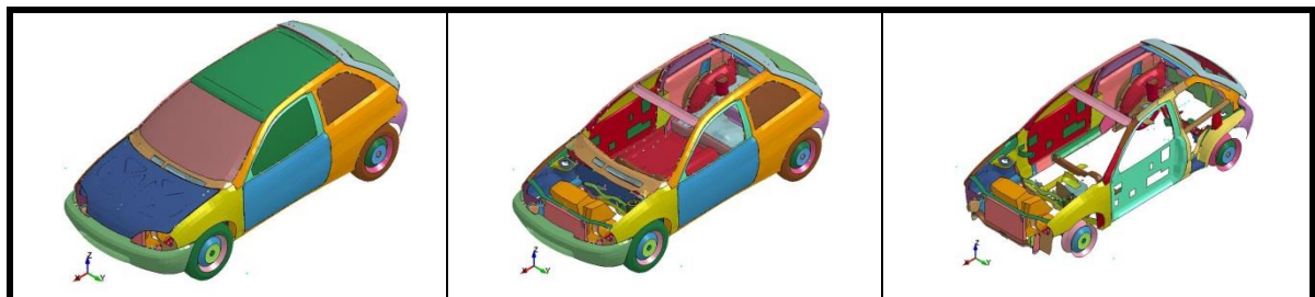
Figura 5.20 – Modelo de Elementos Finitos de um carro de passeio GM® Corsa.
