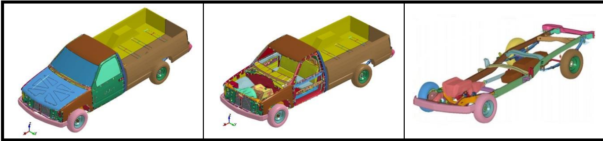
Figura 5.16 – Modelo de Elementos Finitos de uma Camionete Chevrolet ® C2500 Pickup.
