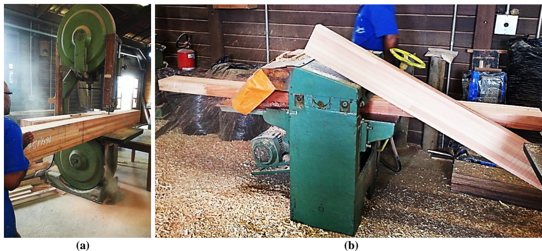
Figura 3.10: Processo de preparação dos corpos de prova. (a) Serra de Fita; (b) Plaina.
