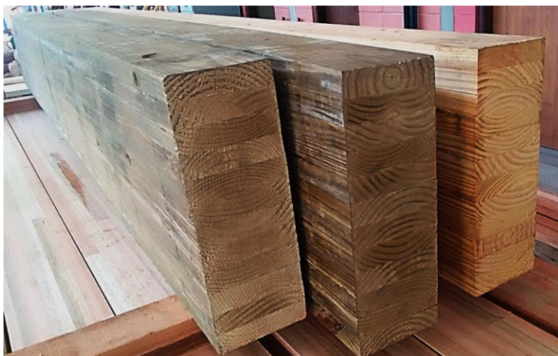
Figura 3.2: Elementos estruturais da espécie Pinus depois de realizado o tratamento preservante.
