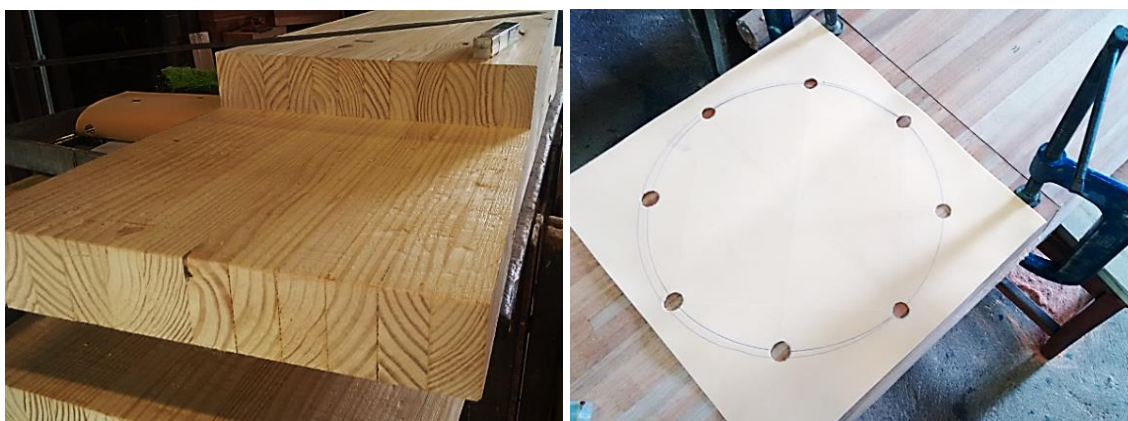
Figura B.9: Detalhe do corte e molde para a realização da ligação.
