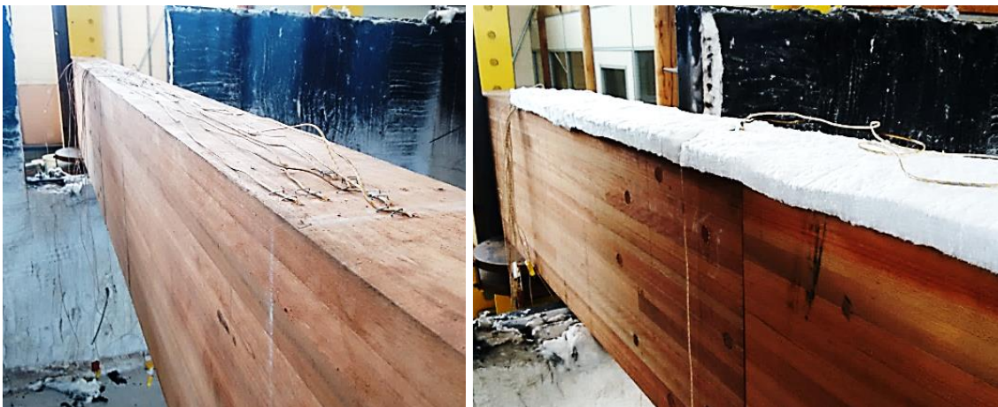
Figura 3.58: Isolamento da face superior do elemento.
