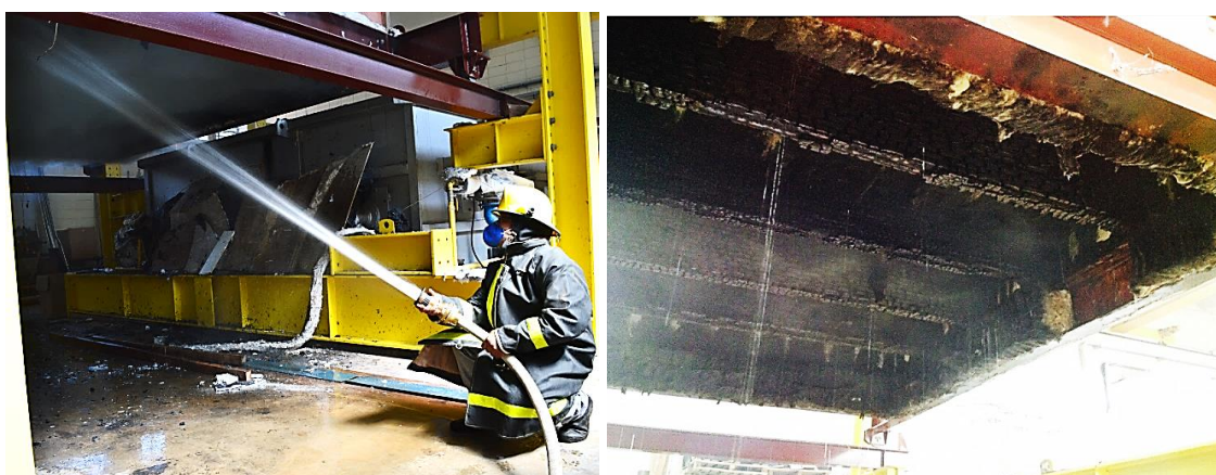
Figura 3.34: Processo de resfriamento das vigas imediatamente após o ensaio.
