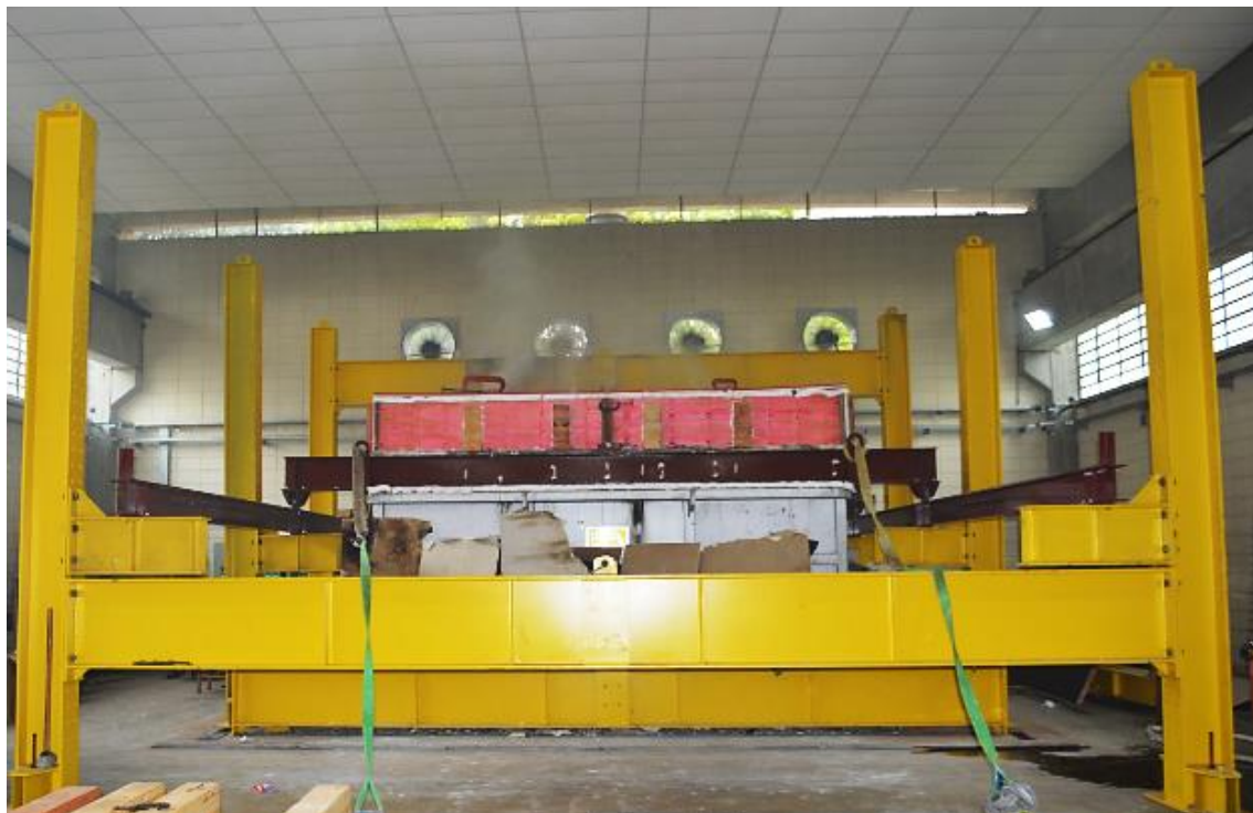
Figura 3.29: Visão Geral do Equipamento de Ensaio com viga de rolamento para remoção do quadro de apoio.
