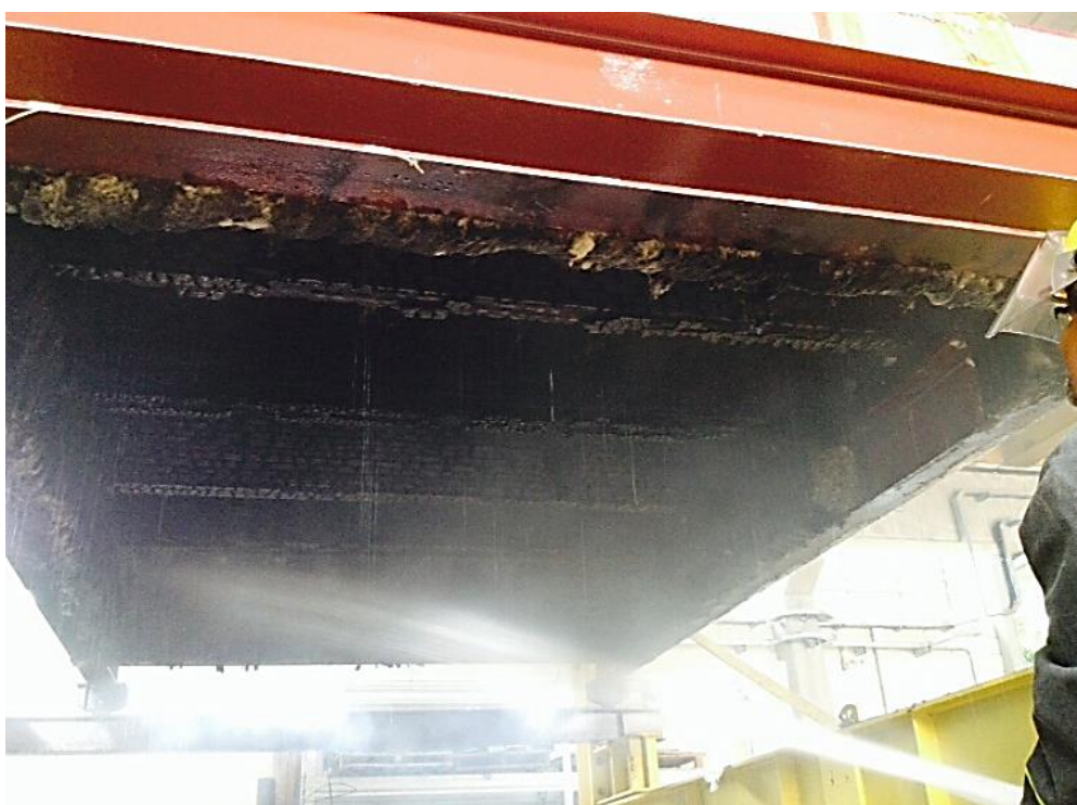
Figura C.2: Resfriamento dos elementos após o ensaio.
