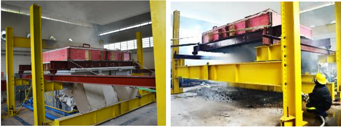
Figura 3.30: Posicionamento do quadro: (a) Durante o ensaio; (b) Finalização com extinção das chamas residuais.
