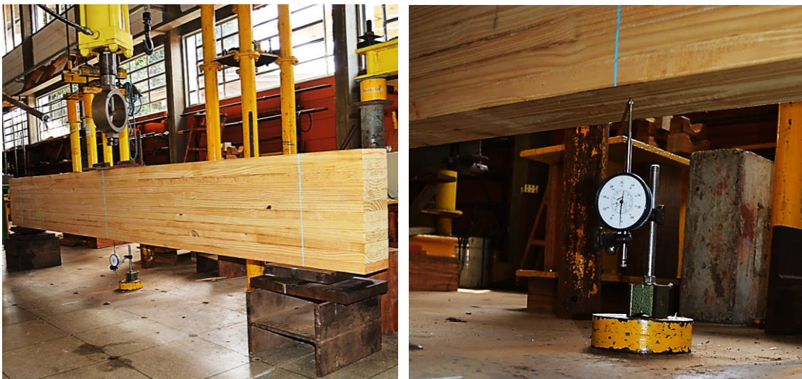
Figura 3.5: Instrumentação para medição dos deslocamentos transversais no meio do vão.
