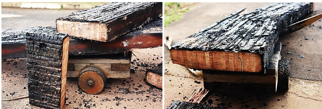
Figura A.6: Seção transversal após o ensaio.
