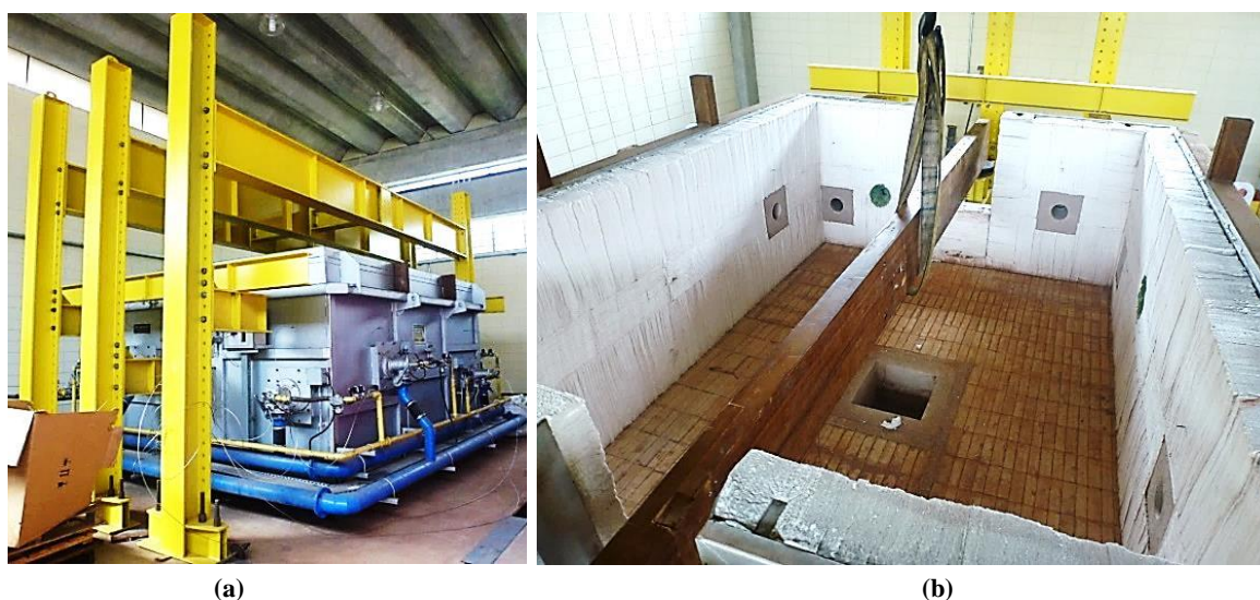
Figura 3.19: Forno Horizontal para ensaios de lajes e vigas: (a) visão geral (b) detalhes do interior
