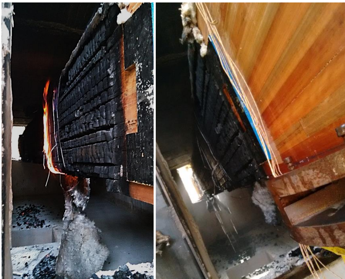
Figura C.6: Vigas de Lyptus no interior do forno depois de encerrado o ensaio termestrutural.
