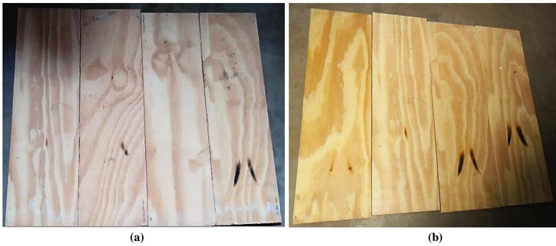
Figura 3.16: Painéis depois de expostos a chamas: (a) FR 400 (I); (b) FR 400 Normal.
