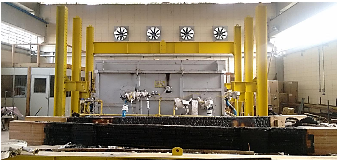
Figura 3.70: Vigas Carbonizadas após a retirada do interior do forno horizontal.
