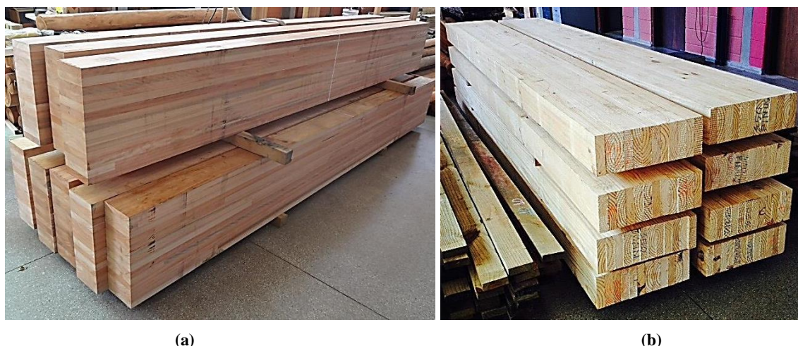
Figura 3.1: Lote de elementos estruturais de MLC: (a) Lyptus®; (b) Pinus.
