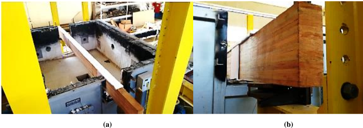
Figura 3.57: Posicionamento da viga no interior do forno: (a) visão geral; (b) detalhe do apoio nos consoles.
