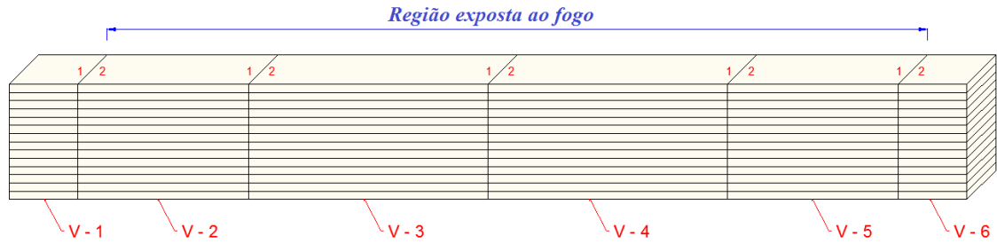
Figura 3.35: Layout dos cortes realizados para determinação da seção transversal residual.
