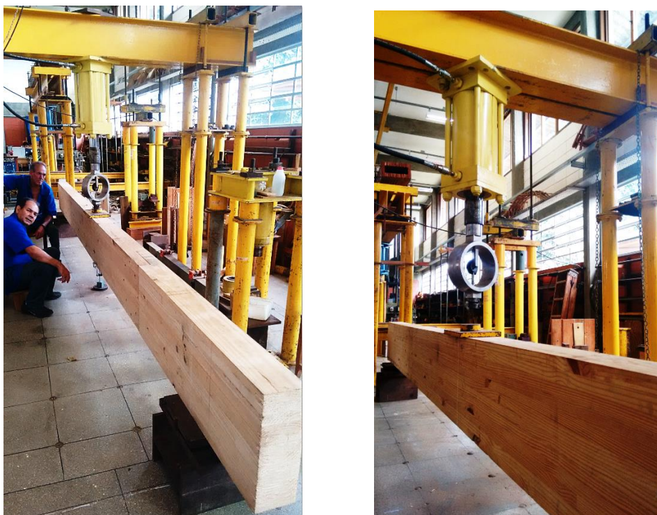
Figura 3.66: Ensaio de flexão a três pontos em elementos estruturais.
