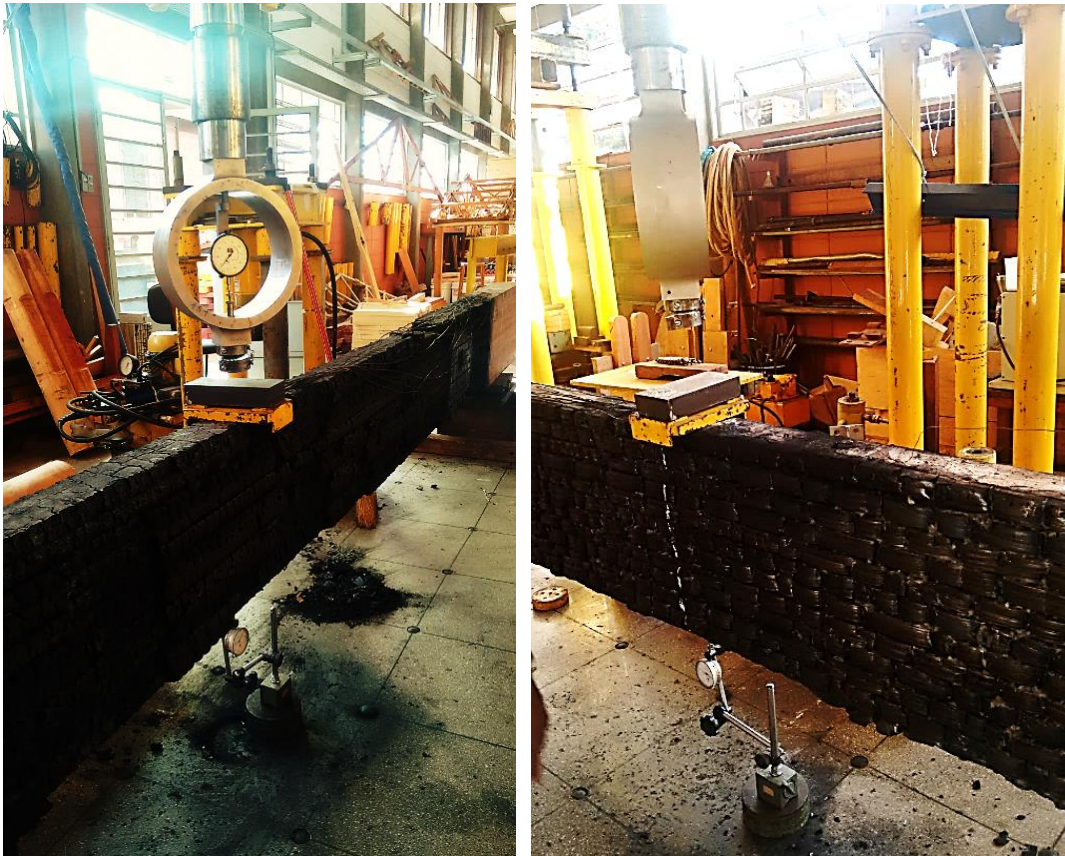
Figura 3.71: Instrumentação para determinação do Módulo de Elasticidade.
