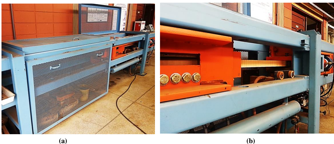
Figura 3.12: Máquina para ensaios de tração marca METRIGUARD.
