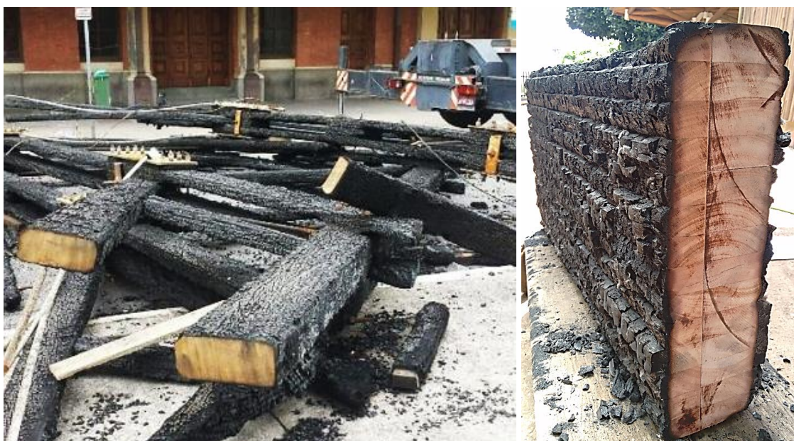
Figura 2.6: Estruturas de madeira afetadas por temperaturas elevadas. Fonte: Website AV Studio 3
