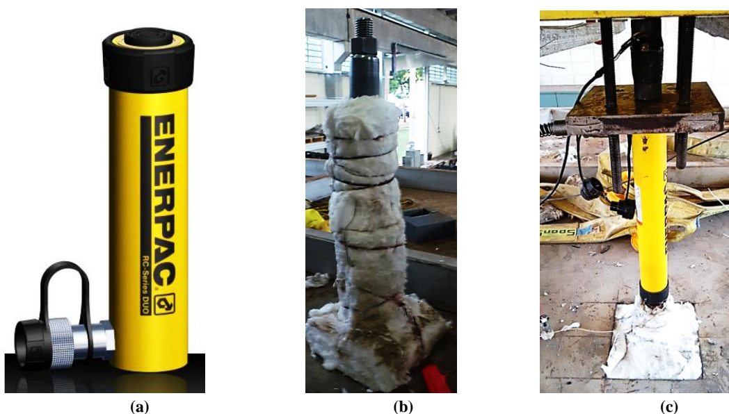
Figura 3.59: Sistema de aplicação de carga: (a) cilindro hidráulico; (b) prolongador isolado; (c) célula de carga.
