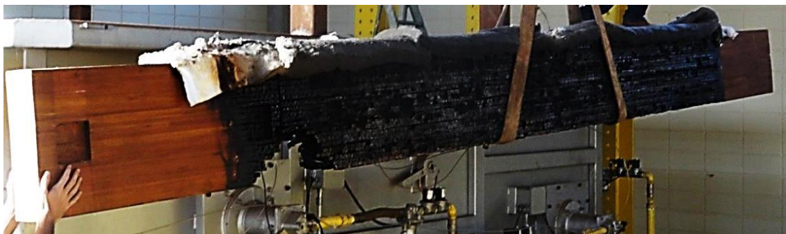
Figura A.5: Retirada da viga após o ensaio.
