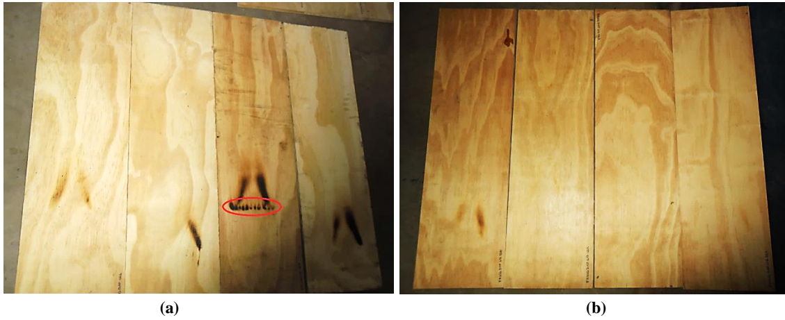
Figura 3.15: Painéis depois de expostos a chamas: (a) FR 100 DAP; (b) FR100 (II).
