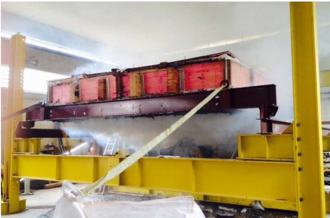
Figura C.1: Revestimento térmico realizado nos ensaios para avaliação de carbonização
