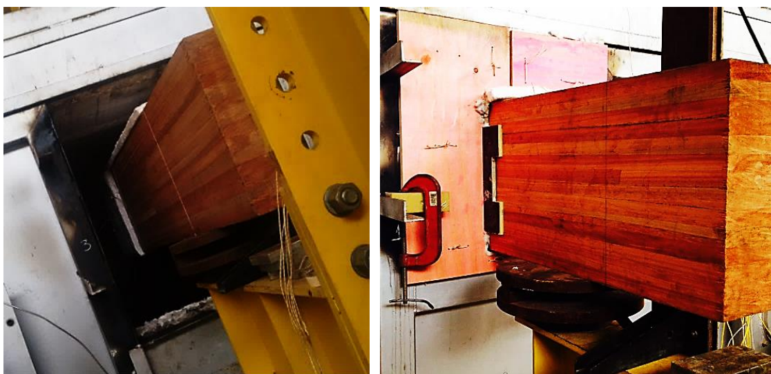
Figura 3.63: Isolamento nas laterais do forno horizontal.
