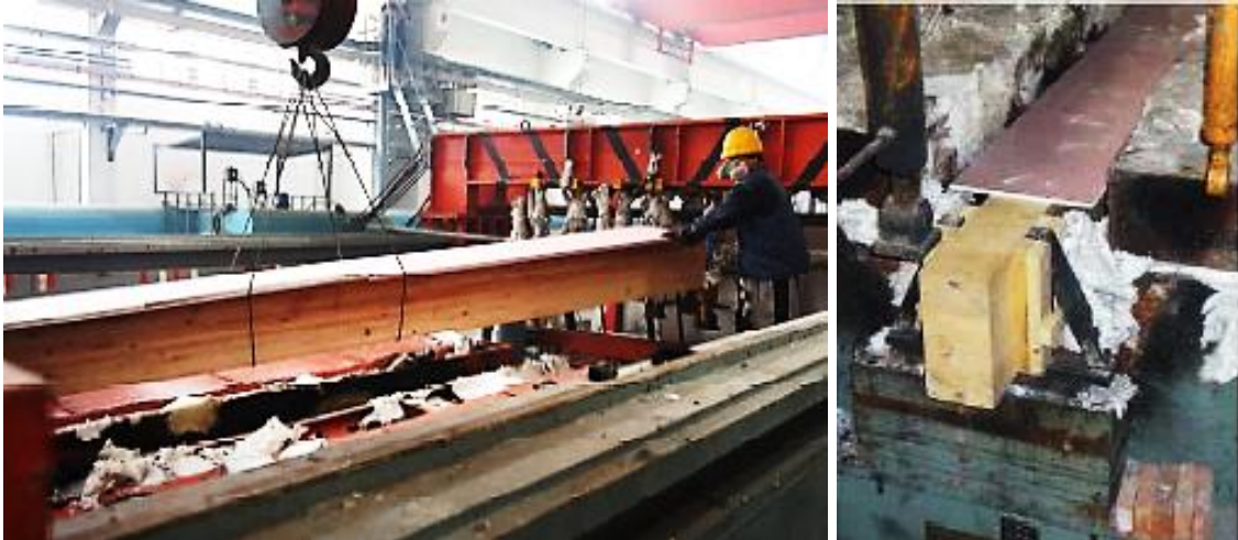
Figura 2.9: Preparação do ensaio com posicionamento da viga. Fonte: Zhaopeng e Peifang (2012)
