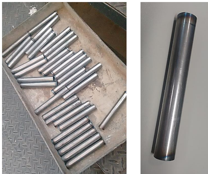
Figura B.7: Pinos metálicos confeccionados para a ligação.
