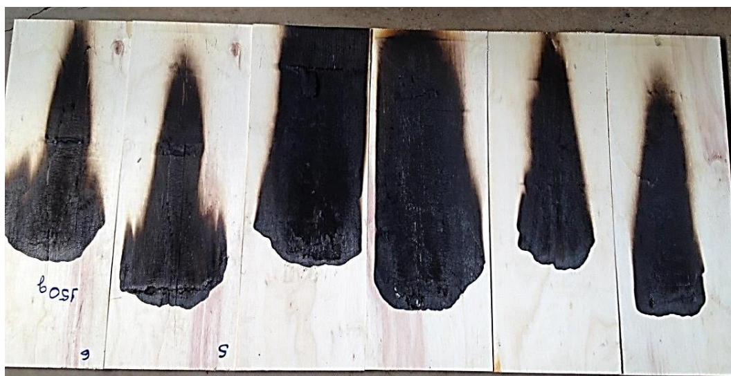
Figura 3.18: Painéis sem tratamento depois de expostos a chamas.
