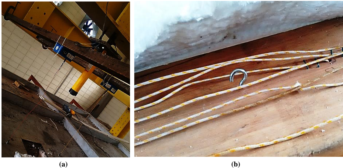
Figura 3.61: Sistema de leitura de deformações: (a) Posicionamento dos transdutores; (b) gancho para fixação dos fios para controle do deslocamento da viga.
