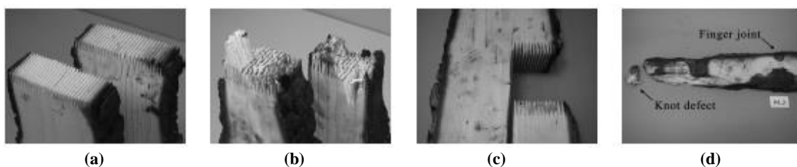
Figura 2.29: Tipos de ruptura: (a) falha na emenda ao longo dos fingers; (b) falha no finger joint; (c) falha mista; (d) falha na região fora da emenda. Fonte: Klippel (2014)
