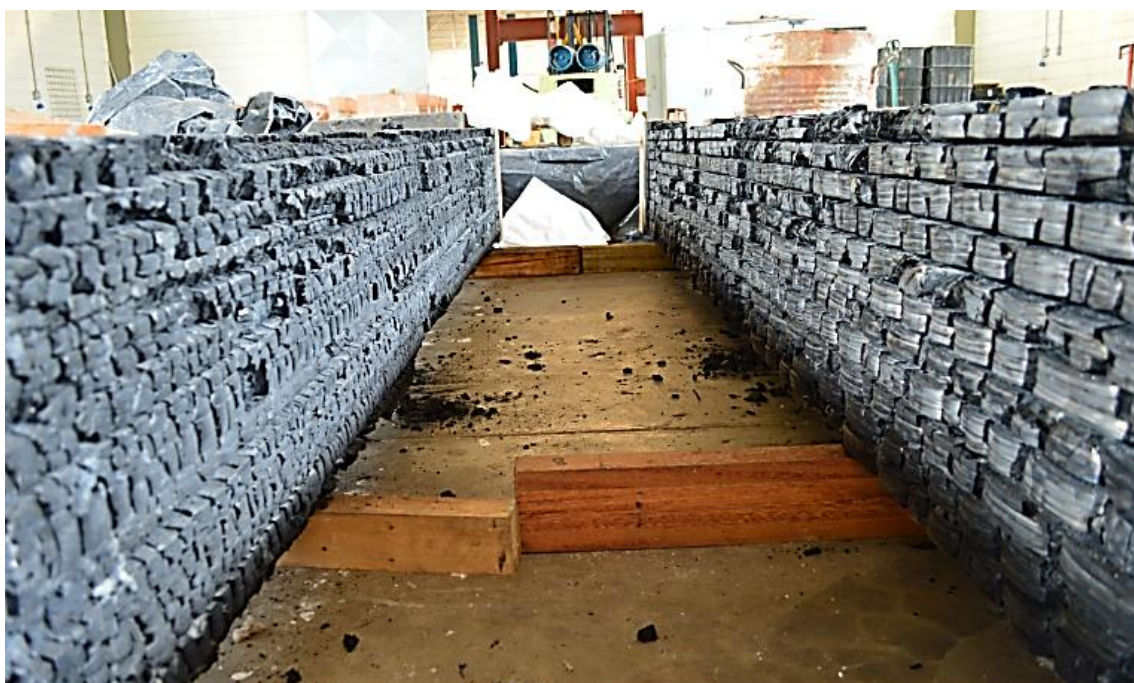
Figura C.5: Elementos estruturais de MLC depois de expostos ao fogo por 30 minutos
