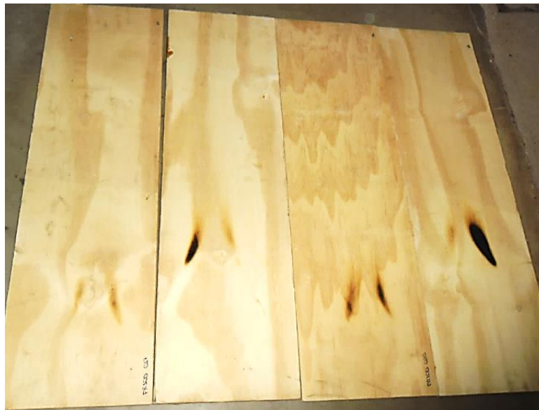
Figura 3.17: Painéis depois de expostos a chamas com o tratamento FR 100 Normal Autoclave
