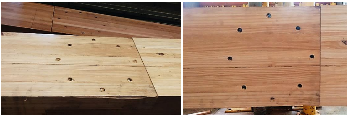
Figura 3.65: Detalhes da ligação circular resistente à momento.
