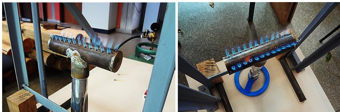
Figura 3.14: Dispositivo para distribuidor de chamas
