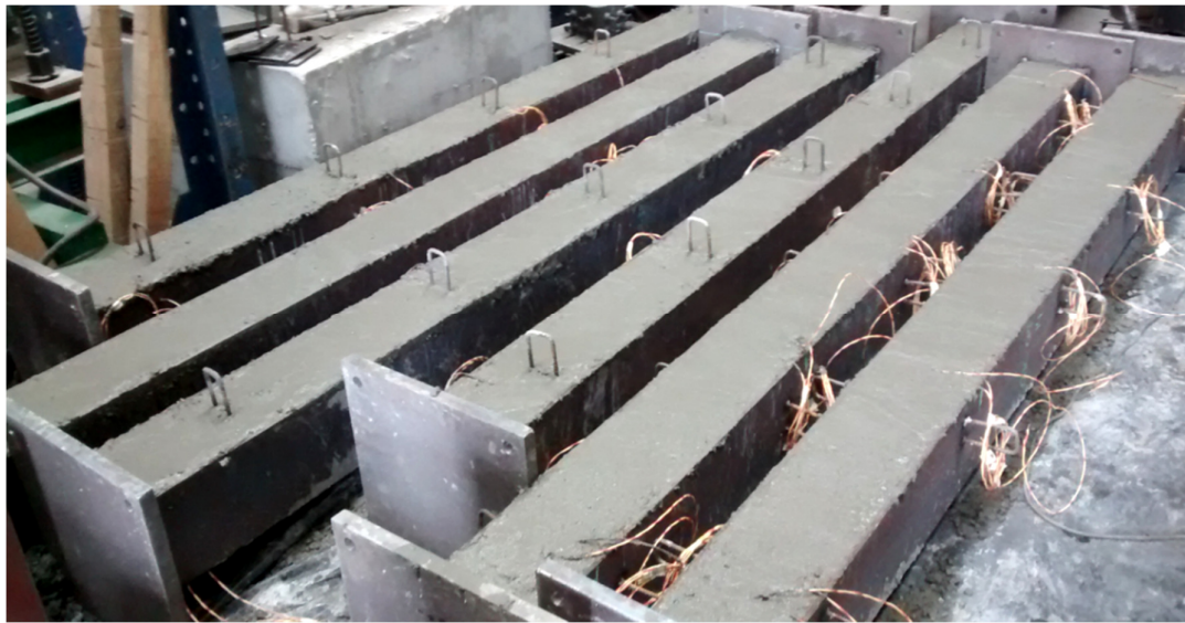
Figura 3.3 - Pilares concretados em um dos lados.
