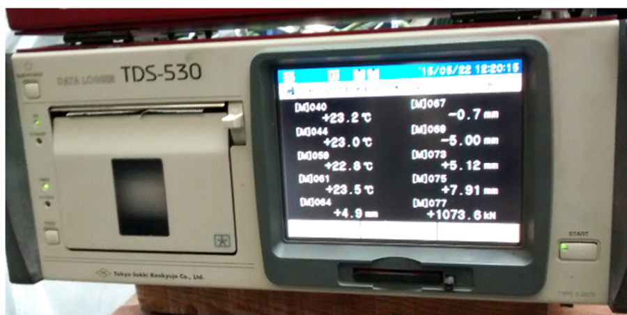
Figura 3.14 – Representação visual instantânea de alguns resultados durante o ensaio, por meio do sistema de aquisição de dados TML TDS-530.
