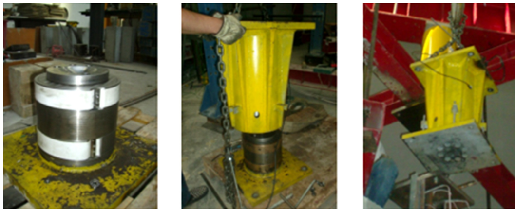
Figura 3.12 - Dispositivo de medição dos esforços axiais, Correia (2011).
