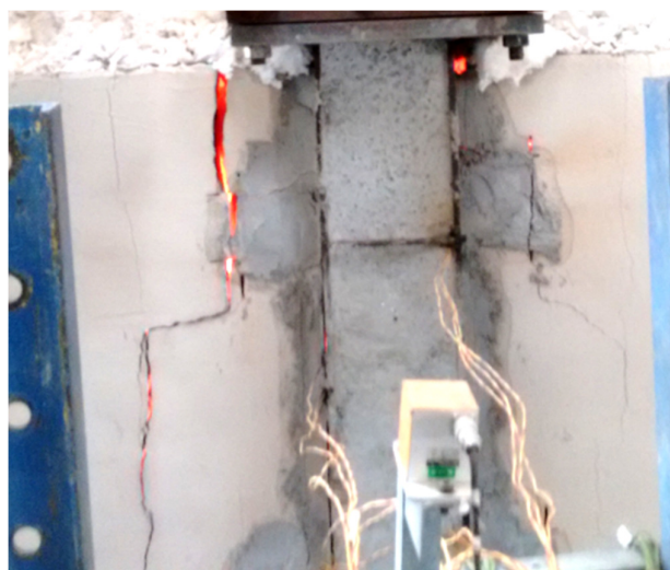
Figura 3.46 - Vista frontal da rachadura desenvolvida durante o ensaio H220-CONC-PAR-T15.
