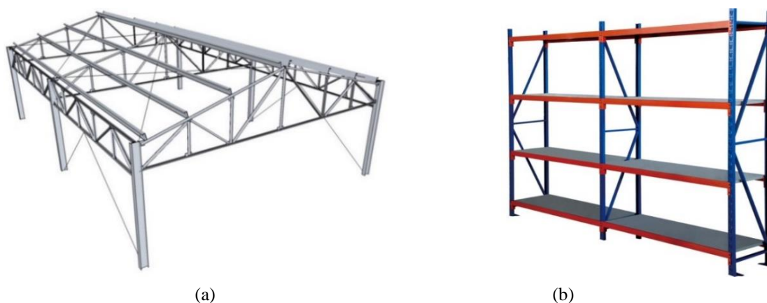
Figura 1.1 – Exemplos de estruturas constituídas por perfis de aço formados a frio: (a) galpões para usos gerais e (b) estruturas para armazenamento
