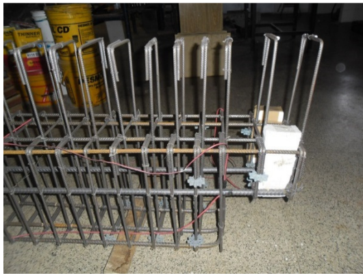
Figura 3.33 – Foto da preparação da viga para concretagem
