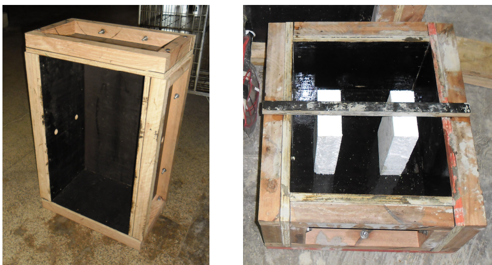
Figura 3.8 – Fôrmas para moldagem do modelo de chumbador
