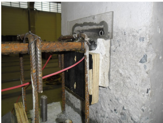
Figura 3.58 – Preparação para o grauteamento
