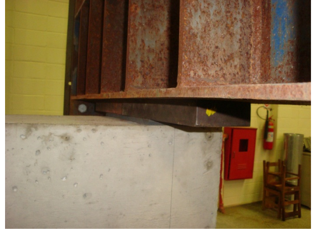
Figura 3.66 - Apoio da parte superior da viga
