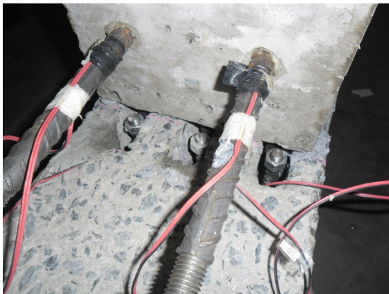
Figura 3.48 – Detalhe do transpasse das barras
