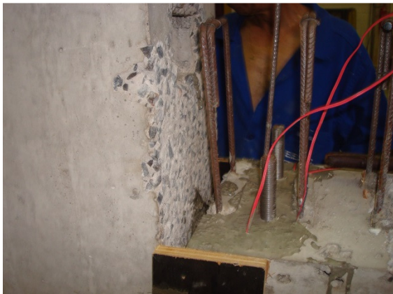
Figura 3.55 – Grauteamento do chumbador e interface
