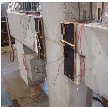
Figura 3.54 – Fôrmas para grauteamento
