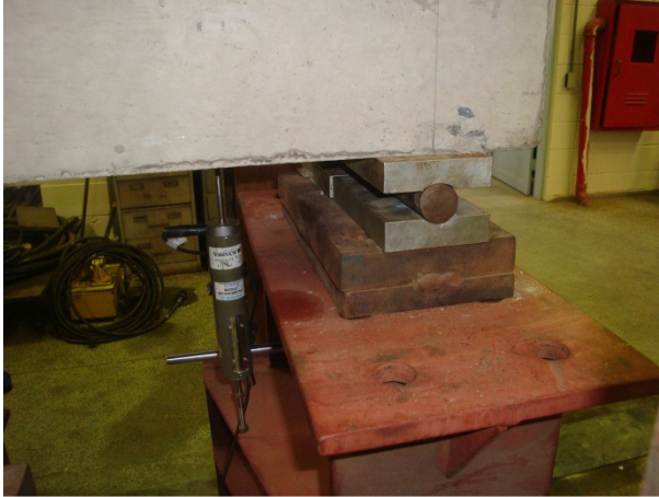
Figura 3.65 - Apoio da parte inferior da viga
