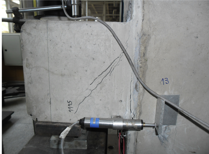
Figura 5.3 – Detalhe do transdutor de deslocamento na interface consolo-pilar
