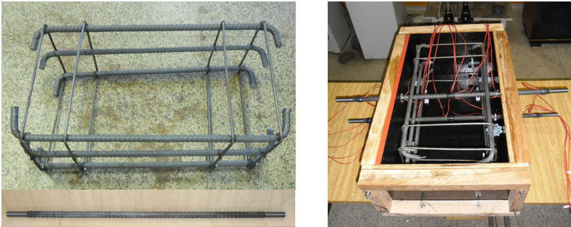
Figura 3.10 – Armadura para os modelos de chumbador com fibras de aço
