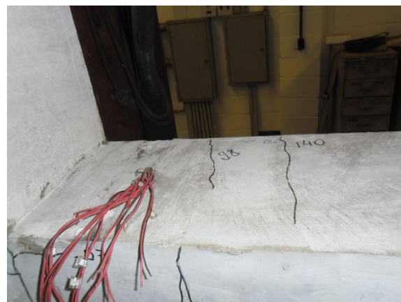
Figura 5.11 – Detalhe das fissuras da parte superior da viga à a) esquerda e b) direita
