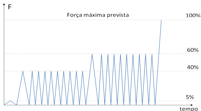
Figura 3.7 – Ciclos de carregamento e descarregamento aplicados nos modelos
