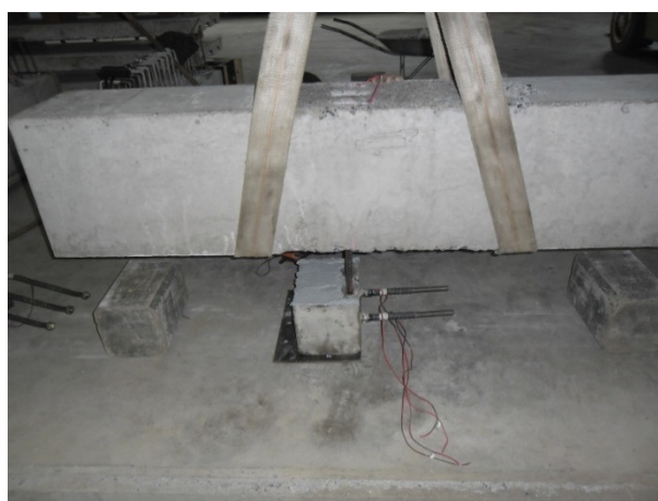
Figura 3.45 – Posicionamento do consolo no pilar
