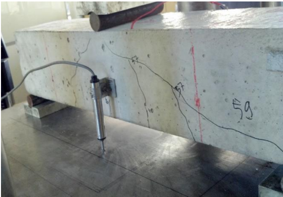
Figura 4.1 – Fissuras no Prisma P40 SR
