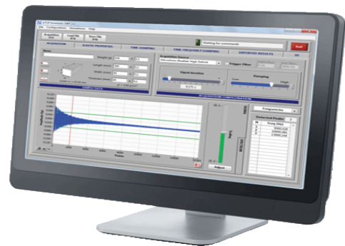
Figura 3.14 – Módulo de elasticidade longitudinal com Sonelastic® e Interface gráfica do programa (Fonte: página oficial da ATCP).
