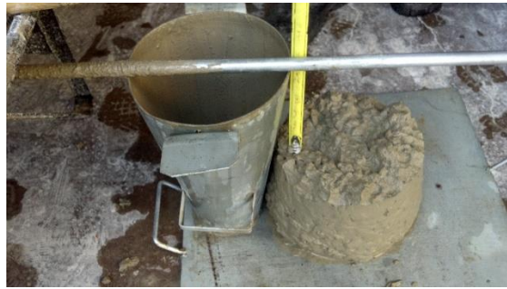
Figura 3.10 – Abatimento do concreto
