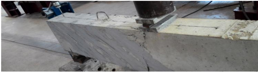
Figura 7.3 – Fissuração da viga V50 CFRP
