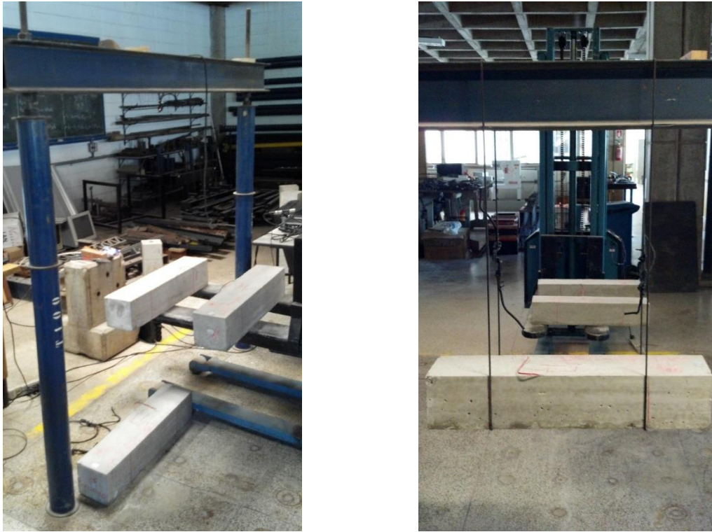
Figura 3.15 – Pórtico para suspender os prismas e apoio em elásticos
