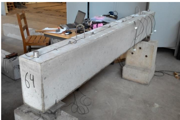
Figura 5.18 – Posicionamento dos acelerômetros e suporte metálicos
