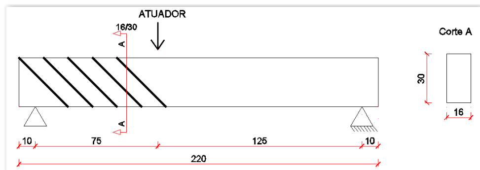
Figura 5.1 – Esquema de ensaio das vigas
