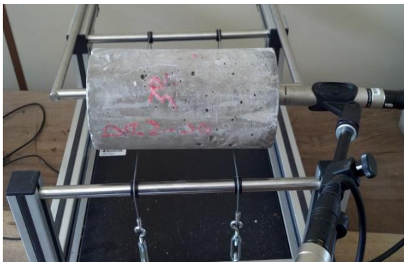
Figura 3.14 – Módulo de elasticidade longitudinal com Sonelastic® e Interface gráfica do programa (Fonte: página oficial da ATCP).
