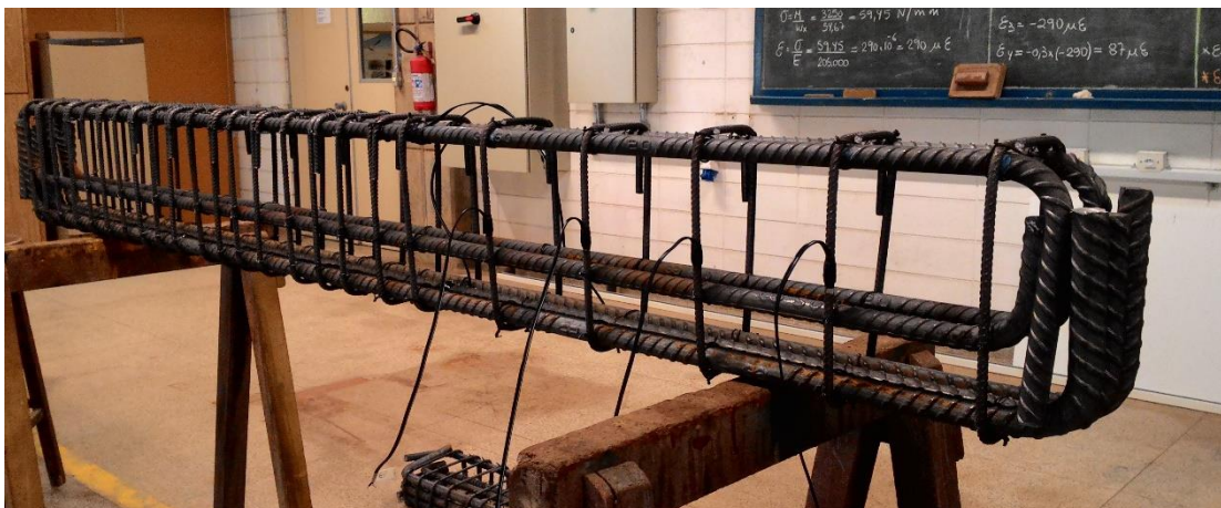
Figura 5.4 – Esquema e imagem da instrumentação de extensômetros nas vigas
