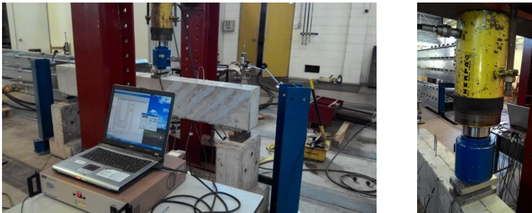
Figura 5.15 – Esquema de ensaio com detalhe do atuador hidráulico
