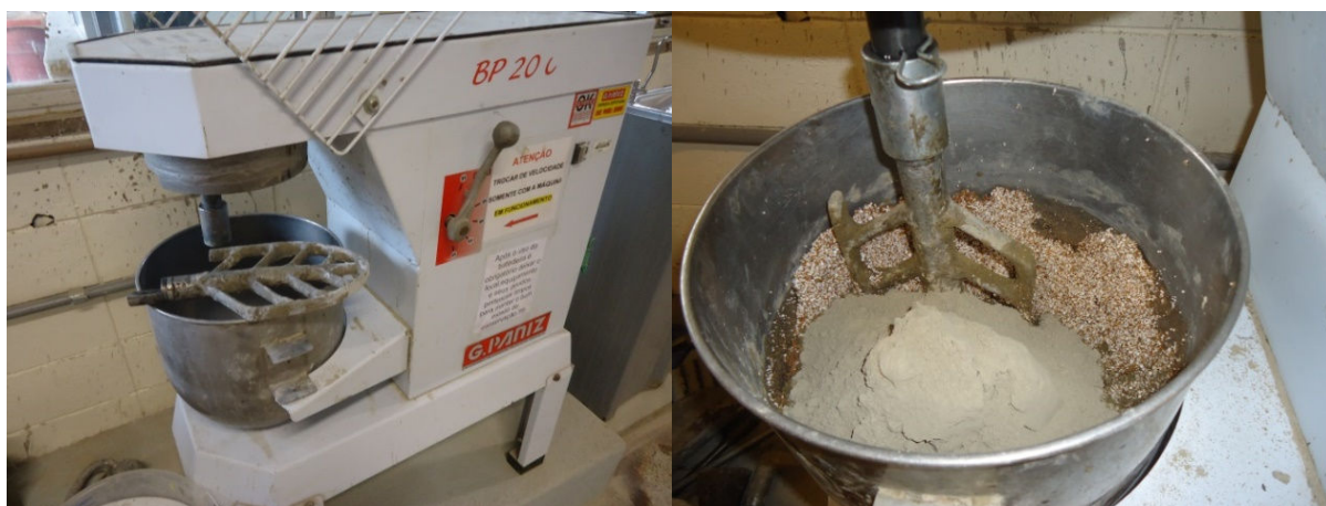
Figura 11: Traço confeccionado no misturador tipo argamassadeira com capacidade de 20 litros
