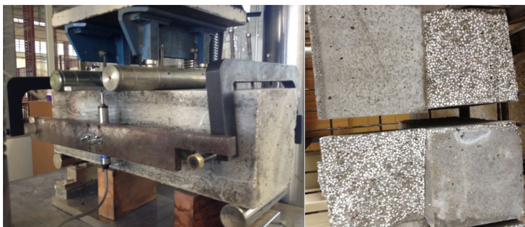
Figura 22: Ensaio de flexão em prismas de concreto leve e prismas após a ruptura
