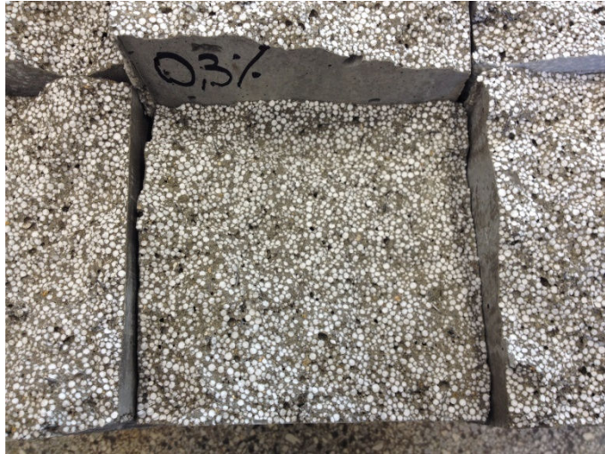
Figura 73: Prismas com adição de 0,3% de fibras de aço
