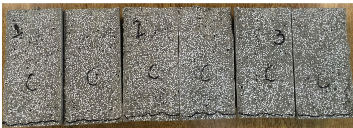
Figura 51: Absorção por capilaridade – TF-9
