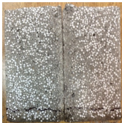
Figura 24: Perfil de capilaridade de água no interior do corpo de prova cilíndrico
