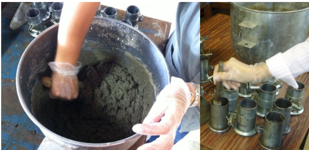
Figura 13: Moldagem de corpos de prova com vibração manual
