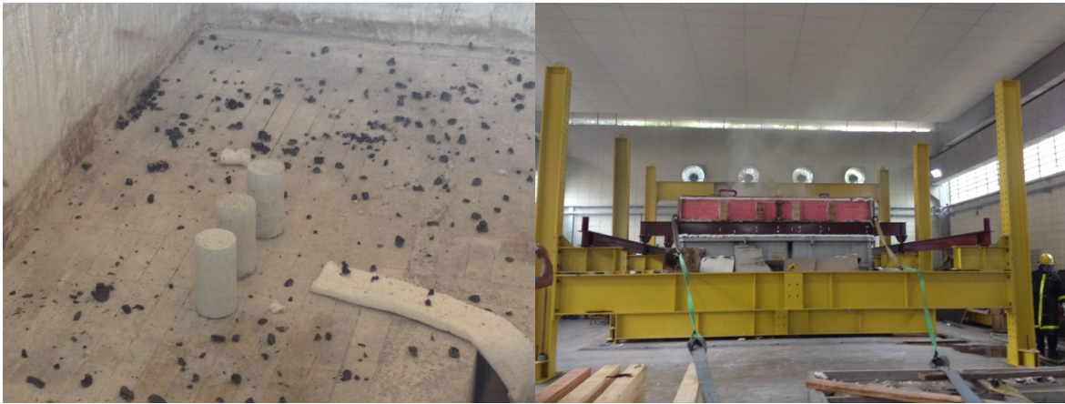
Figura I: Corpos de prova no interior do forno e vista do forno onde ocorreu a queima
