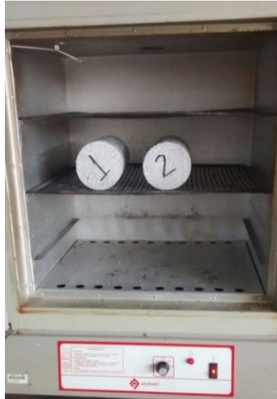
Figura 23: Secagem dos corpos de prova
