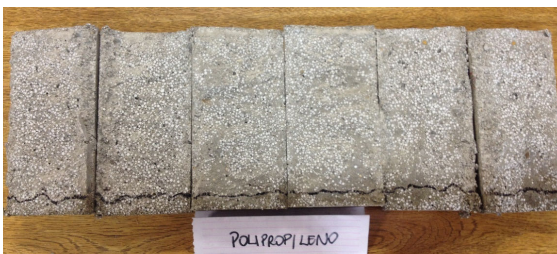
Figura 50: Absorção por capilaridade – TF-8
