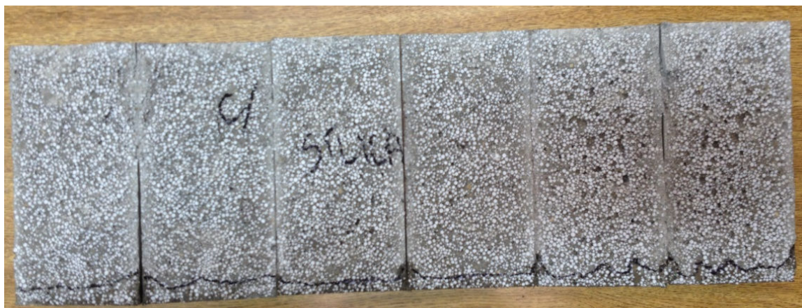
Figura 49: Absorção por capilaridade – TF-7
