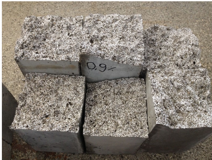
Figura 74: Prismas com adição de 0,9% de fibras de aço
