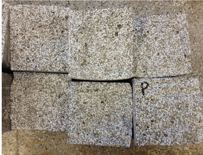
Figura 69: Prismas com adição de 0,2% de fibras de polipropileno
