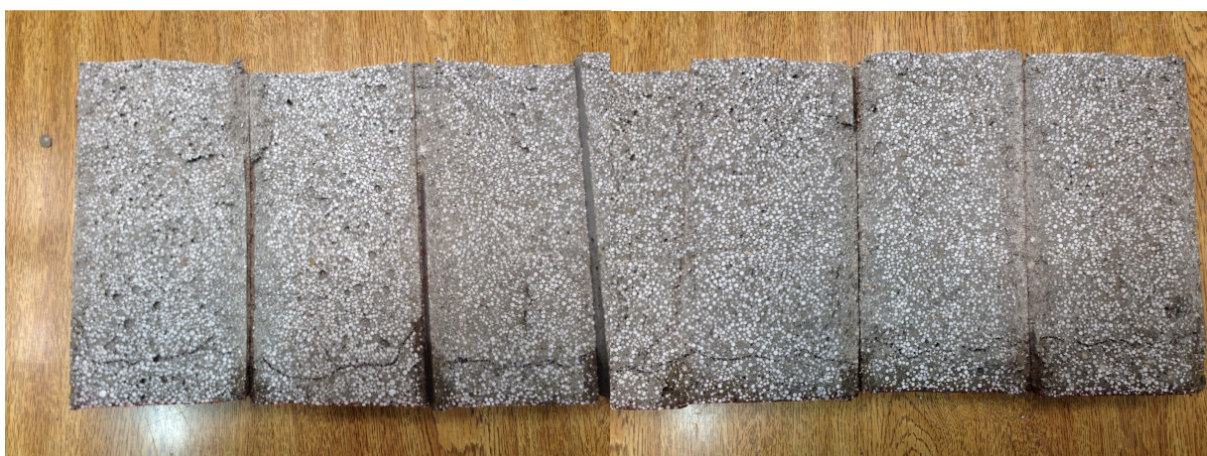
Figura 46: Absorção por capilaridade – TF-2
