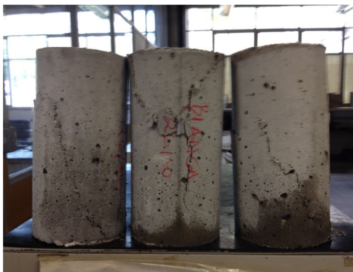
Figura 41: Concreto leve com EPS após avaliação da tensão remanescente
