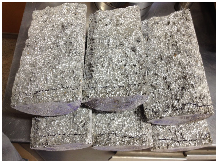
Figura 48: Absorção por capilaridade – TF-6
