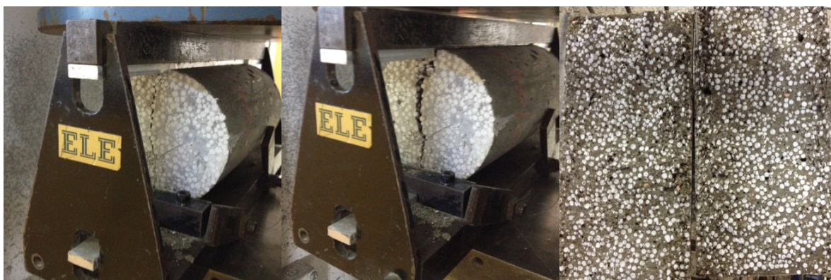
Figura 21: Ensaio de compressão diametral
