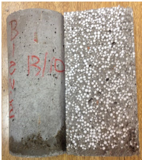
Figura 45: Absorção por capilaridade – TF-1
