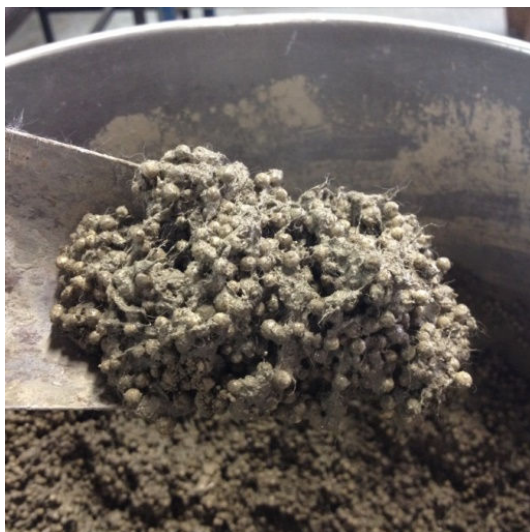
Figura 35: Dosagem com adição de fibras de polipropileno
