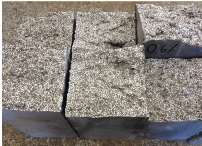
Figura 70: Prismas com adição de 0,6% de fibras de aço
