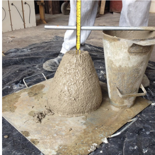
Figura 16: Ensaio de abatimento do tronco de cone
