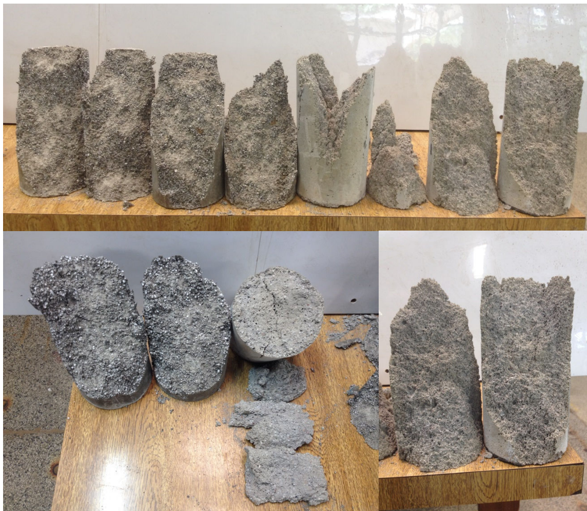
Figura III: Corpos de prova após o ensaio de ruptura à compressão
