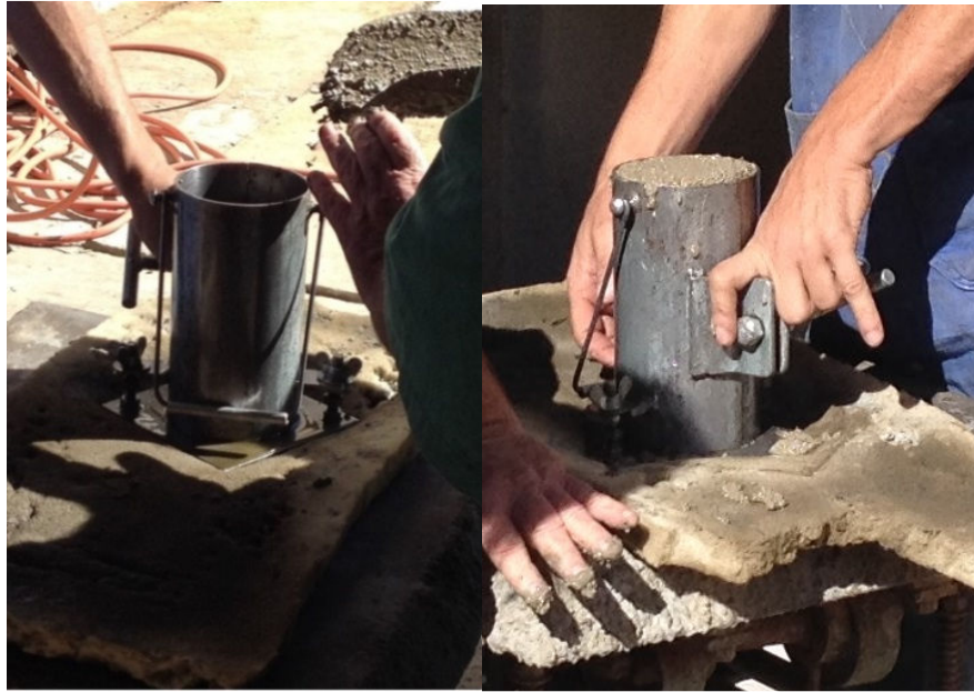
Figura 14: Moldagem dos corpos de prova com vibração mecânica – MESA VIBRATÓRIA
