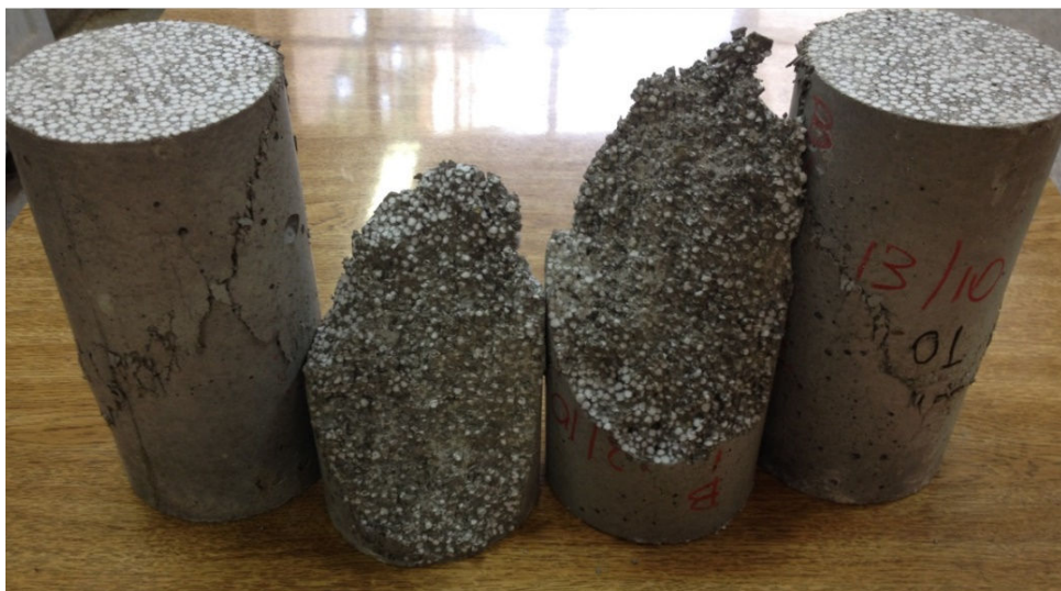
Figura 20: Corpos de prova retificados e rompidos por compressão axial
