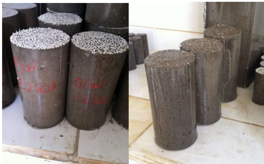
Figura 15: Cura dos corpos de prova com e sem retifica
