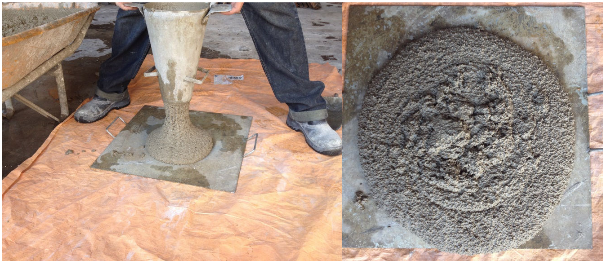
Figura 17: Ensaio de espalhamento do concreto
