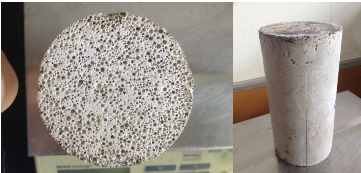
Figura II: Corpos de prova antes da ruptura por compressão
