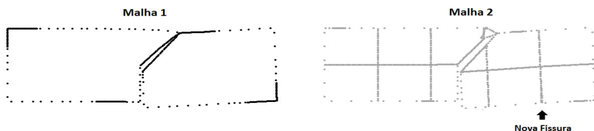
Figura 8.17 Configuração das composições deformadas com deslocamentos 100 vezes ampliados
