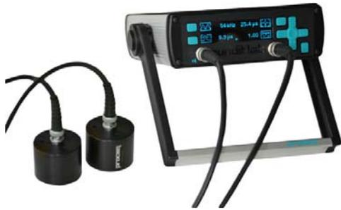
Figura 3.1 - Equipamento de ultrassom Pundit Lab<sup>+</sup>.
