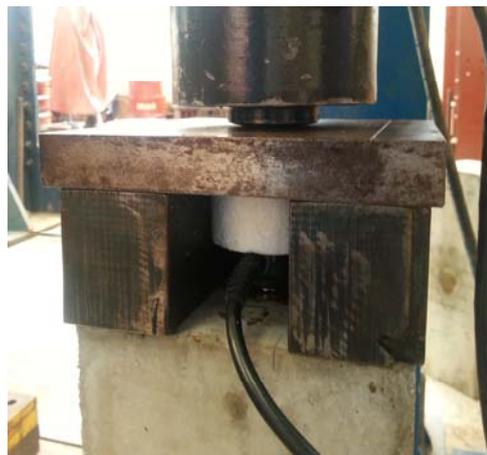
Figura 3.8 - Peça de isopor mantendo o transdutor fixo na face superior do prisma.
