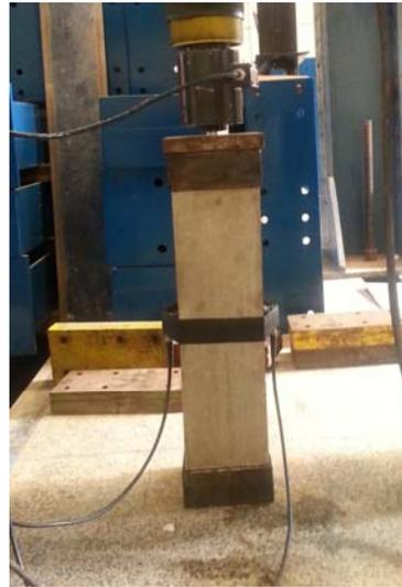
Figura 3.14 - Arranjo experimental da 2ª etapa do ensaio.
