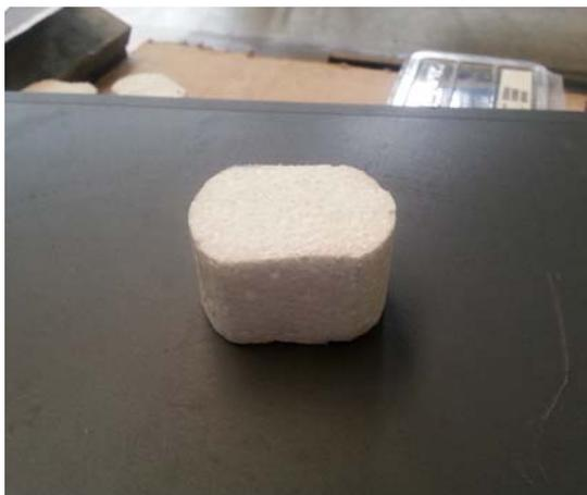
Figura 3.7 - Peça de isopor utilizada para fixar os transdutores na face superior e inferior do prisma.
