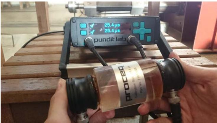
Figura 3.3 - Calibração do equipamento de ultrassom.
