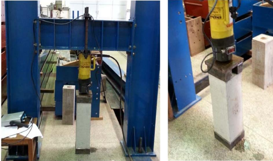
Figura 3.6 - Aparato experimental com o prisma de concreto.
