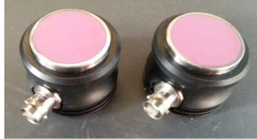
Figura 3.2 - Transdutores de cisalhamento com frequência de 250 kHz.
