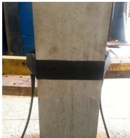
Figura 3.10 - Faixa de borracha utilizada para manter os transdutores fixos nas faces laterais do prisma.
