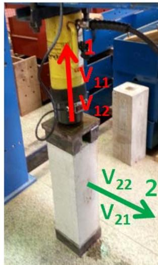
Figura 3.12 - Direções dos eixos 1 e 2 no prisma e velocidades das ondas emitidas em cada direção.
