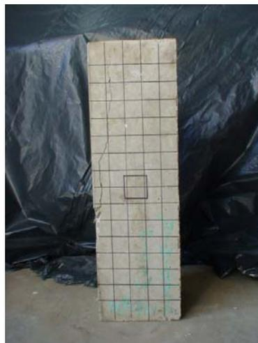
Figura 5.22 - Trincas no prisma 11 após o 1º ensaio.
