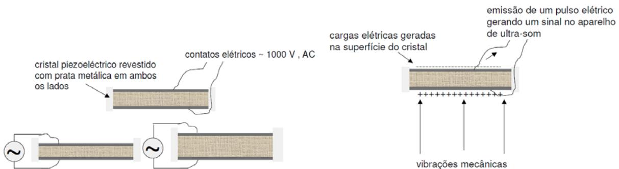
Figura 2.10 - Contração e expansão do cristal quando submetido à alta tensão alternada e emissão de pulsos elétricos pelo cristal quando submetido à vibrações mecânicas.
