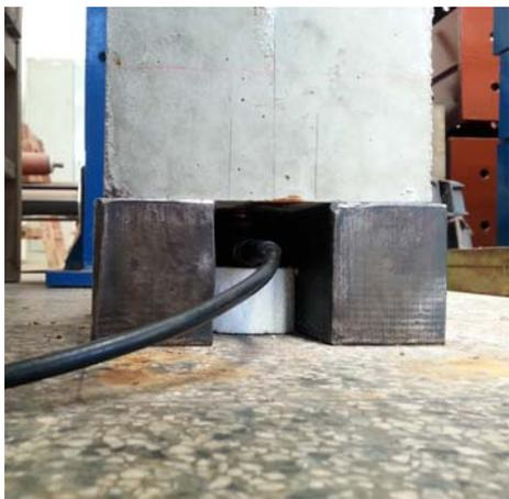
Figura 3.9 - Peça de isopor mantendo o transdutor fixo na face inferior do prisma.
