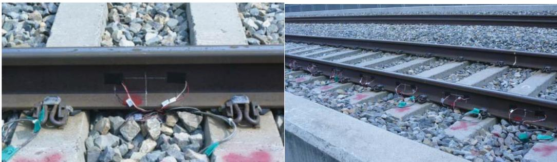
Figura 2-33 - Instrumentação dos trilhos para a medição de forças dinâmicas na via (CHOI, 2013)
