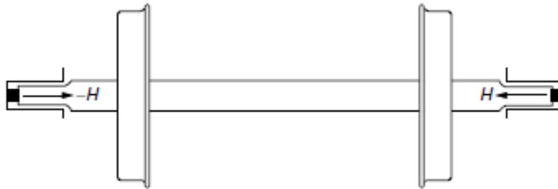
Figura 2-35 – Força lateral medida entre “journal axle” e a caixa de eixo (IWNICKI, 2006)
