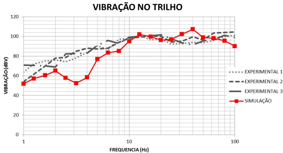
Figura 4-29 - Níveis de vibração no trilho em dBV das passagens na via e da simulação no trecho de laje sobre PADs
