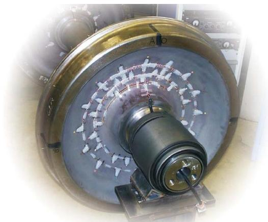
*Figura 2-34 – Exemplo de instrumentação de rodeiro 11*
