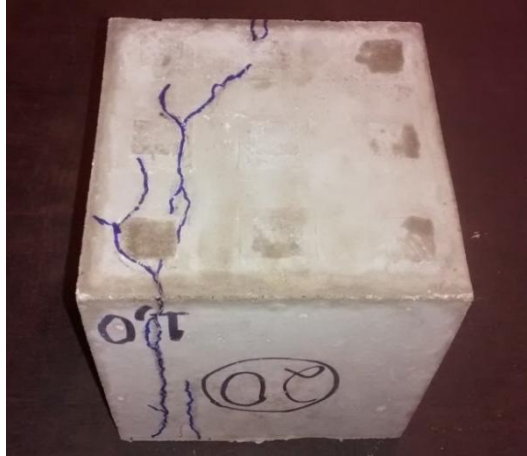
Figura 5.18 – Bloco fissurado após ensaio de compressão excêntrica
