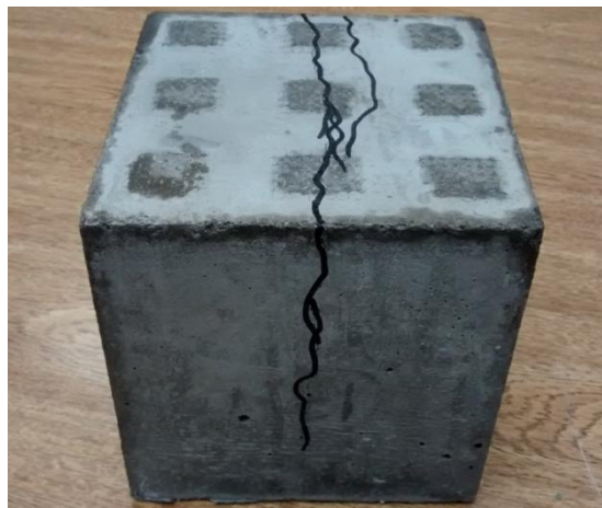
Figura 5.11 – Formação das fissuras no ensaio de ligação
