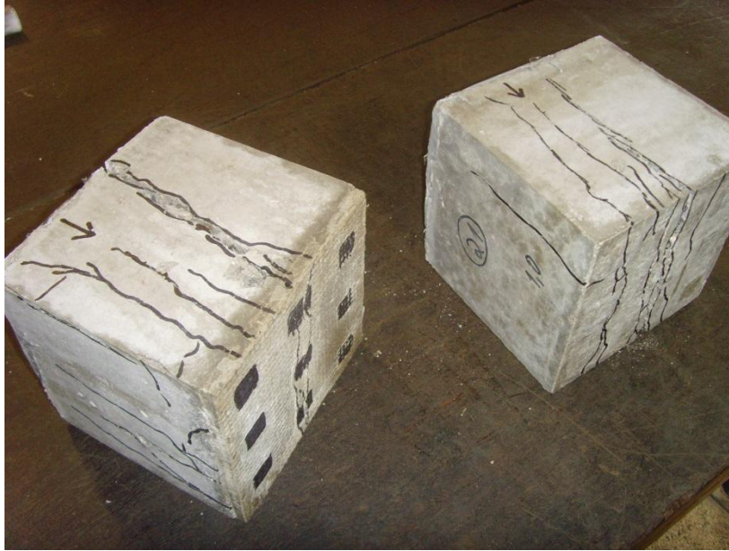
Figura 5.26 – Blocos de concreto com almofada aderida após ensaio de compressão excêntrica
