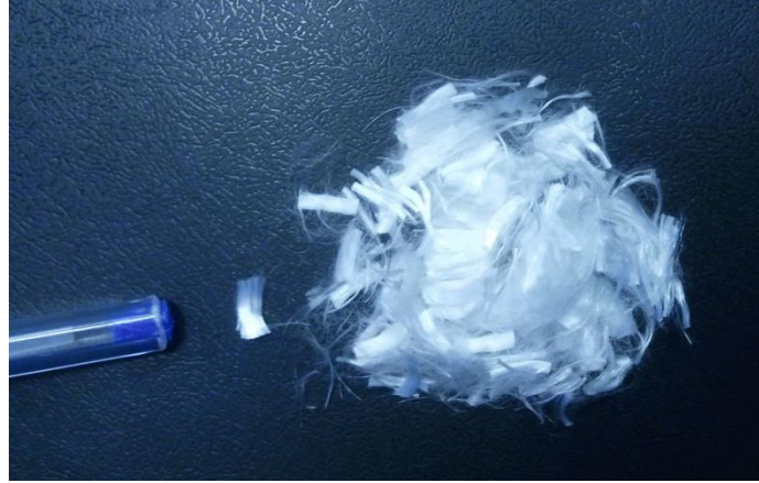
Figura 3.3 – Fibra de polipropileno utilizada na pesquisa (BRASILIT – Saint Gobain)
