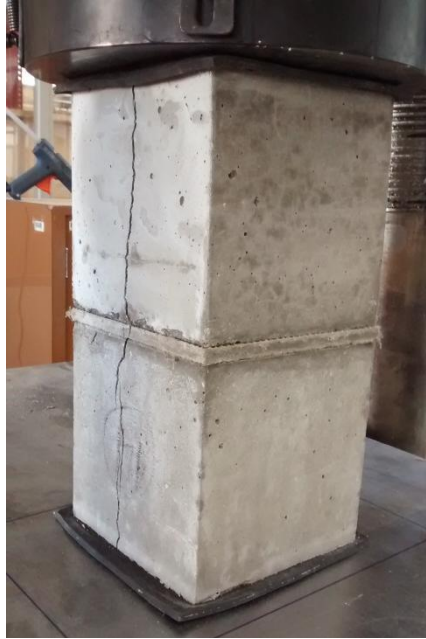
Figura 5.23 – Amostra de ensaio de ligação após ensaio cíclico de compressão
