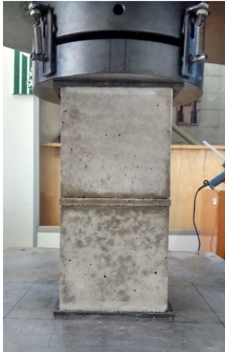
Figura 4.18 – Ensaio cíclico com almofada de apoio e rugosidade de 1 mm de espessura
