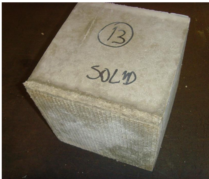
Figura 5.24 – Bloco de concreto com almofada aderida
