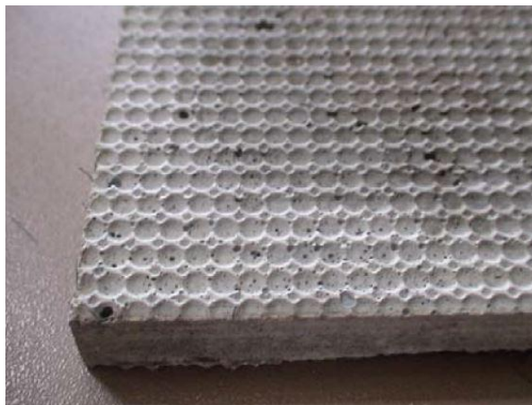
Figura 2.20 – Almofada de argamassa com rugosidade superficial (BELLUCIO, 2010)
