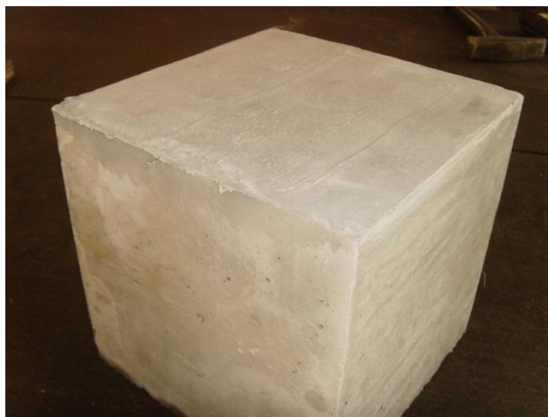
Figura 4.11 – Bloco com superfície superior regularizada com massa plástica
