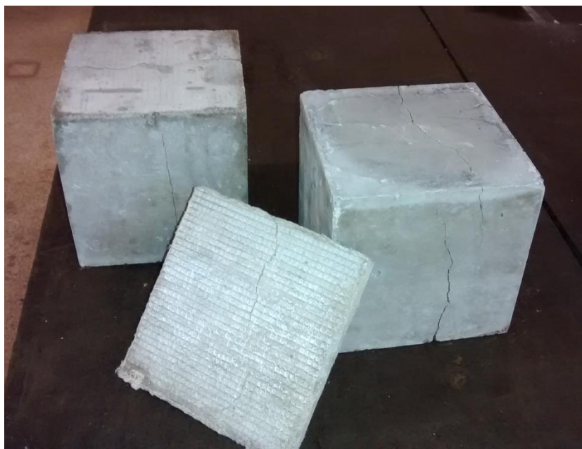
Figura 5.9 – Exemplo de modelo de ligação após ensaio de compressão centrada
