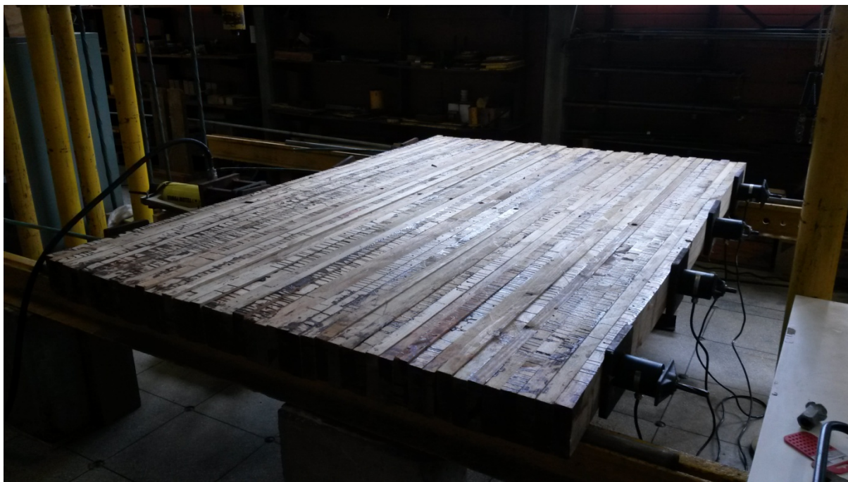
Figura 62 - Configuração final do tabuleiro após a protensão.
