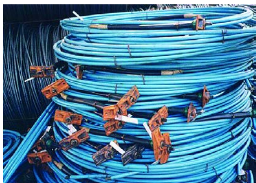
Figura 114 - Estoque correto de cabos. Fonte: VASCONCELOS (2013).
