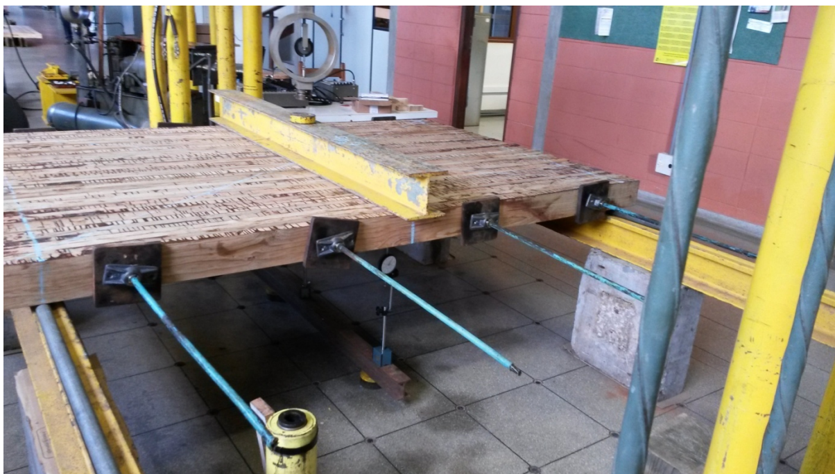
Figura 64 - Ensaio para determinação do módulo de elasticidade longitudinal.
