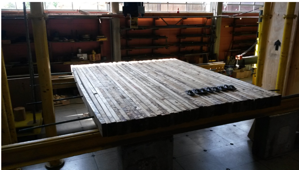
Figura 52 - Tabuleiro montado, sem protensão.
