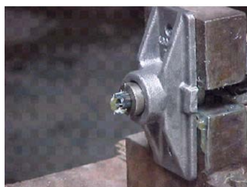
Figura 108 - Armadura passiva fixada. Fonte: VASCONCELOS (2013).
