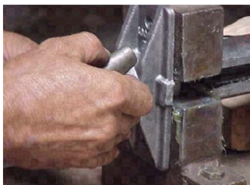
Figura 107 - Colocação manual das cunhas. Fonte: VASCONCELOS (2013).
