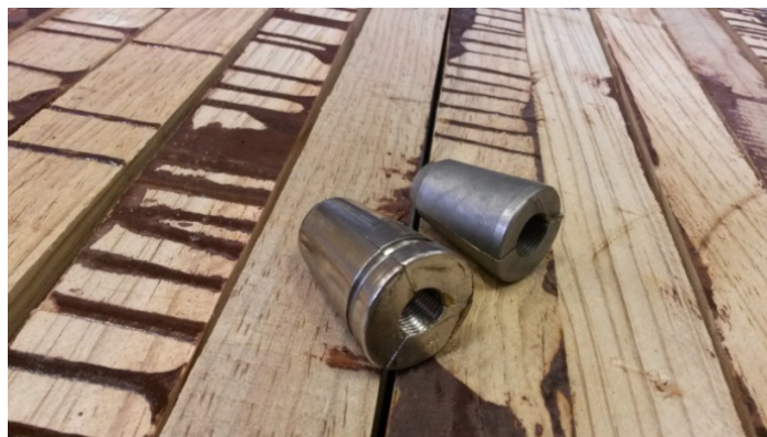
Figura 96 - Cunhas, à esquerda tripartida especial para reprotensão e à direita cunha bipartida comum. Fonte: O AUTOR (2014).
