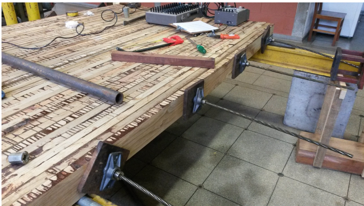
Figura 95 - Ancoragens ativas. Fonte: O AUTOR (2014).
