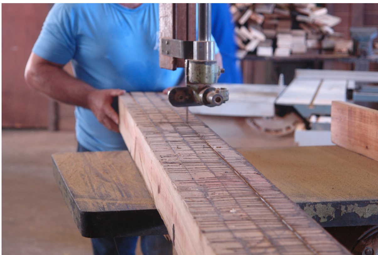
Figura 50 - Corte das lâminas do tabuleiro laminado colado.
