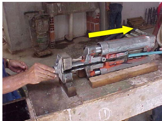
Figura 106 - Puxada para fixação da cunha. Fonte: VASCONCELOS (2013).
