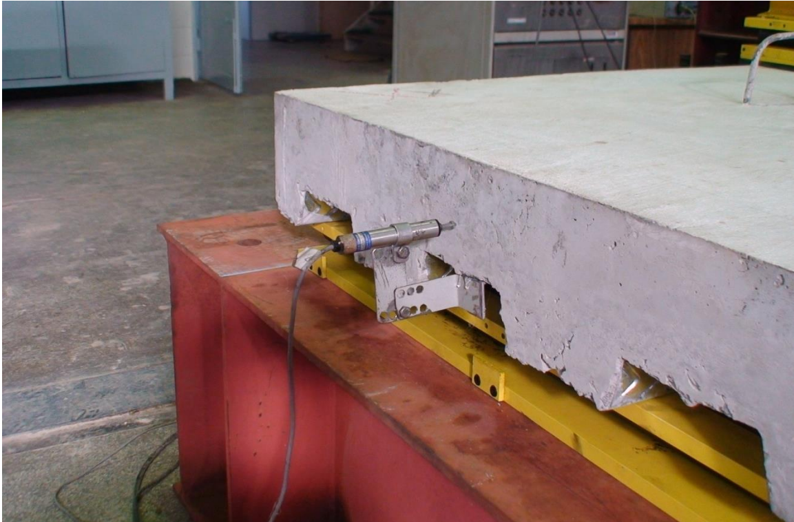
Foto A.7 – Transdutor para medição do deslizamento relativo na extremidade
