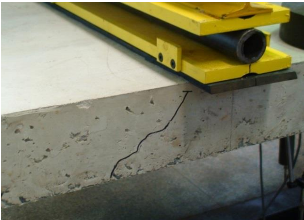
Figura 6.2 – Aspecto da fissura na região da força aplicada, após o deslizamento
