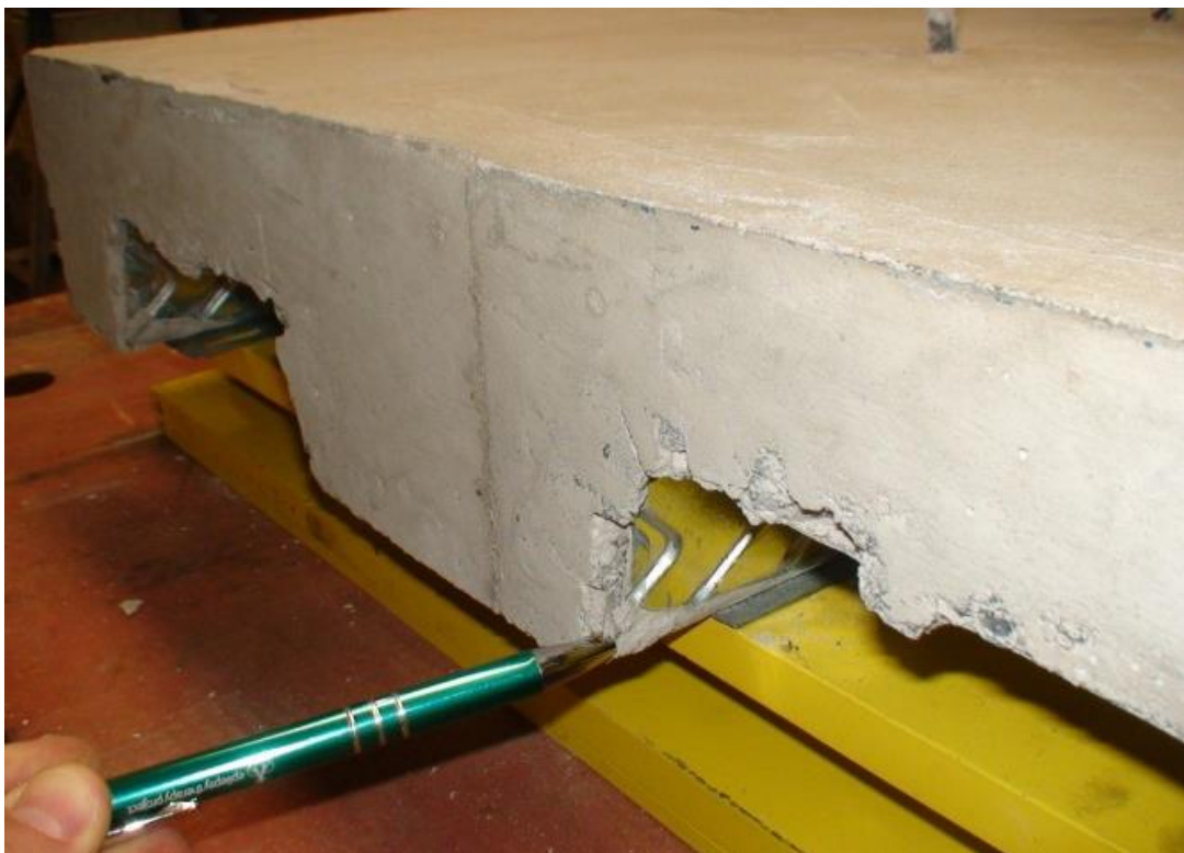
Foto A.12 – Deslizamento relativo entre o concreto e a fôrma de aço na extremidade
