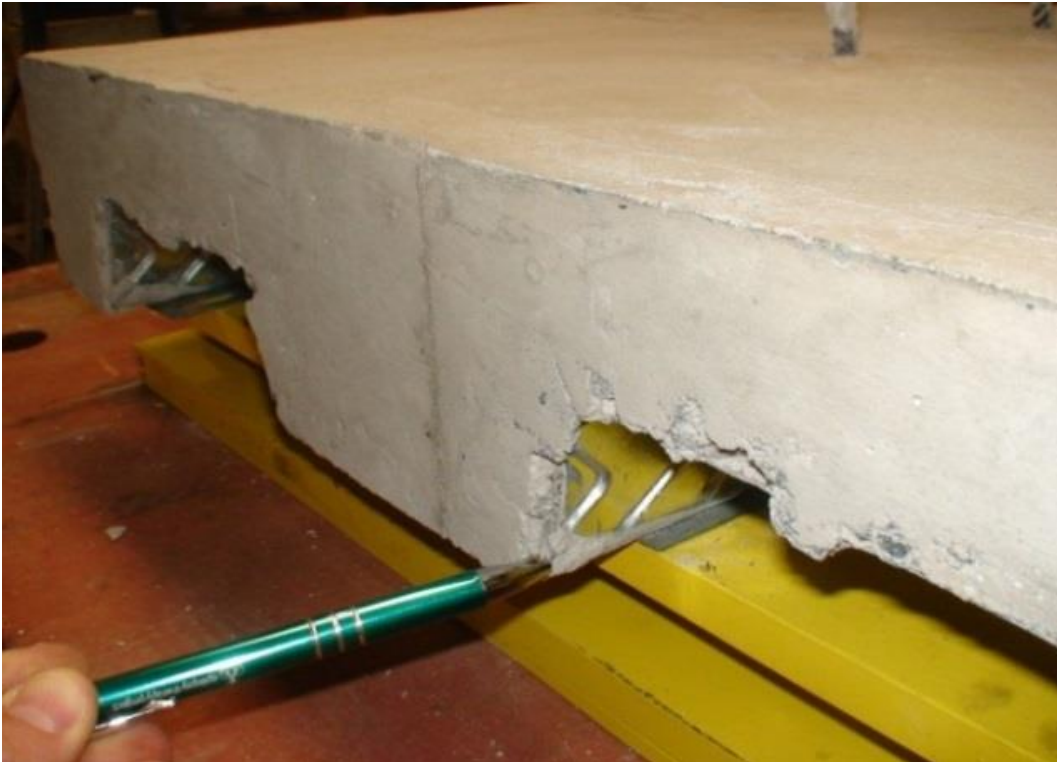
Figura 6.1 – Deslizamento relativo entre o concreto e o aço na extremidade
