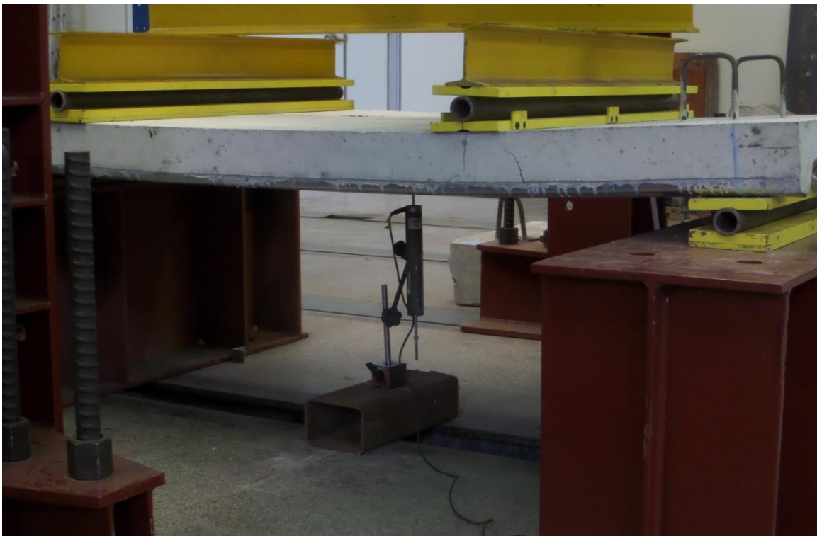
Foto A.8 – Transdutor para medição do deslocamento vertical a meio vão (flecha)
