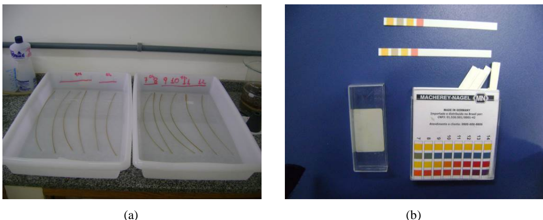
Figura 4.17 – a) Fibras de arumã imersas na solução de NaOH e (b) Fitas de medição de pH.
