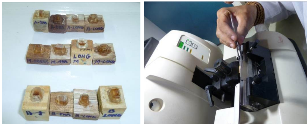
Figura 4.12 – (a) Fixação das amostras em base de madeira; (b) Cortes em micrótomo.
