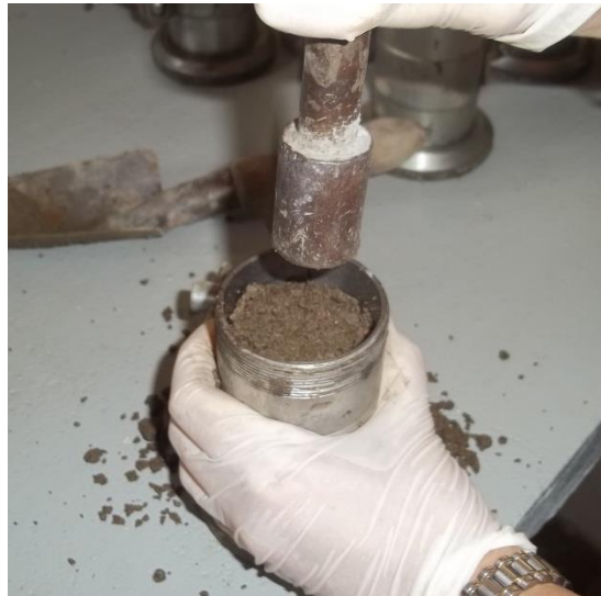
Figura 4.16 – Compactação de 20 golpes em quatro camadas (Fonte: autor)
