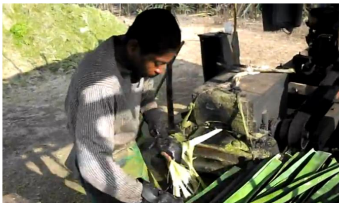
Figura 4.5 – Desfibramento do sisal (Fonte: http://www.veengle.com/s/desfibradora/3.html )
