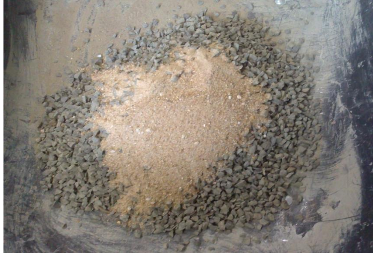
Figura 4.12 – Misturas do pedrisco e da areia em diversas proporções (Fonte: autor)
