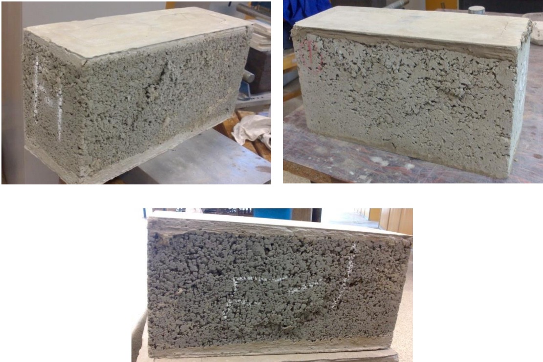
Figura 6.7 – Ruptura dos blocos com adição de fibra (Fonte: autor)
