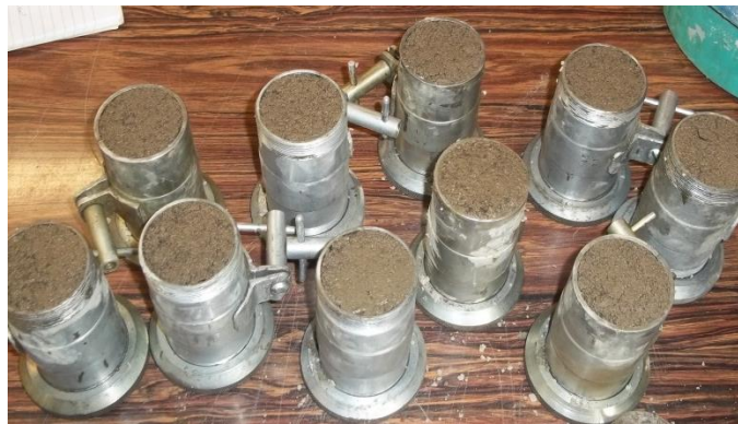
Figura 4.14 – Moldagem de corpos de prova cilíndricos (5 cm x 10 cm) (Fonte: autor)
