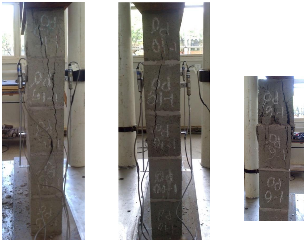
Figura 6.17 – Fissuras verticais ao longo dos septos laterais (Fonte: autor)
