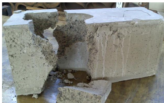
Figura 6.6 – Ruptura frágil dos blocos sem adição de fibra (Fonte: autor)
