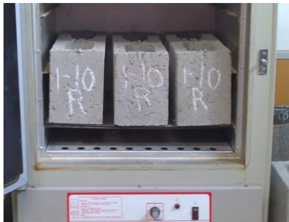
Figura 4.23 – Blocos sendo secados na estufa (Fonte: autor)
