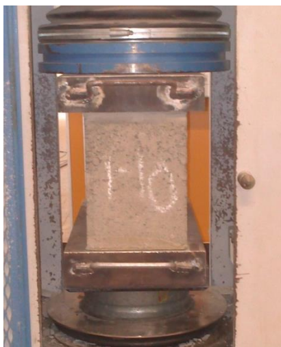
Figura 4.29 – Ensaio de resistência a compressão do bloco (Fonte: autor)
