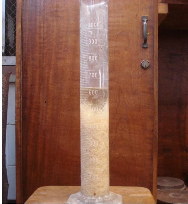
Figura 4.7 – Ensaio da fibra no frasco de 1,000 ml (Fonte: autor)
