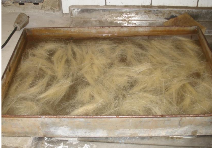
Figura 4.9 – Fibras de sisal imersas em água (Fonte: autor)
