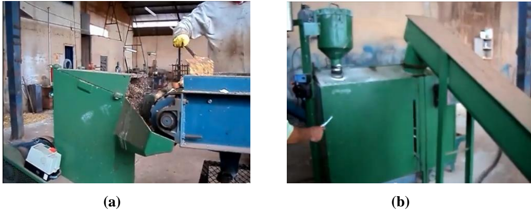
Figura 4.2 – Etapa intermediária: (a) trituração do resíduo orgânico e (b) transporte até a câmara de reação química (Fonte: Gold Press Máquinas e Reciclagem)
