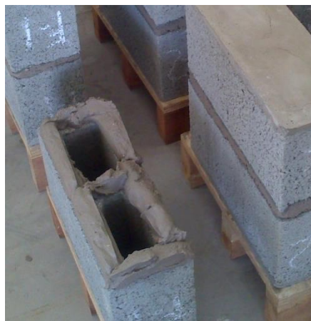
Figura 4.30 – Disposição dos cordões de argamassa nos prismas (Fonte: autor)
