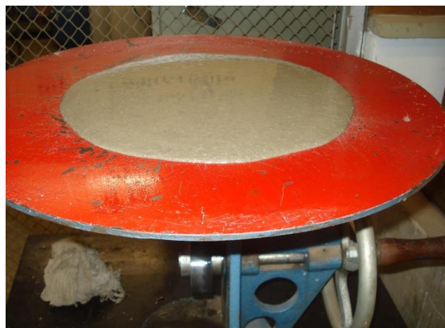
Figura 4.26 – Ensaio de consistência da argamassa (Fonte: autor)
