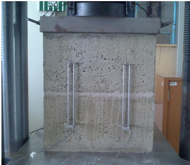
Figura 4.31 – Ensaio de resistência à compressão dos prismas (Fonte: autor)
