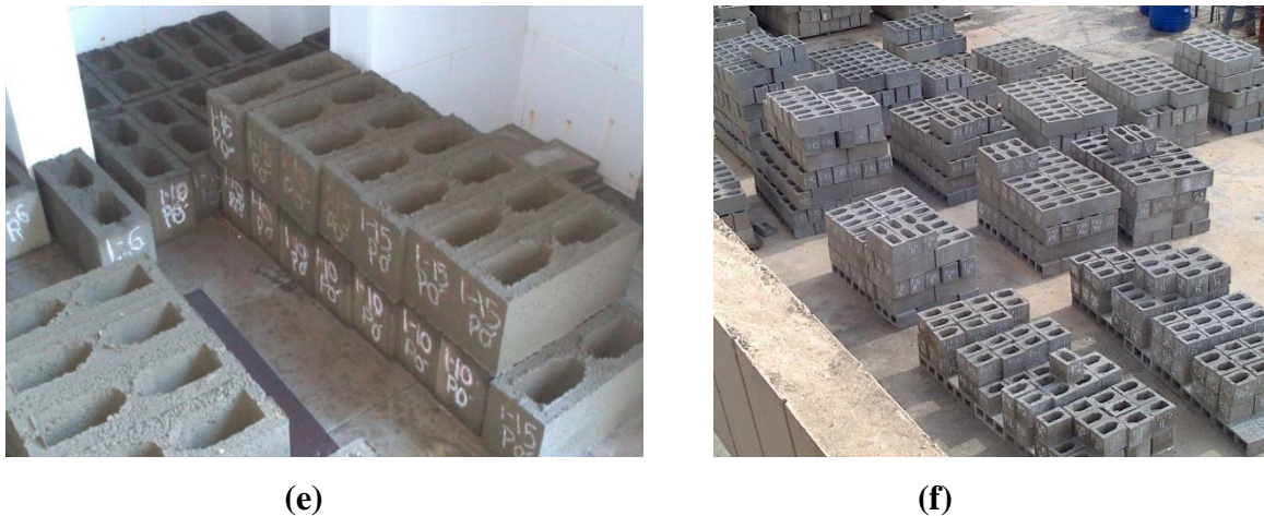
Figura 4.20 – Sequência na execução dos blocos estruturais: (a) concreto despejado no carrinho de mão, (b) retirada do excesso de concreto com o uso de um rastelo, (c) hastes metálicas comprimindo e compactando a massa no interior da fôrma, (d) descida do braço da máquina para a elevação da caixa da matriz e retirada dos blocos, (e) cura dos blocos na câmara úmida e (f) blocos estocados no pátio do laboratório até a data dos ensaios (Fonte: autor)
