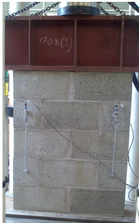
Figura 4.33 – Ensaio de resistência à compressão das pequenas paredes (Fonte: autor)
