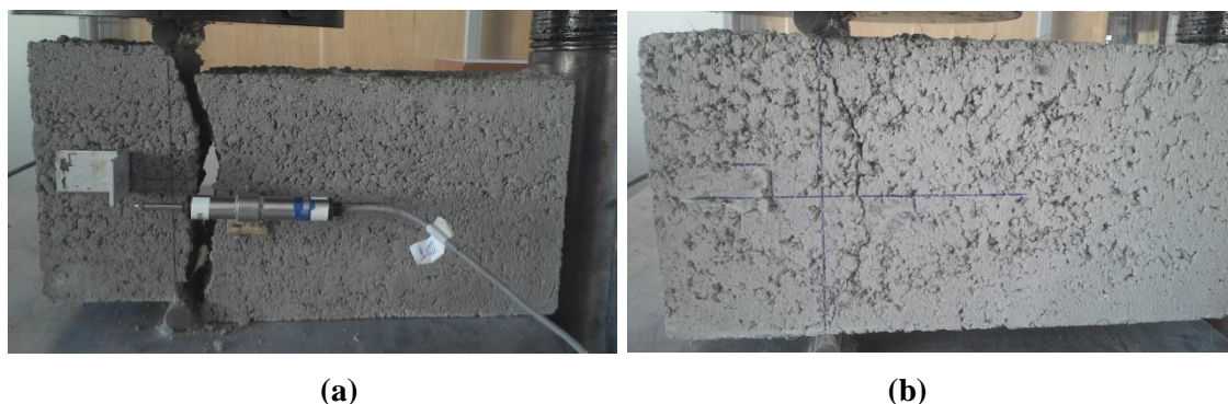
Figura 6.22 – Ruptura dos blocos no ensaio de resistência à tração indireta: (a) ruptura frágil dos blocos sem adição de fibras e (b) ruptura dúctil dos blocos com adição de fibras (Fonte: autor)
