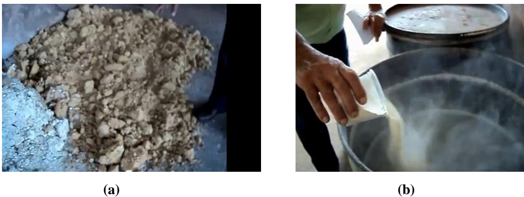
Figura 4.3 – Etapa final: (a) massa retirada do reator e (b) produto transformado em pó (Fonte: Gold Press Máquinas e Reciclagem)
