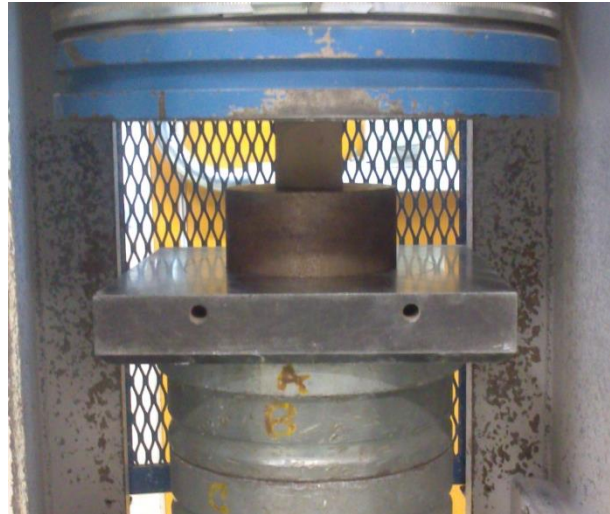
Figura 4.28 – Ensaio de resistência a compressão da argamassa (Fonte: autor)
