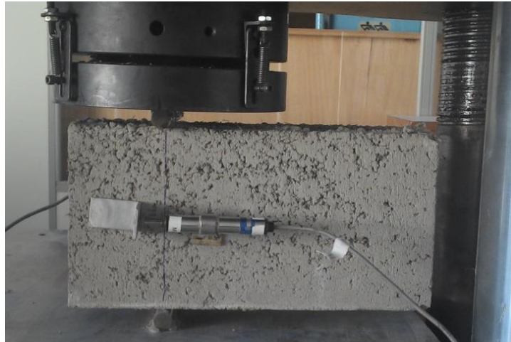
Figura 4.37 – Ensaio de resistência à tração indireta dos blocos (Fonte: autor)
