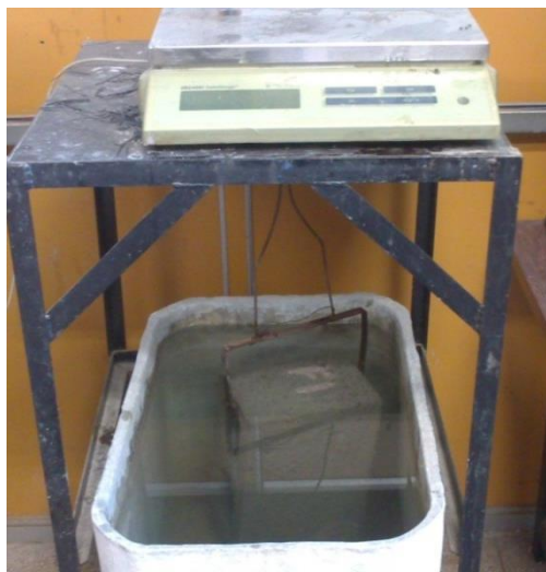
Figura 4.25 – Massa dos blocos determinada por meio da balança hidrostática (Fonte: autor)
