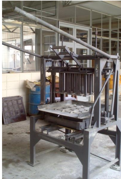
Figura 4.19 – Vibroprensa Makipen utilizada para a fabricação dos blocos no laboratório (Fonte: autor)
