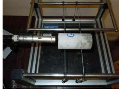
Figura 5.2 – Ensaio de corpo de prova 5 cm x 10 cm no Sonelastic®.
