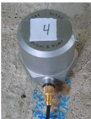
Figura 4.20 – Detalhe de um dos quatro acelerômetros utilizados.
