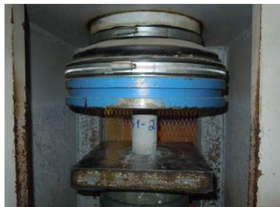
Figura 5.14 – Ensaio de corpo de prova de 5 cm x 10 cm na prensa ELE<sup>®</sup>.
