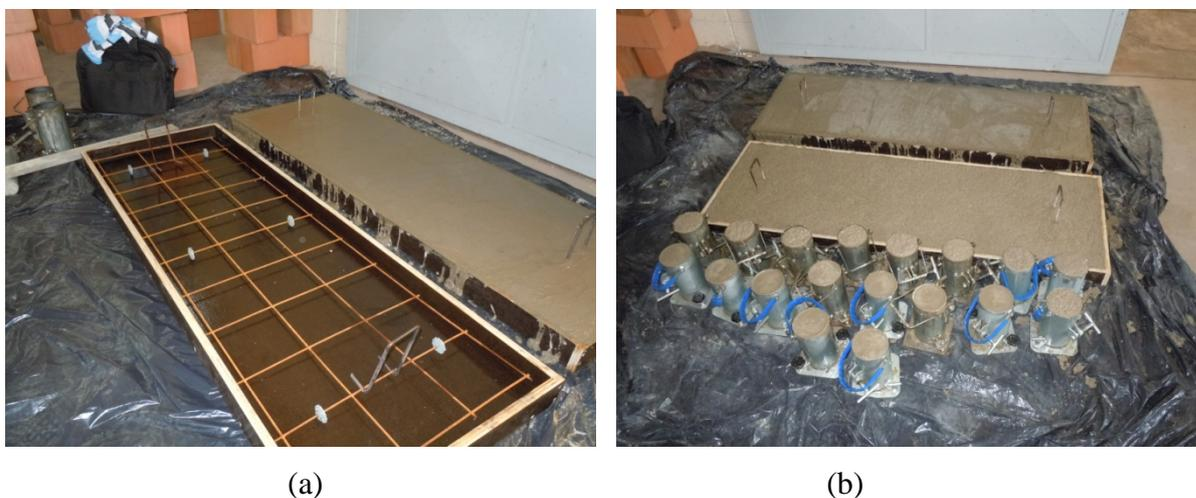
Figura 7.1 – Detalhe da forma (a) e das lajes concretadas, junto com os corpos de prova (b).
