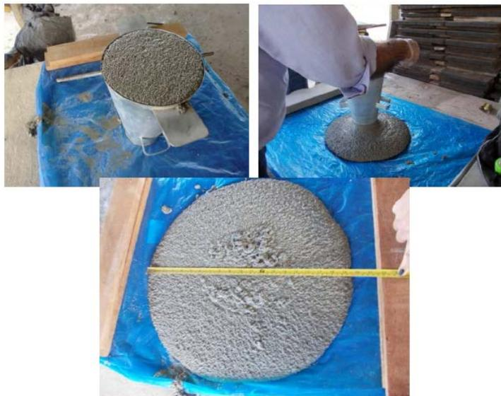
Figura 3.4 – Ensaio típico de espalhamento do CLEPE.
