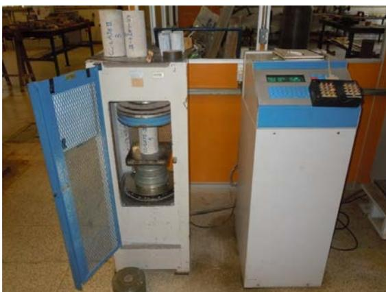
Figura 5.13 – Ensaio de corpo de prova de 10 cm x 20 cm na prensa ELE<sup>®</sup>.
