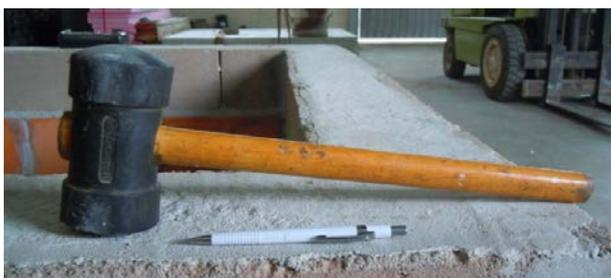
Figura 4.21 – Martelo de borracha utilizado como excitador de impacto.
