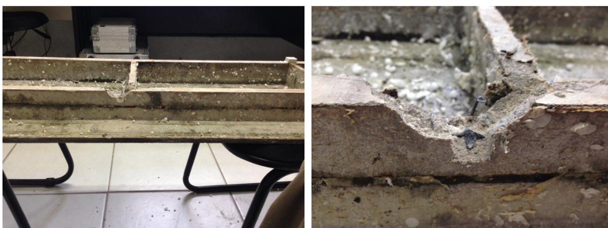
Figura 68 – Fotografias do furo do Modelo 2D2MV
