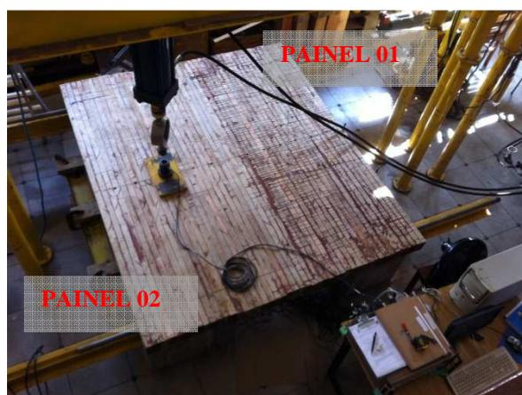
Figura 47 – Tabuleiro de ponte de MLC formado por 2 painéis de 1,00m x 2,30m .
