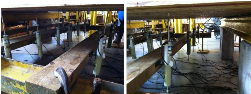
Figura 50 – Transdutores de deslocamento sob o tabuleiro.
