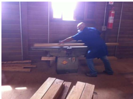
Figura 36 – Preparação das peças para colagem.
