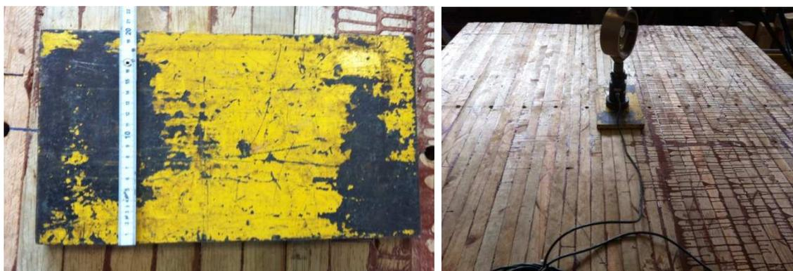
Figura 48 – Placa metálica para simular aplicação de carga de roda.
