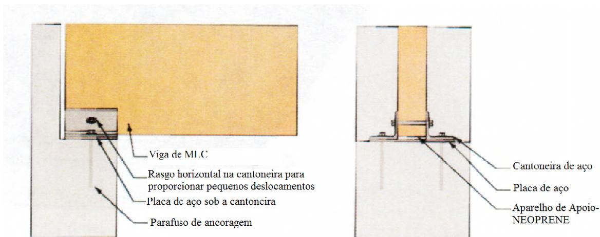
Figura 8 – Detalhes do aparelho de apoio entre a Viga de MLC e Apoio de Concreto
