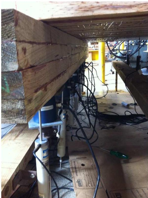
Figura 58 – Instrumentação sobre tabuleiro com viga de enrijecimento de 4 lamelas.
