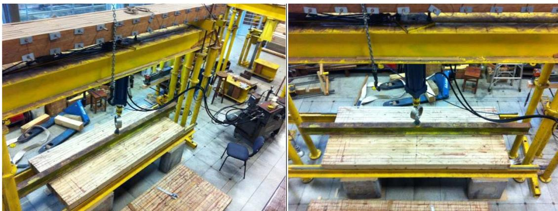
Figura 44 – Ensaio de flexão transversal do painel.
