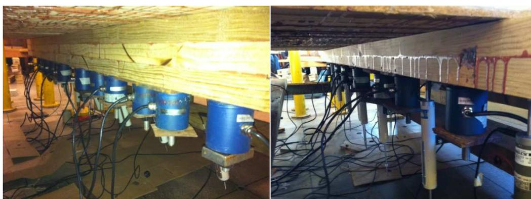
Figura 51 – Células de carga interligadas aos parafusos.
