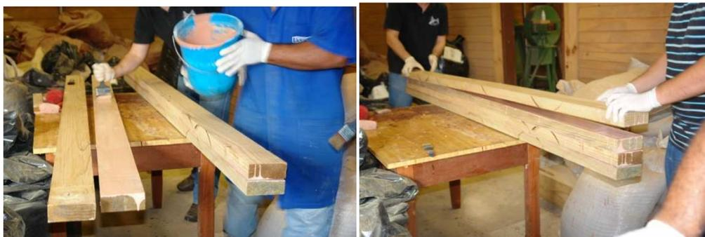
Figura 38 – Colagem e montagem das vigas de MLC.
