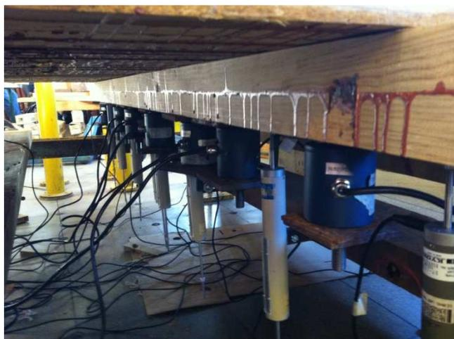
Figura 56 – Instrumentação sobre tabuleiro com viga de enrijecimento de 2 lamelas.
