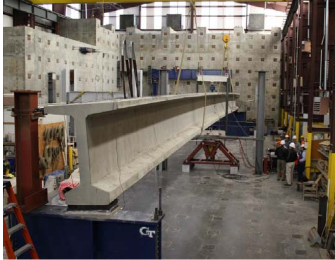
Figura 2-21 – Viga PCI BT-54 ensaiada em situação transitória
