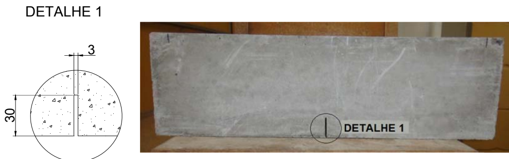
Figura 4.13 – Detalhe do entalhe no corpo de prova (Unidades em mm)
