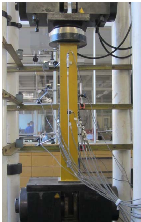
Figura 4.4 – Esquema de ensaio dos modelos de pilares mistos submetidos a força axial
