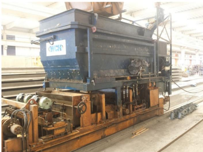
Figura 2.7 – Máquina de fôrma deslizante para fabricação das lajes alveolares
