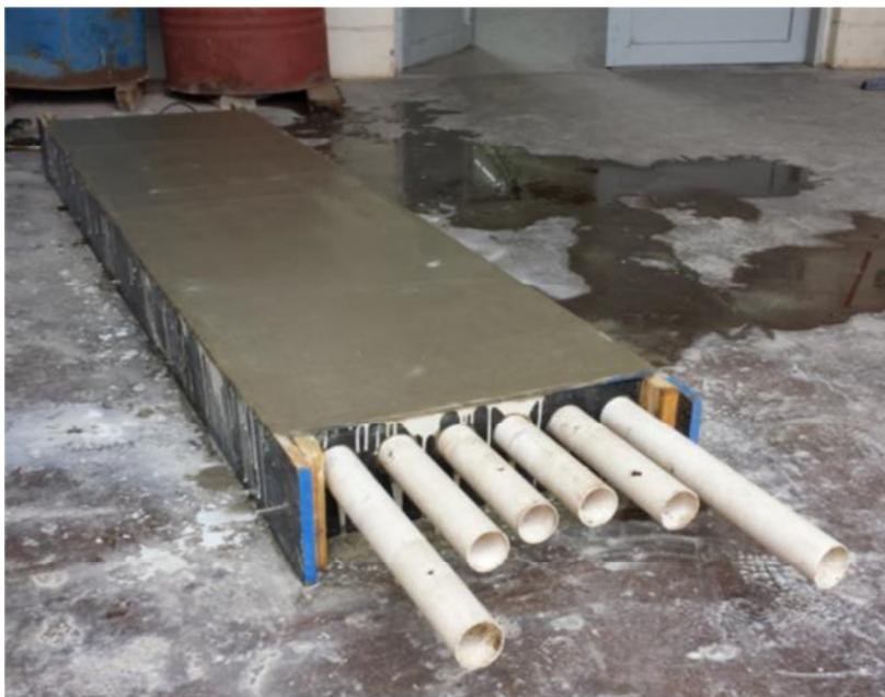
Figura 5.13 – Umas das lajes alveolares após concretagem
