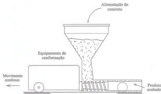
Figura 2.6 – Esquema de uma máquina extrusora típica
