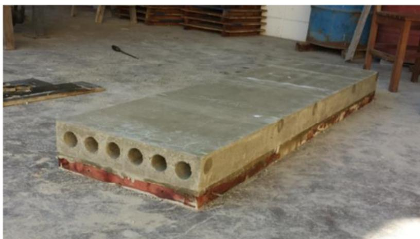
Figura 5.14 – Umas das lajes alveolares após retirada da fôrma
