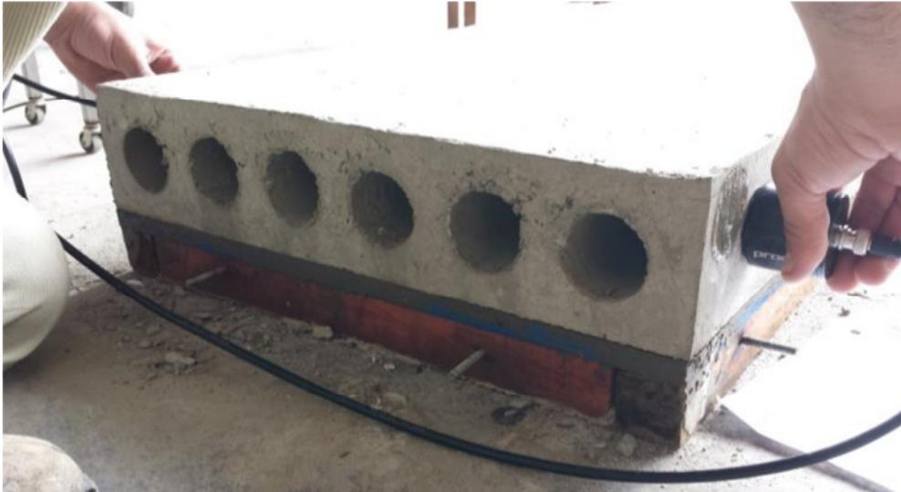
Figura 5.17 – Ensaio de ultrassom na seção 5
