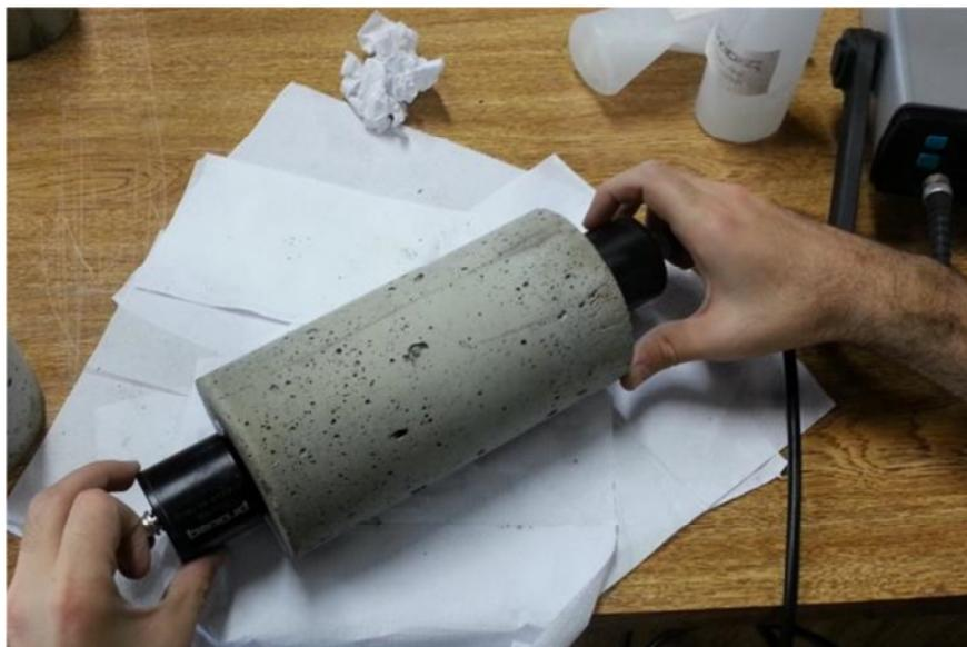
Figura 5.8 – Ensaio de ultrassom em um dos CPs
