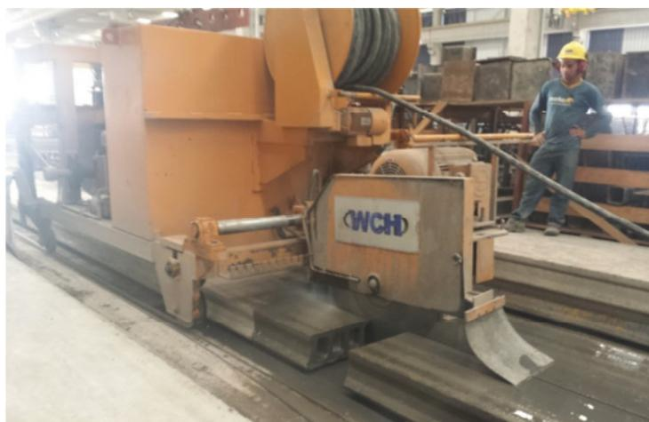
Figura 2.13 – Corte longitudinal em uma laje alveolar
