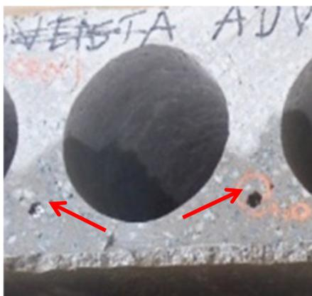
a) Traço com pouca água; perda da aderência entre o concreto e as cordoalhas;
