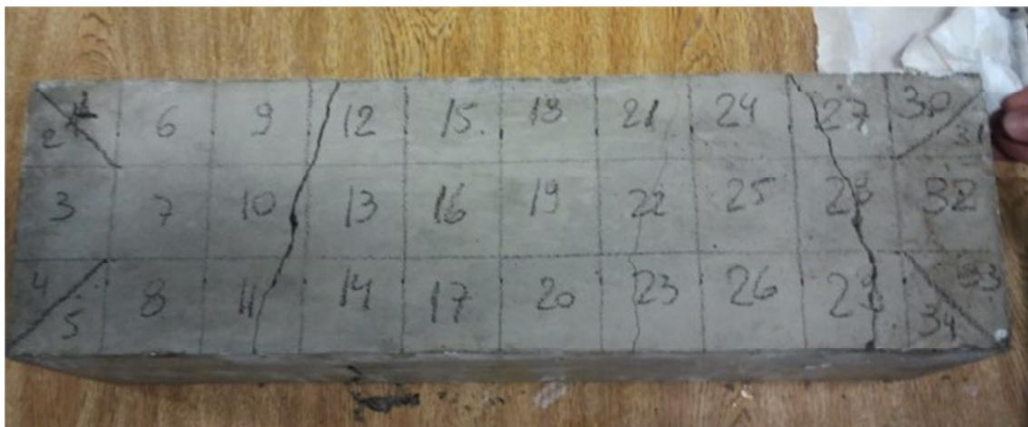
Figura B.5 – Prisma danificado
