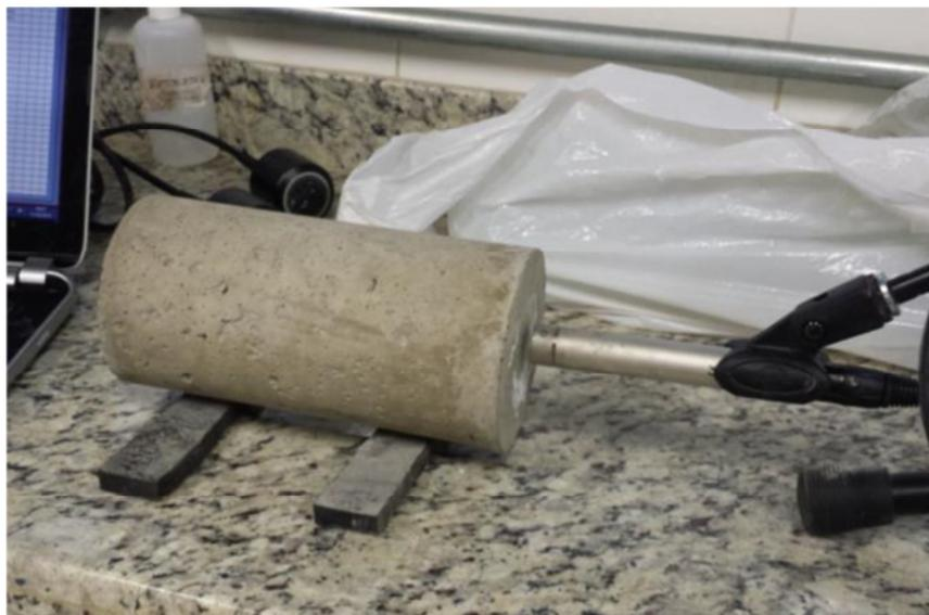
Figura 5.22 - Ensaio com o Sonelastic® em uma das amostras
