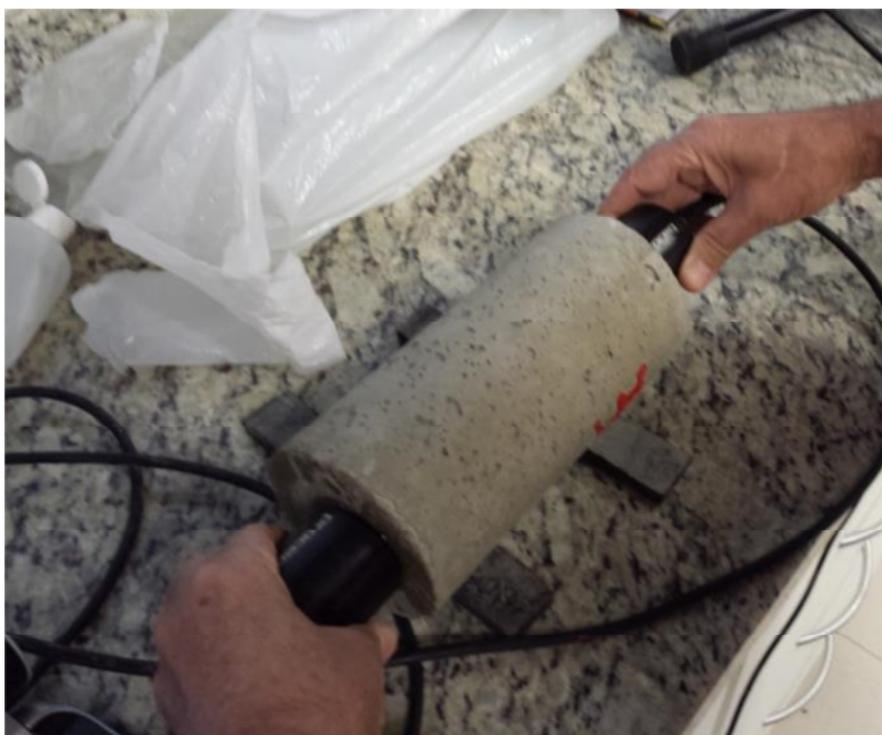
Figura 5.23 – Ensaio de ultrassom em uma das amostras
