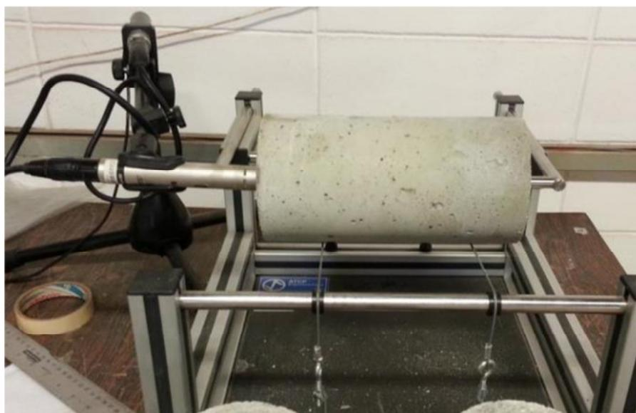
Figura 5.9 – Ensaio de vibração utilizando o Sonelastic® em um dos CPs
