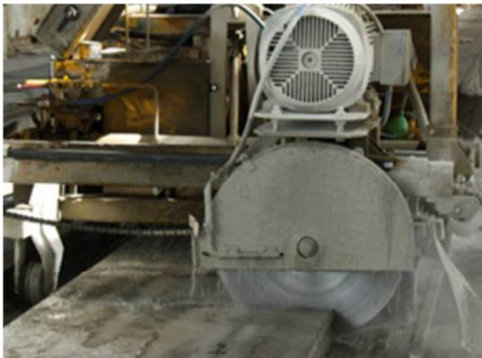
Figura 2.14 – Corte transversal em uma laje alveolar
