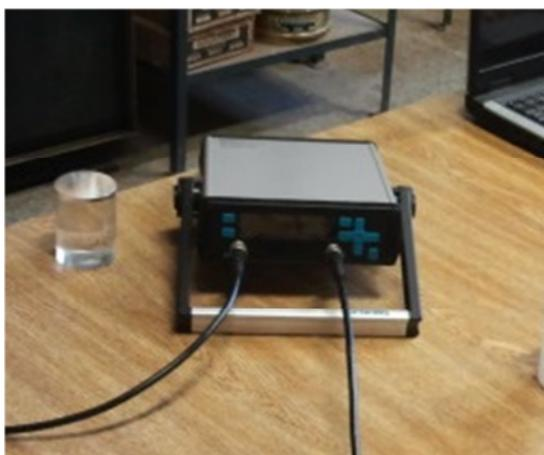
Figura B.1 – Equipamento de ultrassom PUNDIT utilizado no ensaio
