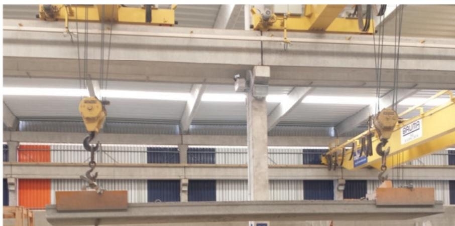
Figura 2.15 – Içamento de uma laje alveolar com balancim
