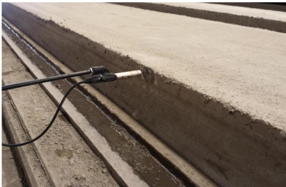
Figura 5.21 – Detalhe do microfone posicionado próximo à laje alveolar no ensaio com o Sonelastic®
