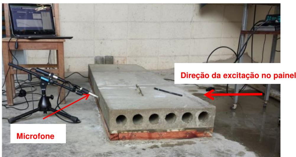
Figura 5.16 – Ensaio de vibração na seção 2 utilizando o Sonelastic®
