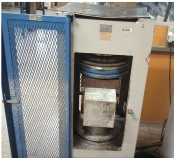
Figura B.4 – Prisma de concreto na prensa
