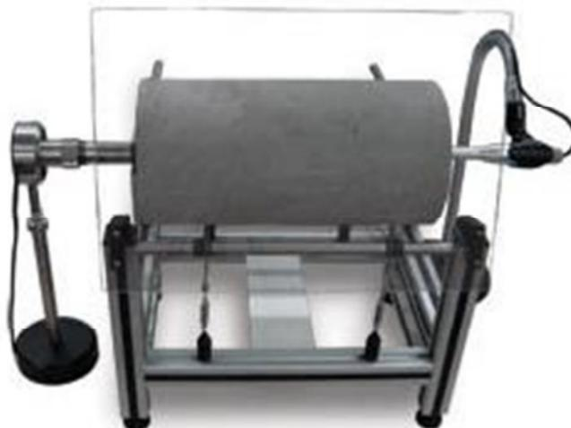
Figura 4.18 – Corpo-de-prova ensaiado no Soneslastic®
