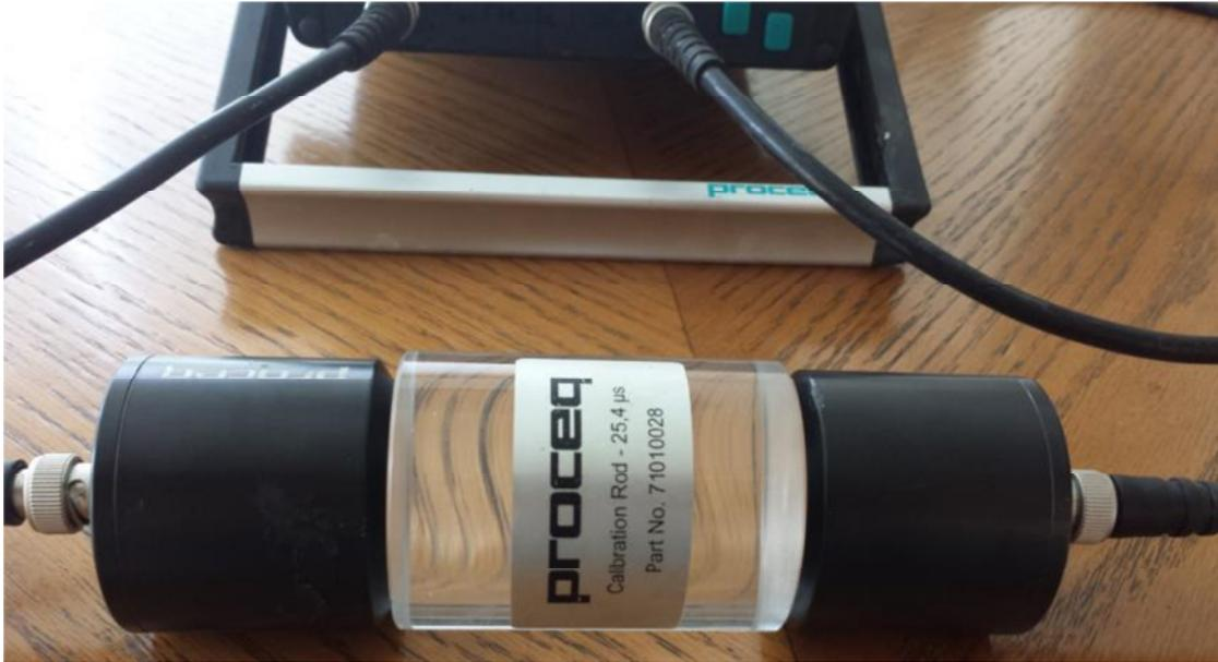
Figura 5.4 – Cilindro de calibração para aferição do equipamento
