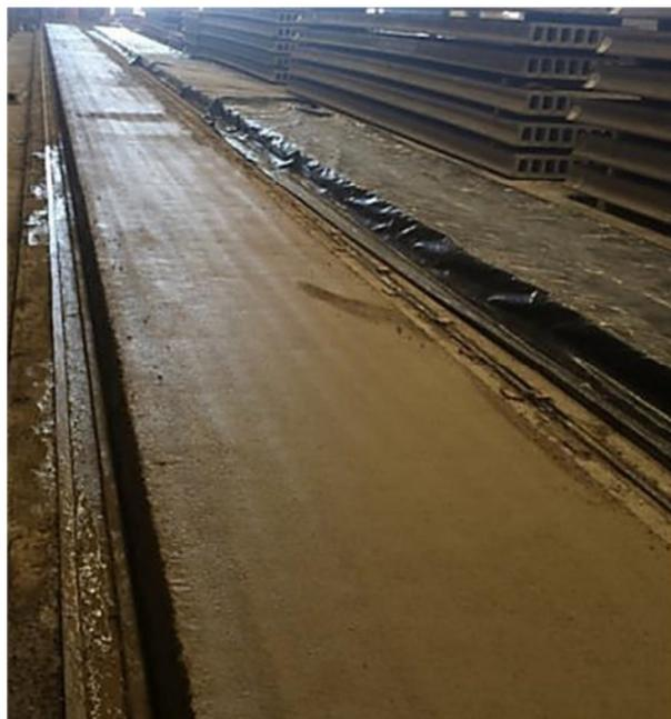
Figura 5.18 – Laje alveolar recém concretada na pista de produção com moldadeira
