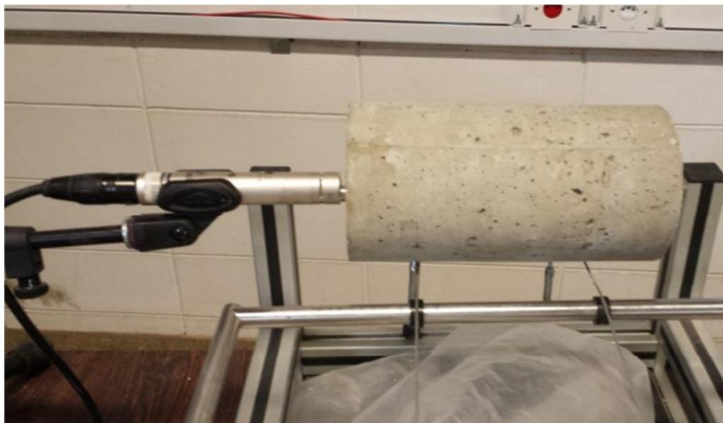
Figura 5.5 – Montagem do ensaio utilizando o Sonelastic®
