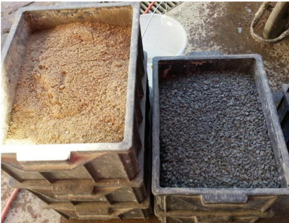
Figura 5.1 – Areia e pedrisco, agregado miúdo e graúdo, respectivamente, utilizados nas concretagens
