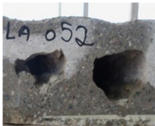
b) Muita água; deformação dos alvéolos e aumento do peso próprio da laje;
