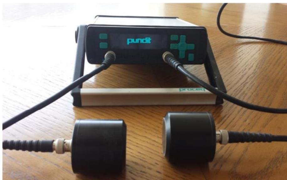
Figura 5.3 – Equipamento de ultrassom PUNDIT LAB, da marca Proceq utilizado nos ensaios
