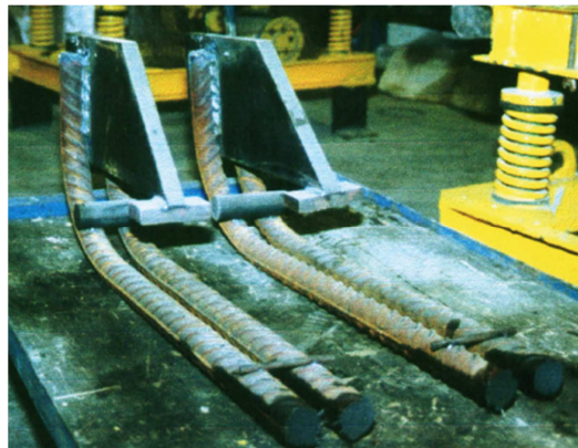
Figura 2.25 – Placa de aço embutida na viga pré-moldada utilizada na ligação com o pilar [GORGUN (1997)].
