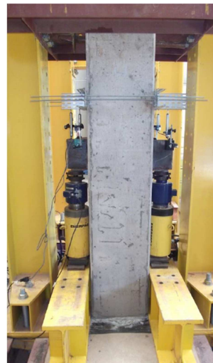
c) Aplicação do atuador no consolo metálico de baixo para cima
