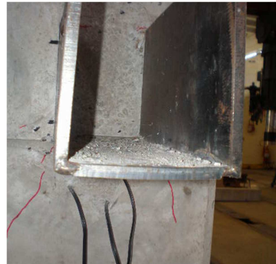
b) Fissuras na face inferior do consolo metálico
