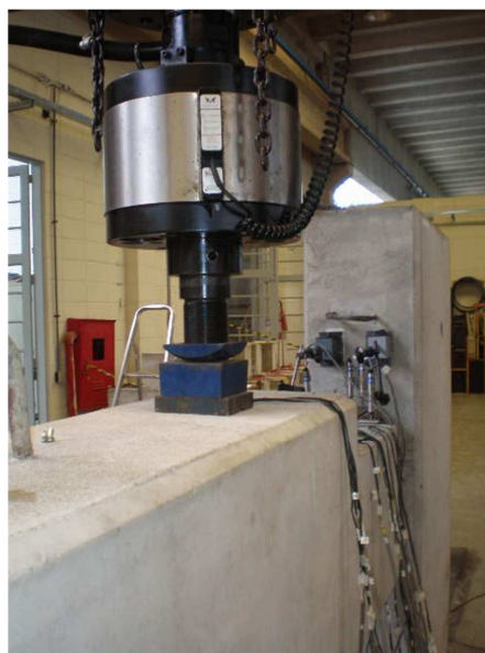
Figura 3.45 – Vista do modelo para ensaio do dente-7,5.
