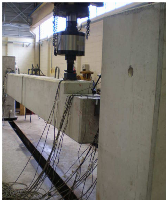
Figura 3.47 – Vista do modelo para ensaio do consolo-7,5.
