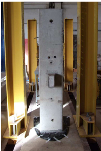
b) Modelo do pilar isolado a ser ensaiado
