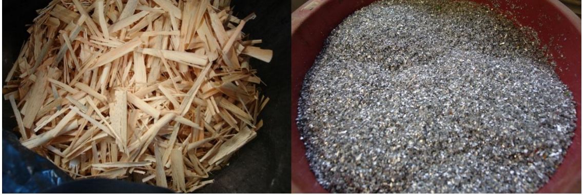
Figura 17: partículas de madeira e BOPP, respectivamente, geradas para a produção dos painéis.
