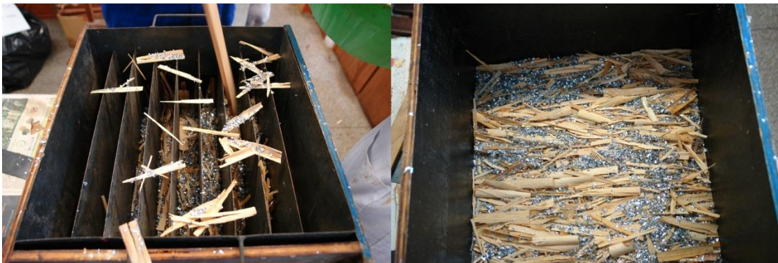
Figura 19: Orientação das partículas com a ajuda de um orientador de partículas e o colchão final formado.
