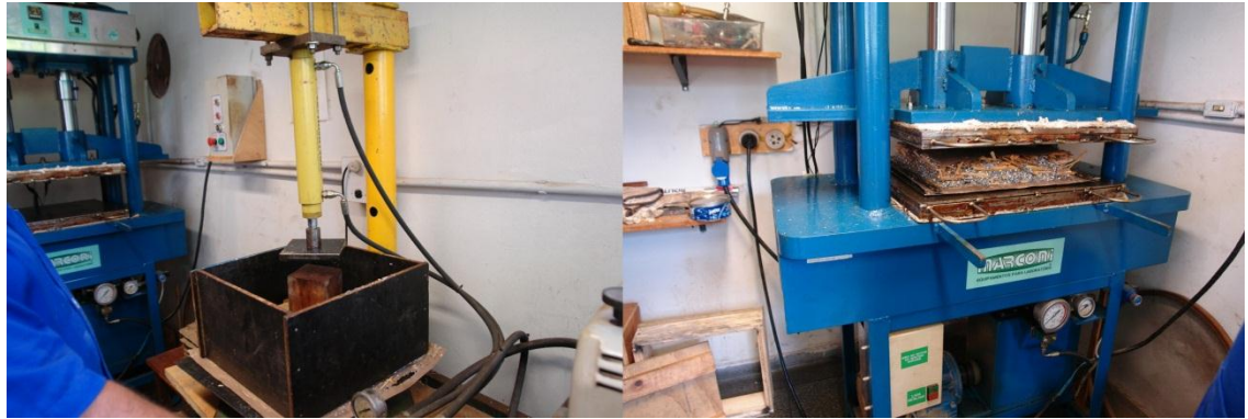
Figura 20: pré-prensagem e prensagem final do painel.
