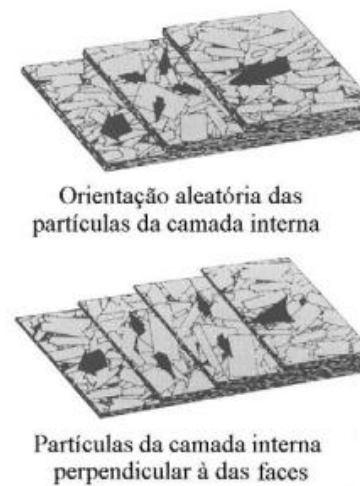
Figura 2: Orientação das partículas “strands” na matriz constituinte do painel OSB (ORIENTED, 1998).
