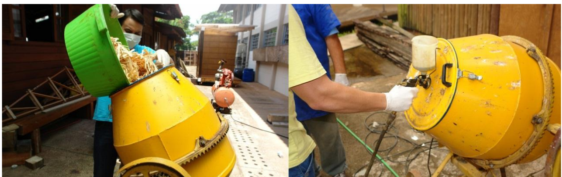
Figura 18: Encolagem das partículas e pulverização da resina.
