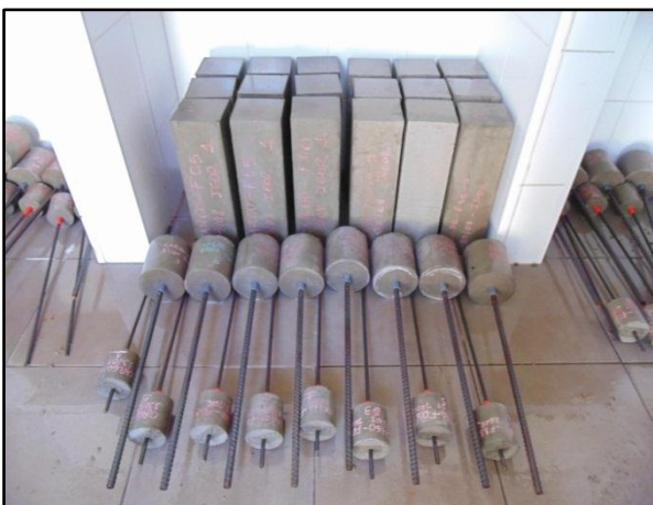
Figura 5.31 - Armazenamento dos corpos-de-prova em câmara úmida.
