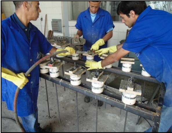
Figura 5.29 - Moldagem e adensamento dos corpos-de-prova.
