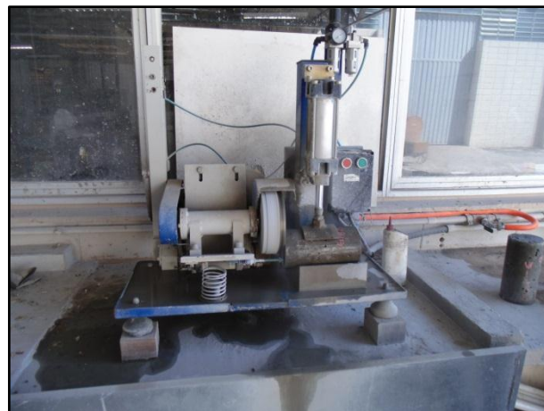
Figura 5.13 - Retificação dos corpos-de-prova.
