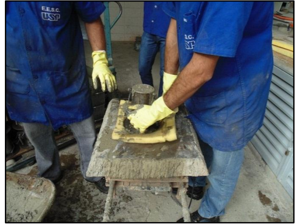
Figura 5.11 - Adensamento dos corpos-de-prova em mesa vibratória.
