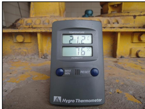
Figura 5.10 - Relógio medidor de temperatura e umidade relativa.
