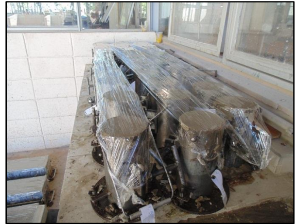
Figura 5.12 - Envolvimento dos corpos-de-prova por filme plástico.
