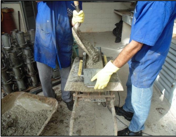
Figura 5.11 - Adensamento dos corpos-de-prova em mesa vibratória.
