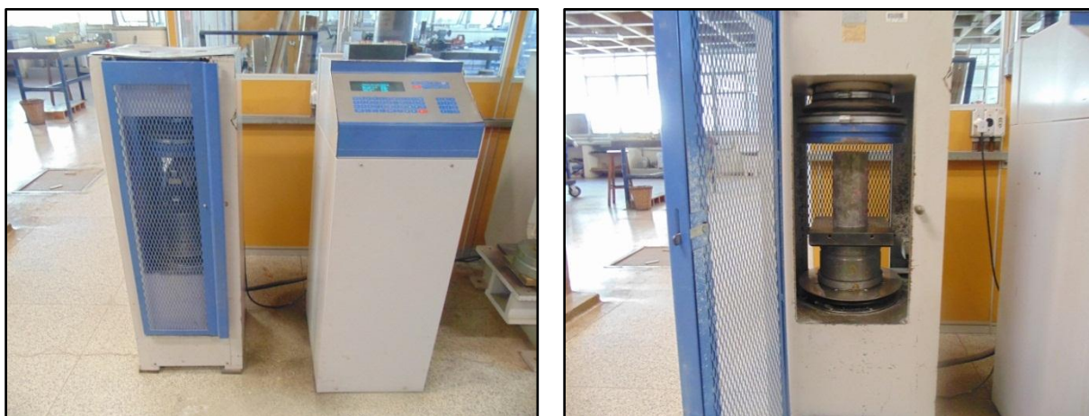
Figura 5.14 - Ensaio de resistência à compressão.
