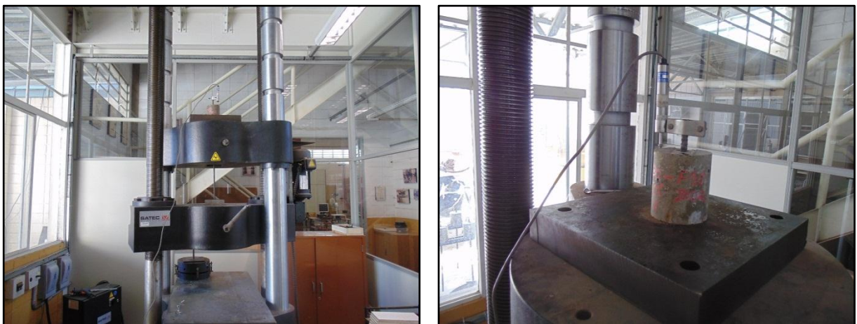
Figura 5.32 - Aparato para realização dos ensaios de arrancamento.
