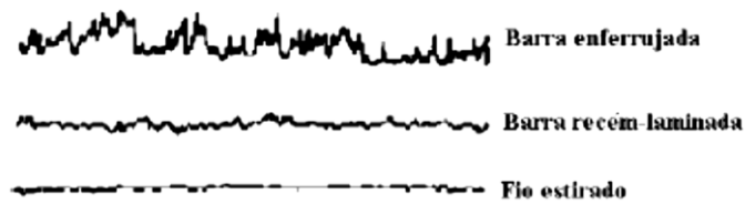
Figura 2.04 - Rugosidade superficial de barras e fios lisos (LEONHARDT & MÖNNIG, 1977).
