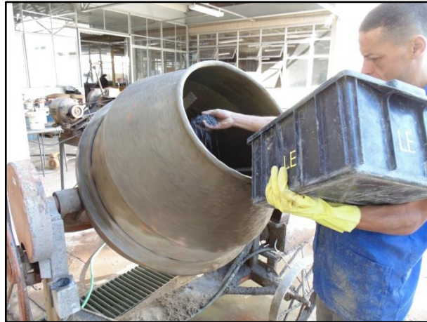
Figura 5.08 - Modelo de betoneira e inserção das fibras metálicas.
