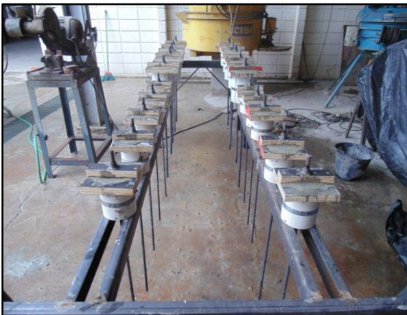
Figura 5.30 - Acabamento e proteção dos corpos-de-prova.
