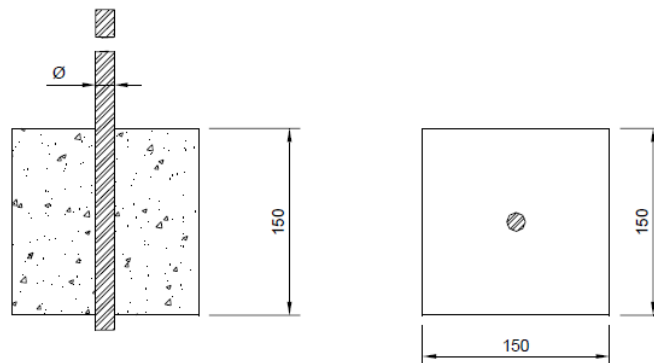
Figura 2.20 - Prisma para ensaio de arrancamento com barra vertical (ASTM C-234, 1991).
