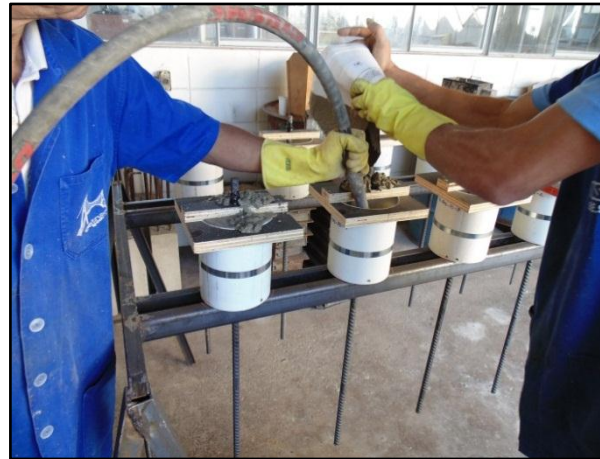
Figura 5.29 - Moldagem e adensamento dos corpos-de-prova.
