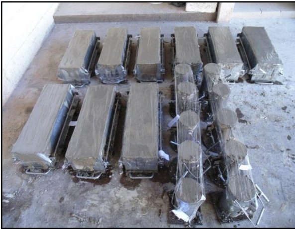
Figura 5.12 - Envolvimento dos corpos-de-prova por filme plástico.
