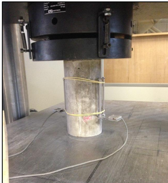
Figura 5.16 - Ensaio de módulo de elasticidade estático.
