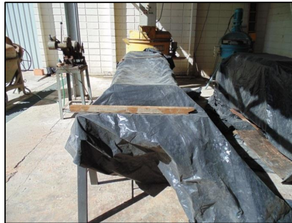
Figura 5.30 - Acabamento e proteção dos corpos-de-prova.
