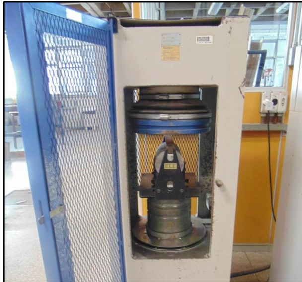
Figura 5.15 - Ensaio de resistência à tração por compressão diametral.
