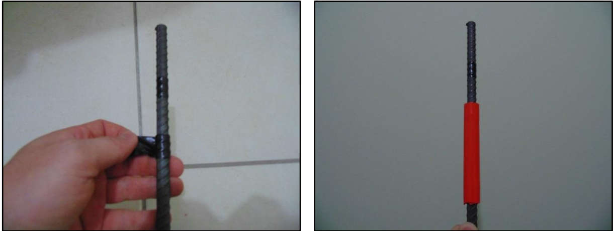
Figura 5.23 - Definição do trecho não aderente da barra.
