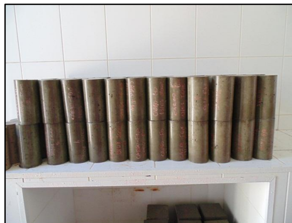
Figura 5.31 - Armazenamento dos corpos-de-prova em câmara úmida.
