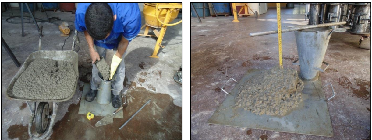
Figura 5.09 - Ensaio do abatimento do tronco de cone ( Slump Test ).
