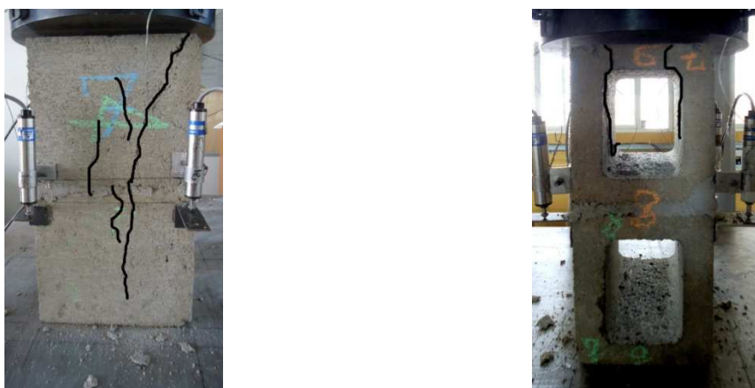
Figura 3.17 – Modo de ruptura para o ensaio da junta horizontal.
