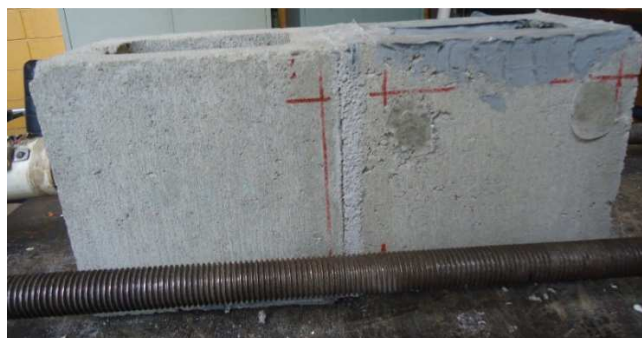
Figura 3.23 – Imagem do caso onde uma a junta rompeu antecipadamente.
