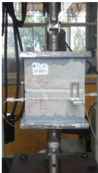
Figura 2.14 – Ensaio de tração direta (MATA, 2011)
