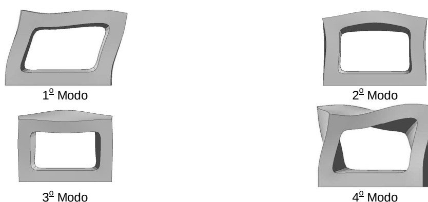
Figura 4.10 – Modos de vibração o meio bloco.
