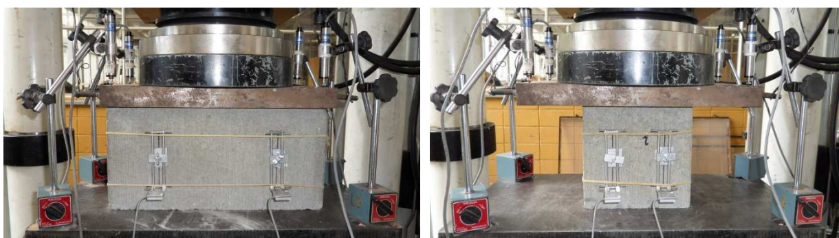
Figura 3.2 – Ensaio de resistência à compressão dos blocos e meios blocos de concreto.
