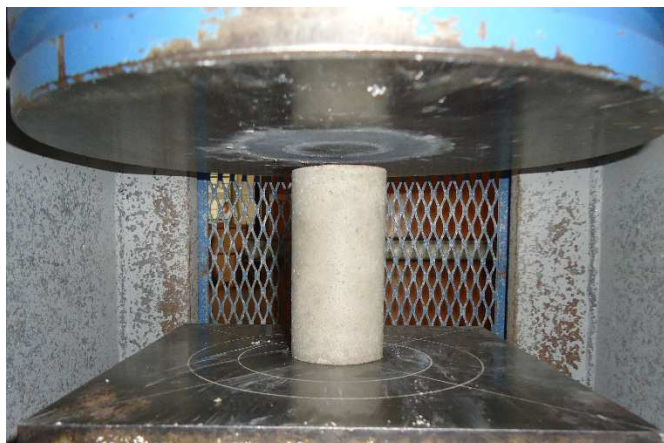
Figura 3.8 – Ensaio de resistência a compressão da argamassa.
