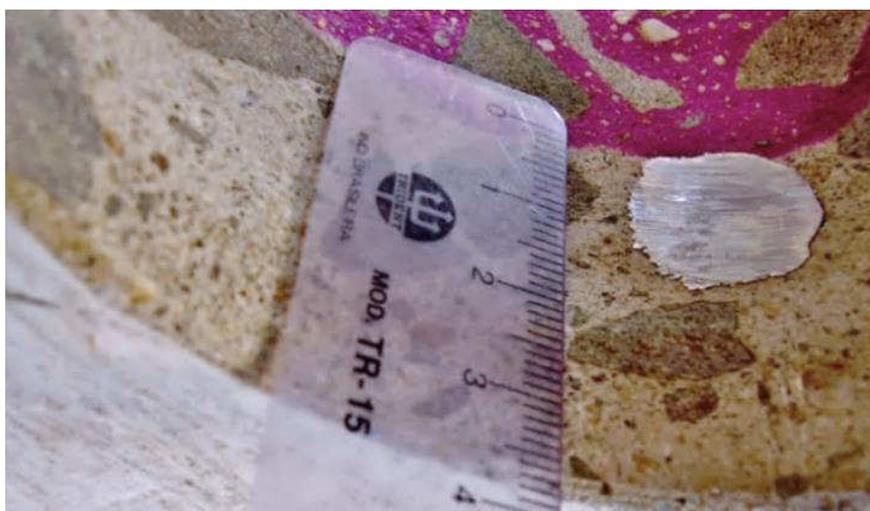
**Figura 4.3 - Frente de carbonatação: indicadores à base de fenolftaleína se tornam incolores na zona carbonatada e tomam uma cor vermelho carmim na região alcalina**
