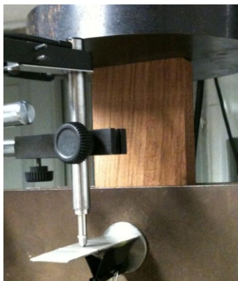
Figura 9: Detalhe do LVDT utilizado para determinação do deslocamento entre o pino metálico e corpo de prova.
