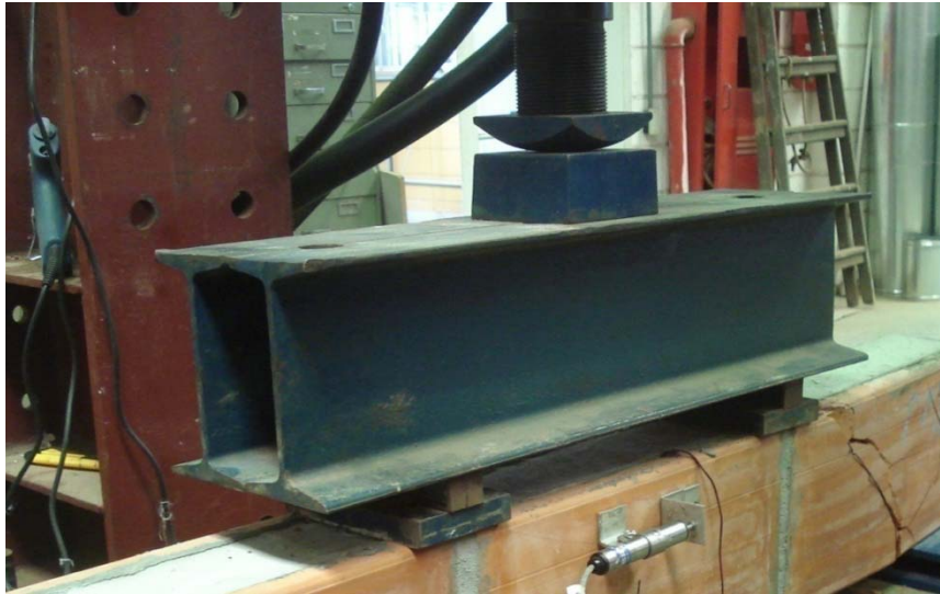
Figura 3.22 - Esquema de carregamento nas vigas.
