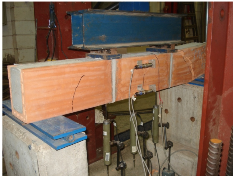
Figura 3.25 - Apoio metálico permitindo somente rotação.
