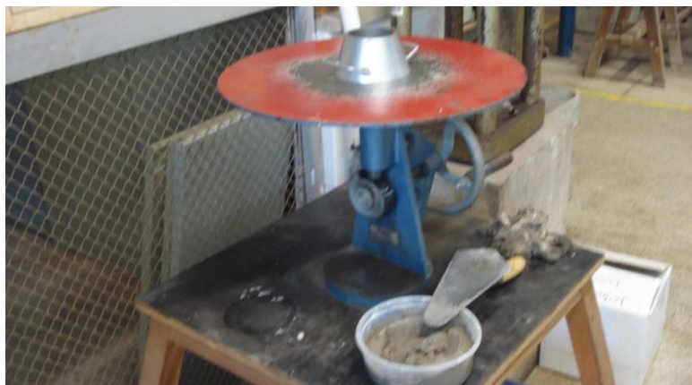
Figura 3.40 - Ensaio do índice de consistência da argamassa de assentamento.
