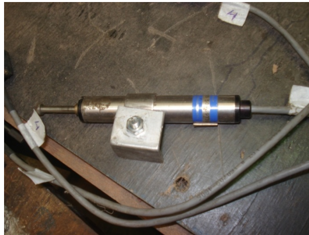
Figura 3.11 - Transdutor para monitorar deslocamentos e fissuração.
