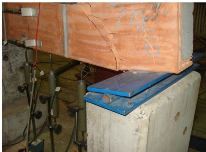
Figura 3.26 - Apoio metálico permitindo rotação e translação.
