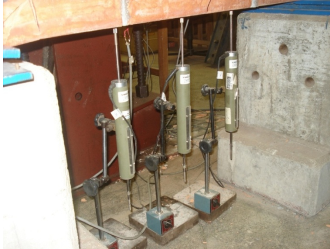
Figura 3.10 - Defletômetros para determinação dos deslocamentos (flechas).
