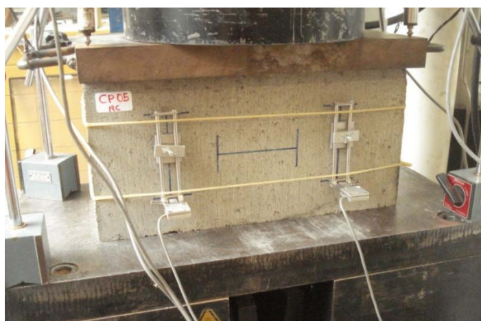
Figura 3.36 - Ensaio de compressão - bloco de concreto.
