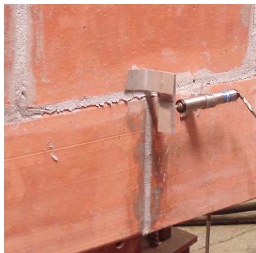
Figura 3.17 – Imagem da fixação dos transdutores 4 e 5.
