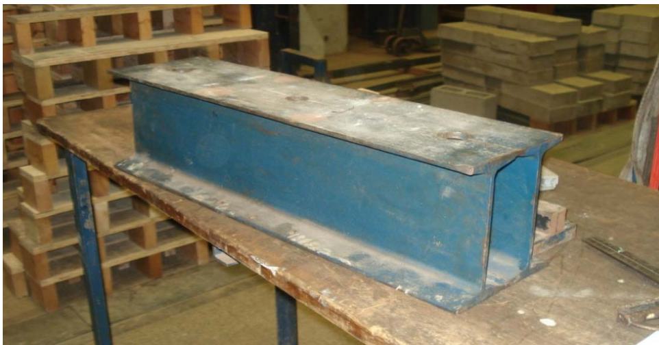
Figura 3.23 - Perfil metálico utilizado na distribuição da carga aplicada.
